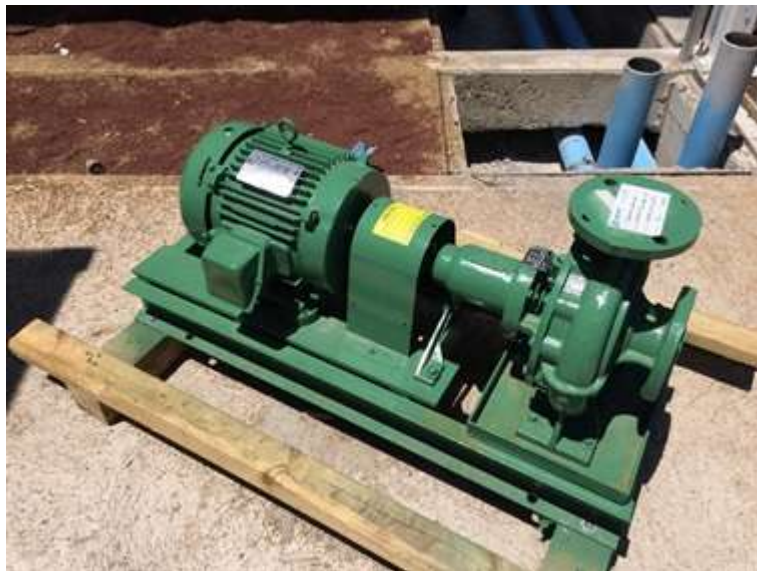
Figura 4.56: Montaje preliminar de la bomba centrífuga de 15 HP (Proyecto Cemie-Geo P16).
