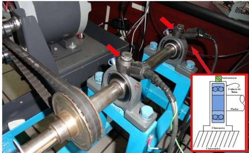
Figura 3.2 Sensores piezoeléctricos ensayo en chumacera y soporte en el laboratorio.
