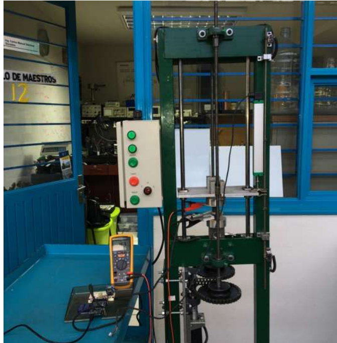
Figura 3.14 Máquina universal de ensayos tensión compresión 500Kg. Medición de carga, deformación transversal y longitudinal, así como la medición de resistencia eléctrica.
