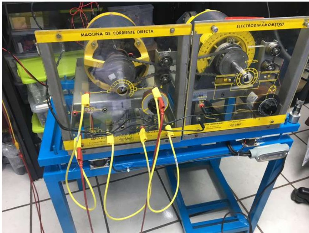
Figura 3.6 Soporte de un conjunto de máquinas con sensor flexible y aislador de vibraciones.
