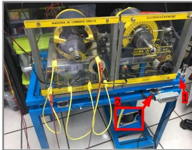
Figura 4.7 Calibración del soporte aislador piezoresistivo, aplicado al conjunto de máquinas rotativas en el laboratorio. 2) muestra el sensor del soporte aislador. 1) muestra el acelerómetro de calibración.
