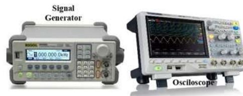
Figura 3.20 Equipos usados en espectroscopia de impedancia mediante la técnica de medición de impedancia indirecta a diferentes frecuencia 0-1MHz.
