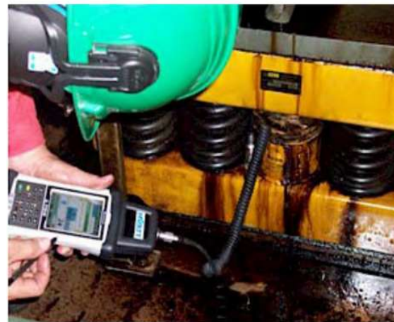
Figura 2.20 Distribución de los soportes o calzos antivibratorios de un motor de combustión interna V48.
