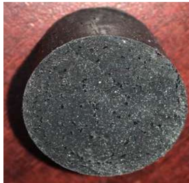
Figura 4.2 Corte central de la probeta muestra la porosidad de una probeta C75.
