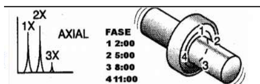
Figura 2.15I Desalineación de rodamiento inclinado sobre el eje.
