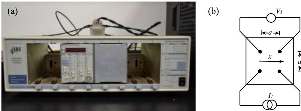
**Figura 3.3.** (a) Imagen del equipo para la determinación de la resistencia eléctrica usando CPCA y (b) esquema de la zapata.
