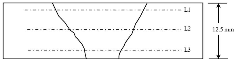
**Figura 3.7.** Dibujo esquemático de las mediciones de microdureza Vickers.
