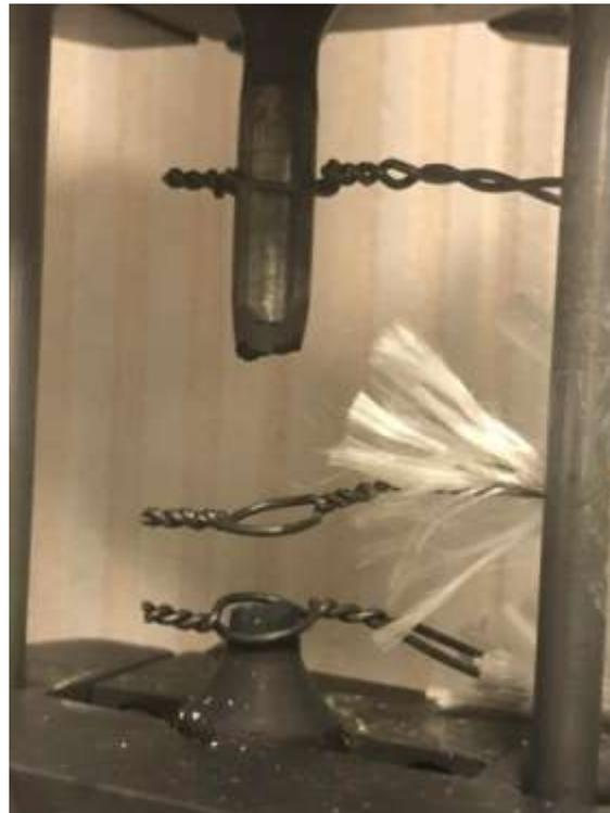
**Figura 4.33.** Falla del espécimen sometido a termofluencia.
