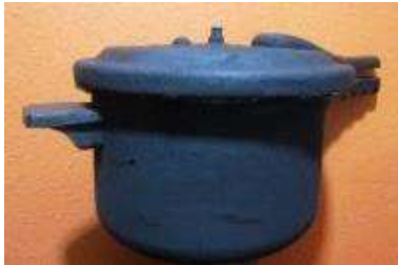
Figura 4.31. Aplicación del recubrimiento de hollín en una olla de presión.
