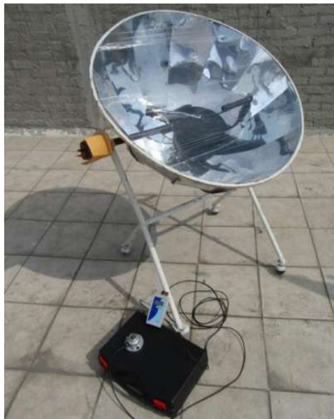
Figura 3.21. Cocina Solar Rural.
