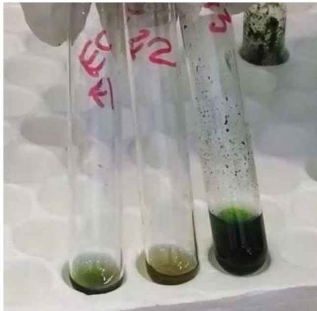
Figura 6. Extracción de lípidos por método Folch. F1= Metanol-Agua, F2= Proteínas-Metanol y F3= Cloroformo-Lípidos.
