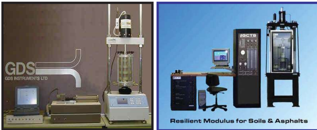
Figura. 1.7. Actuales equipos triaxiales cíclicos (GDS, GCTS, 2004)
