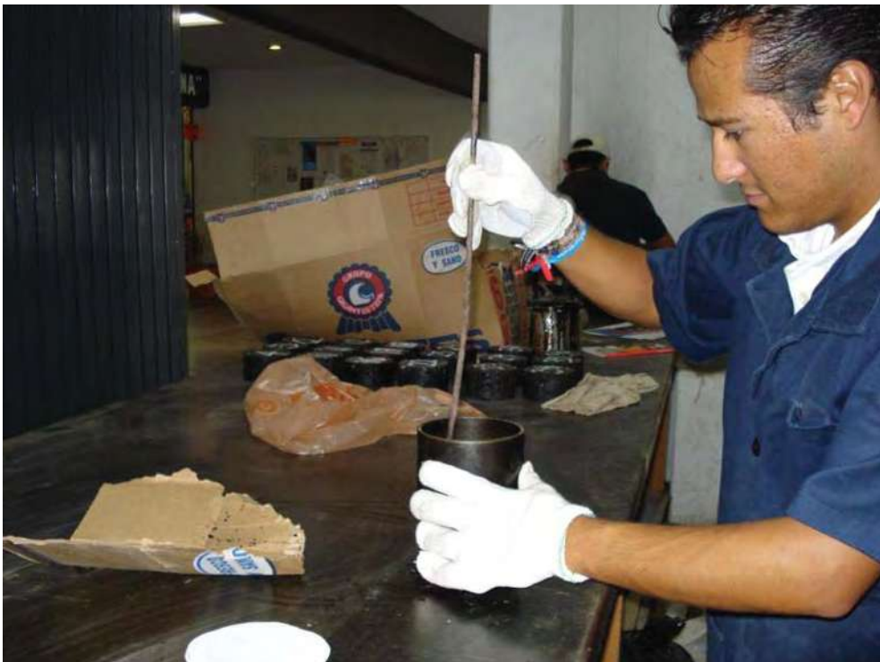
Colocación de la Mezcla en los Moldes
