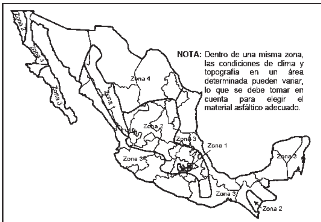
Figura 3.3. Regiones Geográficas para la utilización de asfaltos clasificados según su Viscosidad Dinámica a 60°C. Fuente: Norma N-CMT-4-05-001/5 de la SCT.
