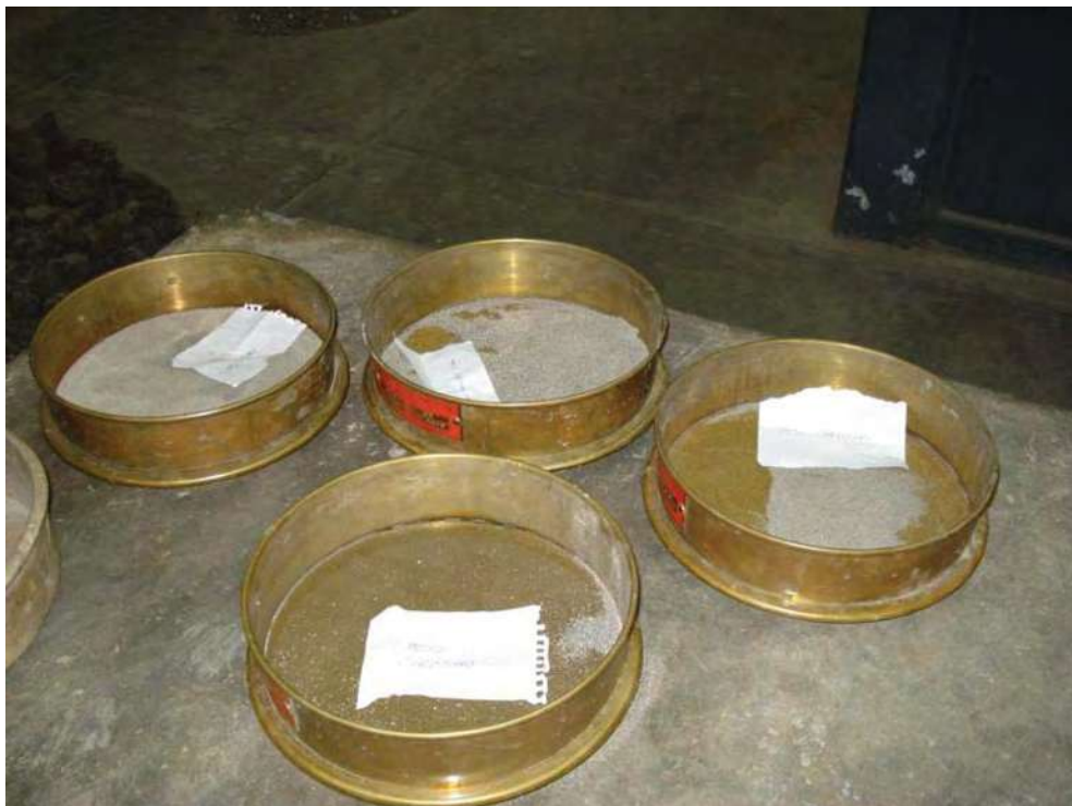
Cribado del Material de Banco, para la caracterización.
