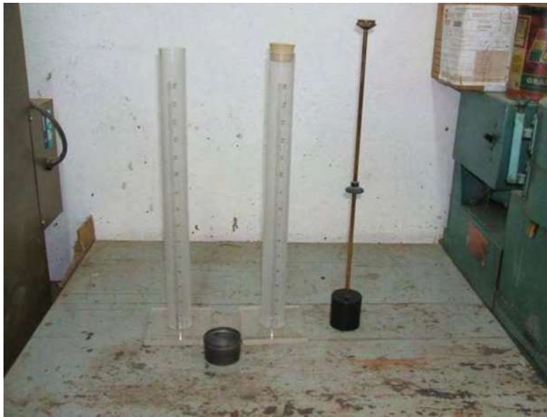
Figura 7.3. Probetas para el ensayo de Equivalente de Arena.
