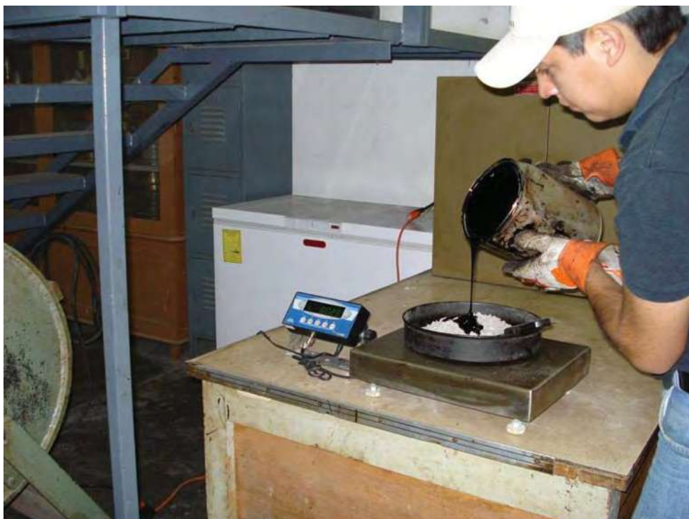
Adición del contenido de asfalto para la elaboración de las pastillas
