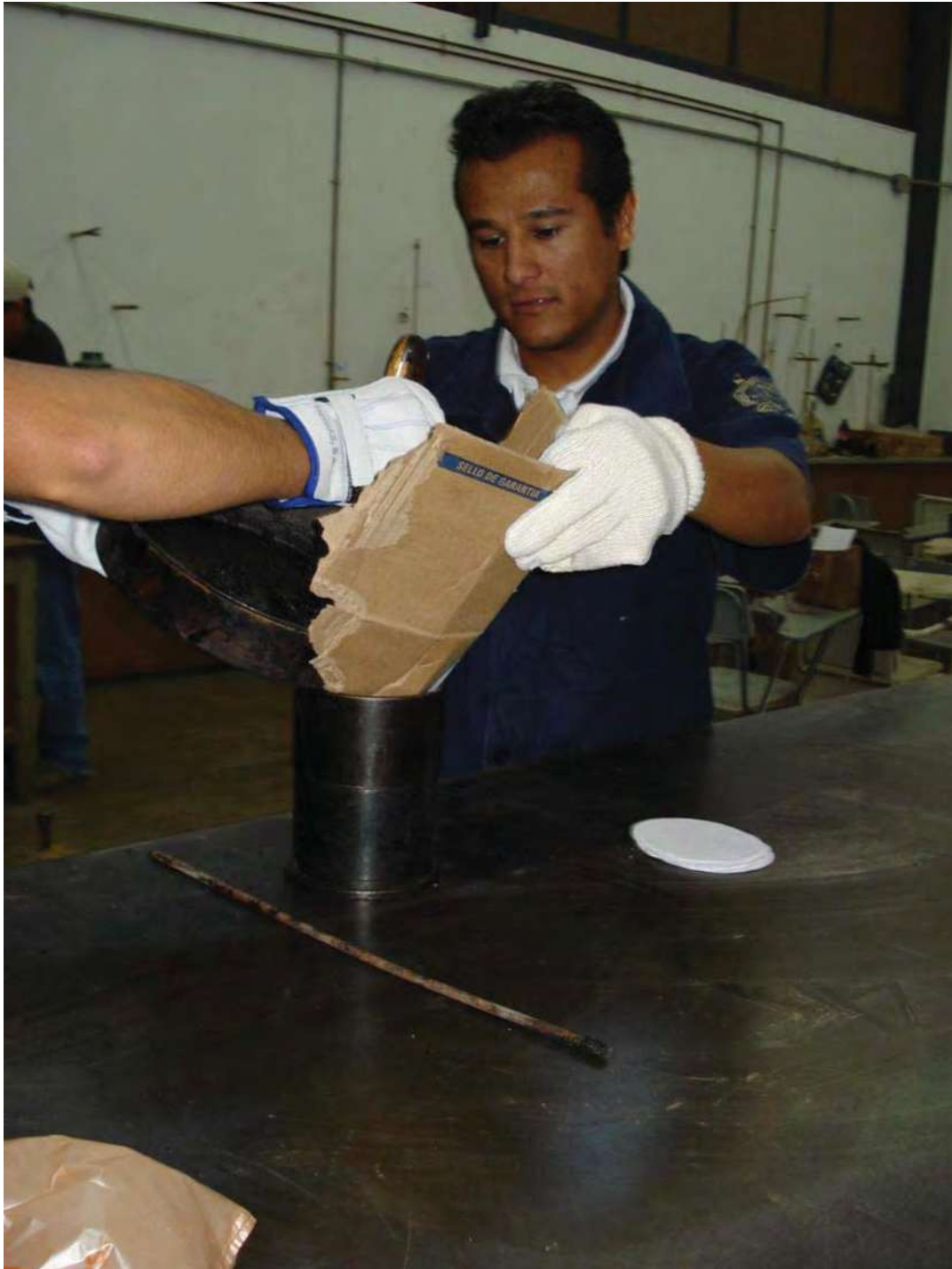
Vaciado de las mezcla en los moldes para su compactación
