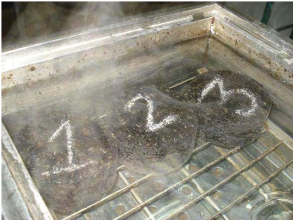
Inmersión de las Probetas para la prueba Marshall
