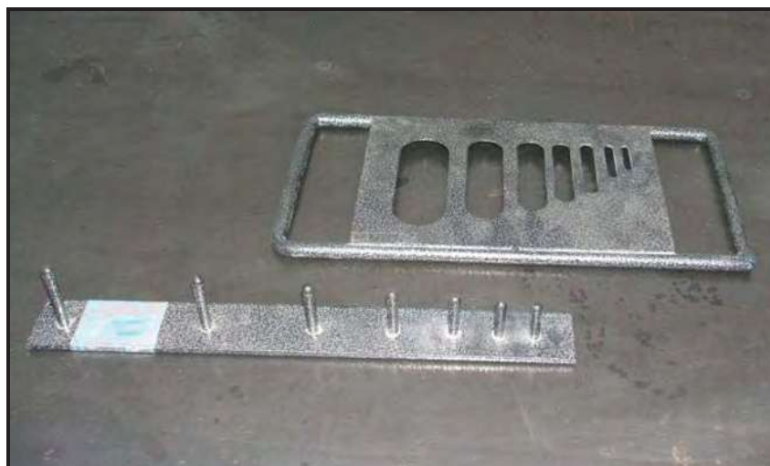
Figura 7.4. Calibradores de espesor y longitud para la prueba.
