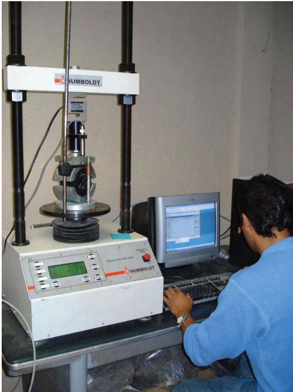
Ensayo de las probetas en la prensa Marshall
