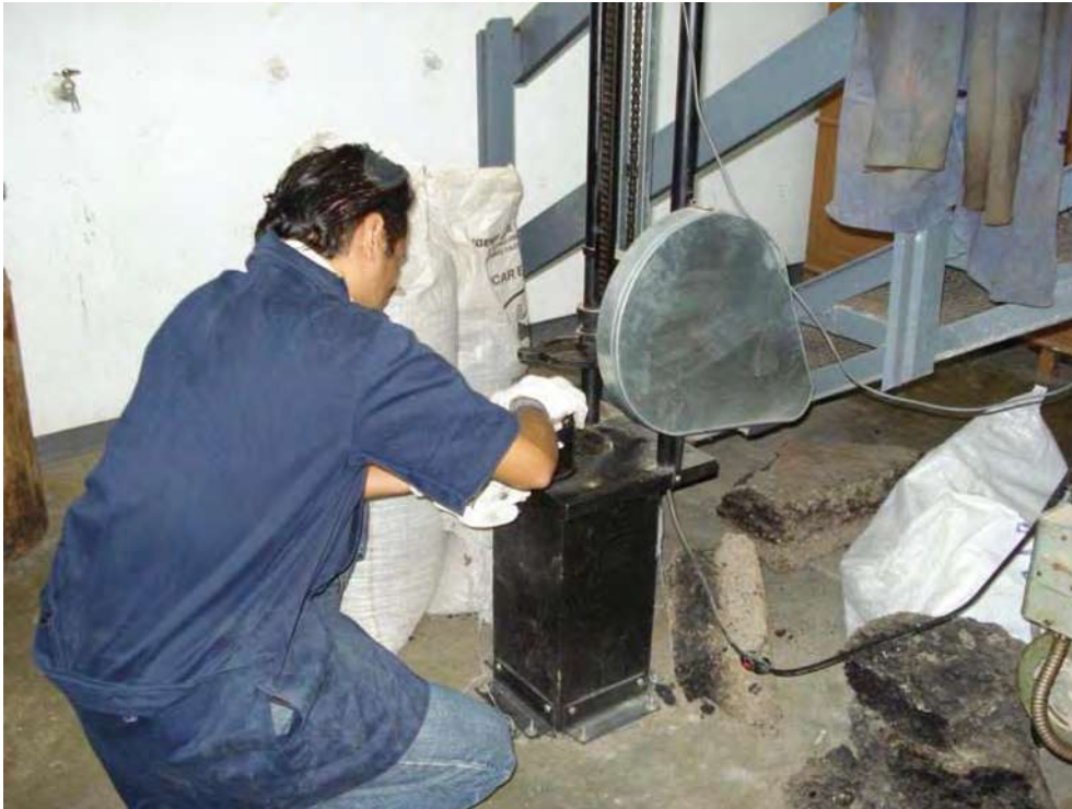
Compactación de la Mezcla en el Compactador Marshall
