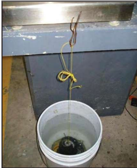
Figura 7.8. Obtención del Peso sumergido de las probetas ( P_{sum} ).
