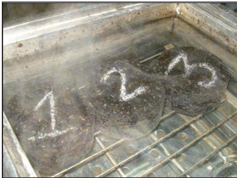
Figura 7.9. Probetas sumergidas en agua a 60 °C, para la obtención del flujo y estabilidad.
