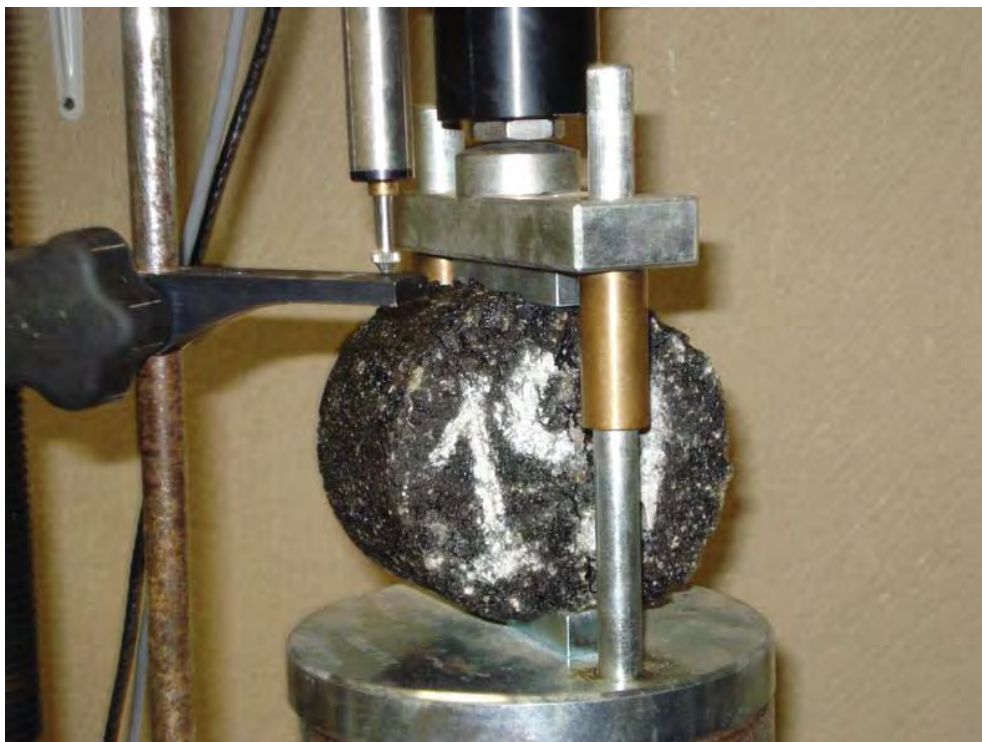
Prueba de Tracción Indirecta para la obtención de la carga para la prueba de Módulo Resiliente
