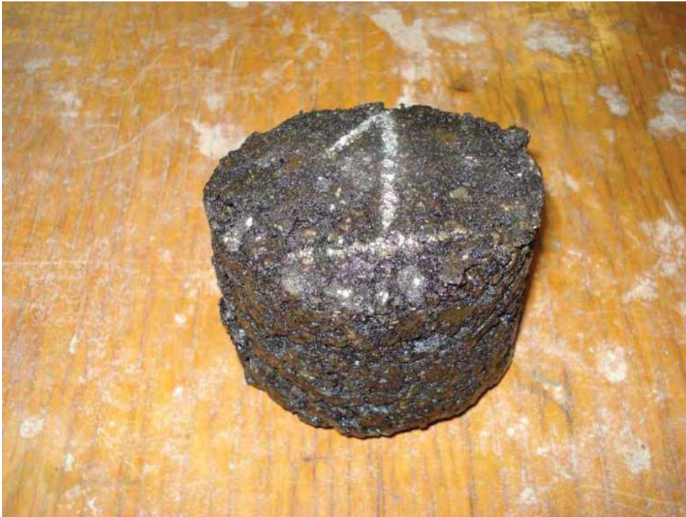
Pastilla fallada después de la prueba Marshall
