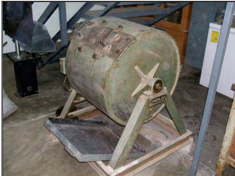
Figura 7.5. Cilindro giratorio empleado para la prueba de desgaste de Los Ángeles.
