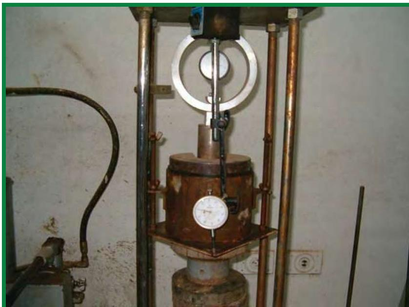
*Foto 5.5.8 Muestra de suelo sometida a penetración.*
