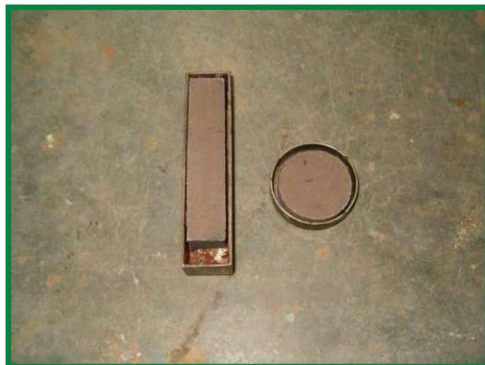
**Foto 5.5.6 Moldes rellenos de material tamizado por la malla # 40, después de ser sometidos al horno para conocer la contracción lineal y volumétrica.**
