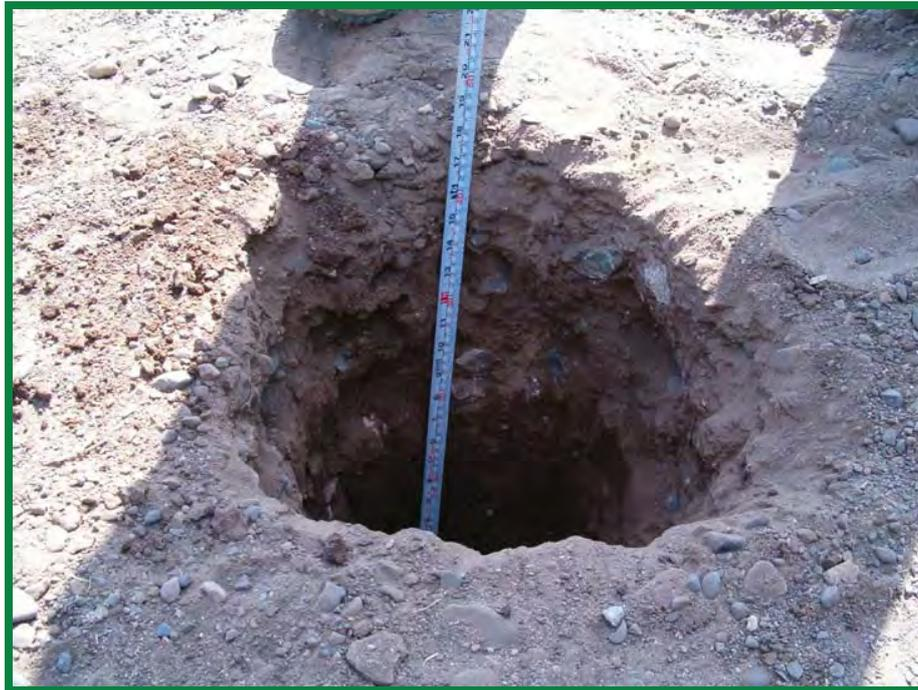
**Foto 5.5.2** Sondeo realizado en la zona con mayor espesor de revestimiento del camino.
