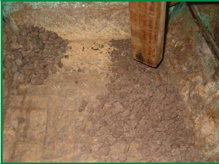
*Foto 5.5.4 Debido a la naturaleza del material se procede a separar el material retenido en la malla de 3/8" con el uso de un mazo.*
