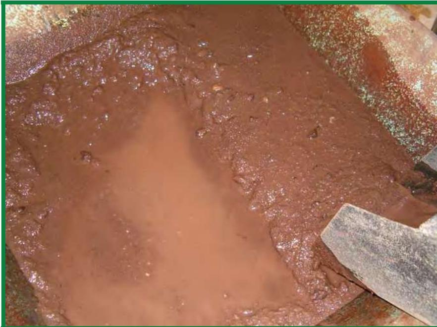
*Foto 5.5.5 Material retenido en la malla # 4, posteriormente separado por lavado.*
