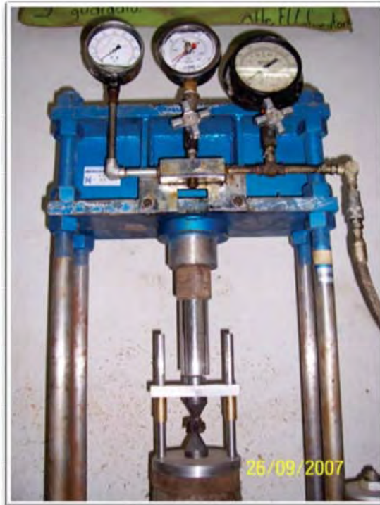
Figura III.VI. 2.-Aparato de carga puntual en la prensa universal
