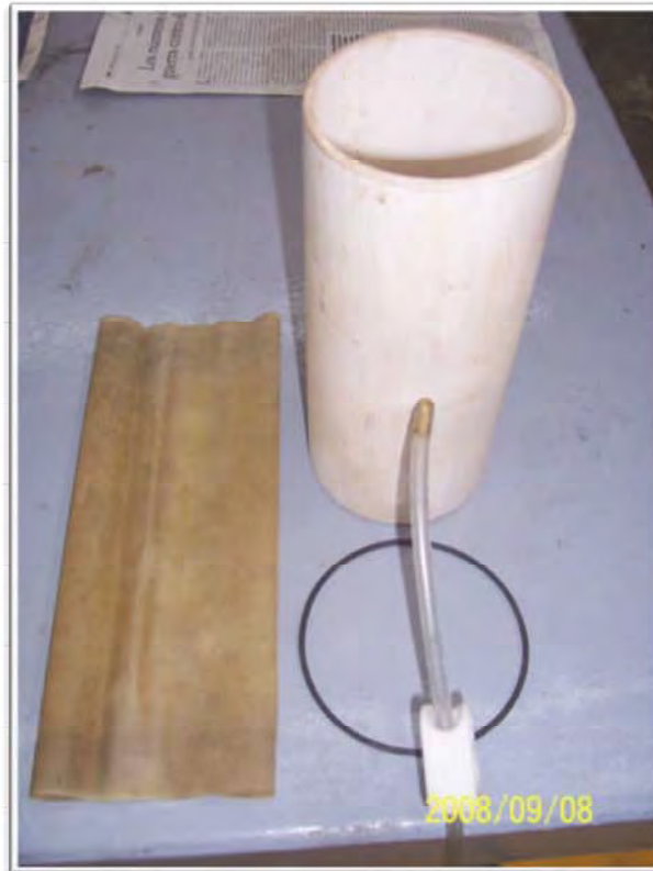
Figura III.VII. 2.-Tubo con manguera para colocar la membrana
