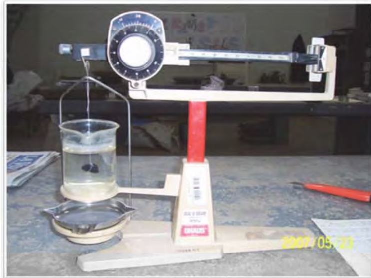
Figura III.V. 1.- Balanza con la partícula sumergida en el agua
