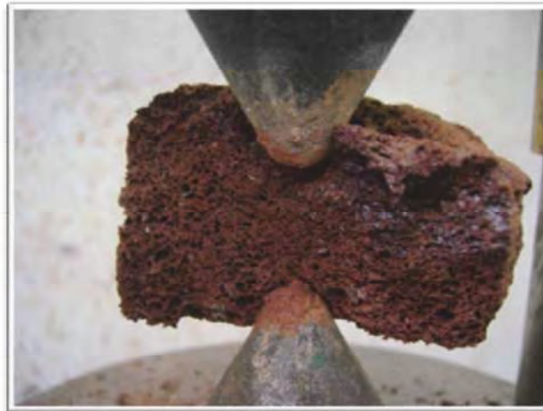
Figura IV.II. 3 Penetración de las puntas cónicas en las partículas del Material 2
