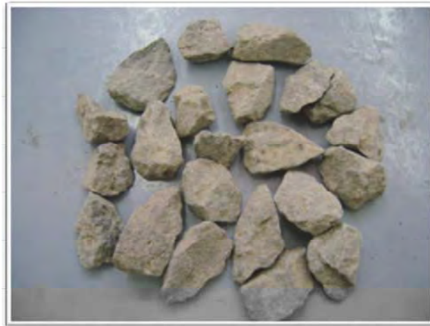
Figura IV.IV. 1 Material producto de trituración de roca
