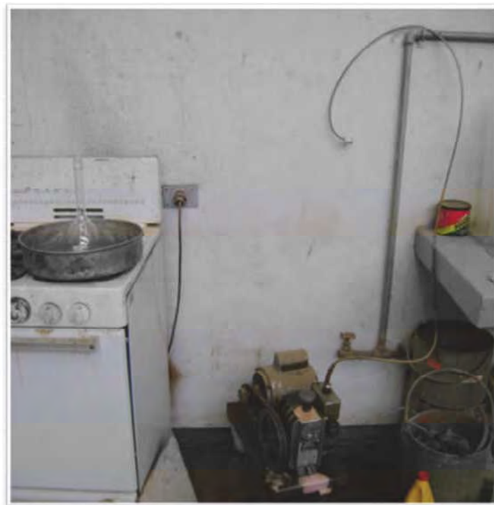
Figura III.IV. 2.- Matraz con material en baño maría y bomba de vacío a la derecha
