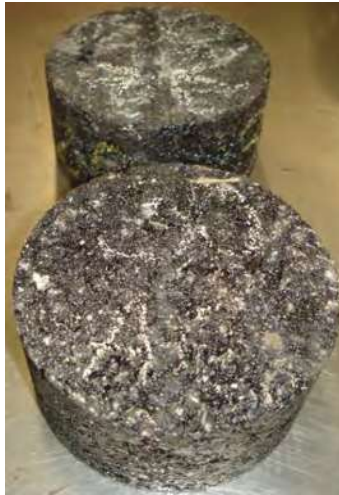
FIGURA 5.5.64 ENSAYO 3, PROBETAS 30 Y 36. DE 4". ELABORADAS CON EL 8% DE AC-20 DE SALAMANCA. ENSAYADAS EN EL APA
