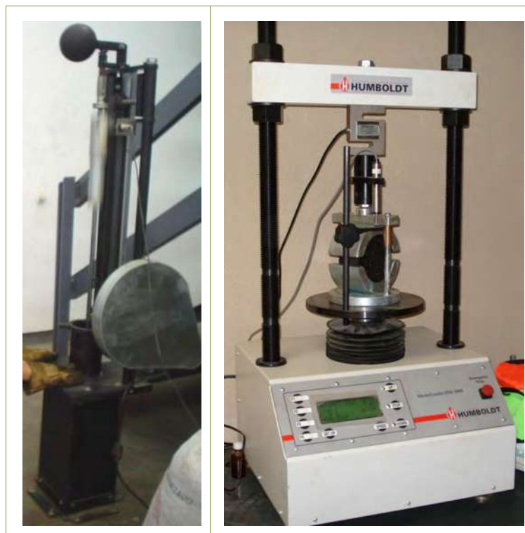
FIGURA 2.5.1 PEDESTAL DE COMPACTACIÓN Y MÁQUINA DE ENSAYO MARSHALL
