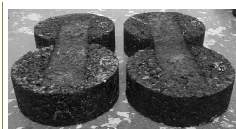
FIGURA 5.5.23 ENSAYOS 17 Y 18 EN EL PROTOTIPO “PISTA DE ENSAYO DE LABORATORIO UMICH”
