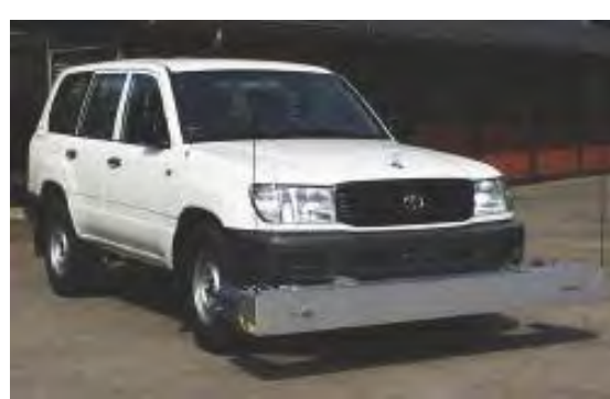
FIGURA 3.4.2 PERFILÓMETRO DYNATESTS MARK II FUENTE-<WWW.DYNATEST.COM>
