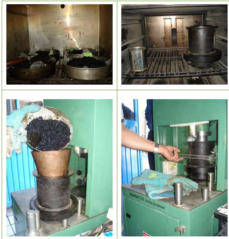
FIGURA 5.4.5 PROCESO DE COMPACTACIÓN DE LAS MEZCLAS ASFÁLTICAS
