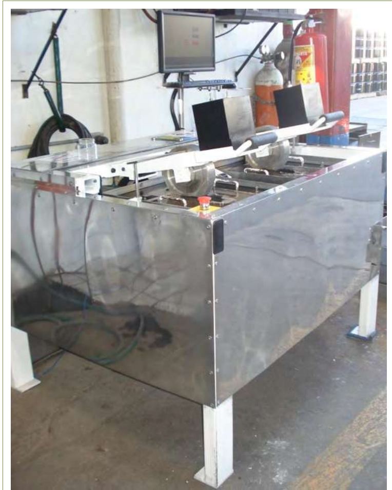
FIGURA 3.4.3 RUEDA CARGADA DE HAMBURGO “HWTD”, DE LA EMPRESA SURFAX
