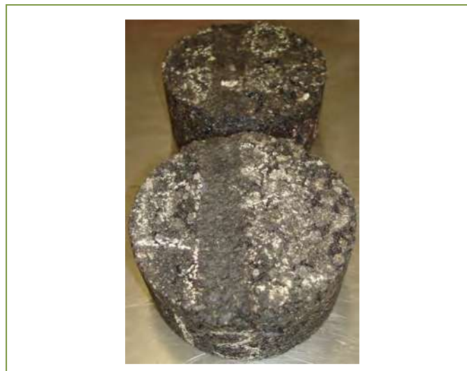
FIGURA 5.5.70 ENSAYO 4, PROBETAS 13 Y 20. DE 4". ELABORADAS CON EL 7% DE ASFALTO MODIFICADO. ENSAYADAS EN EL APA
