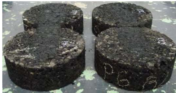
FIGURA 5.5.27 ENSAYOS 19 Y 20 EN EL PROTOTIPO "PISTA DE ENSAYO DE LABORATORIO UMICH"
