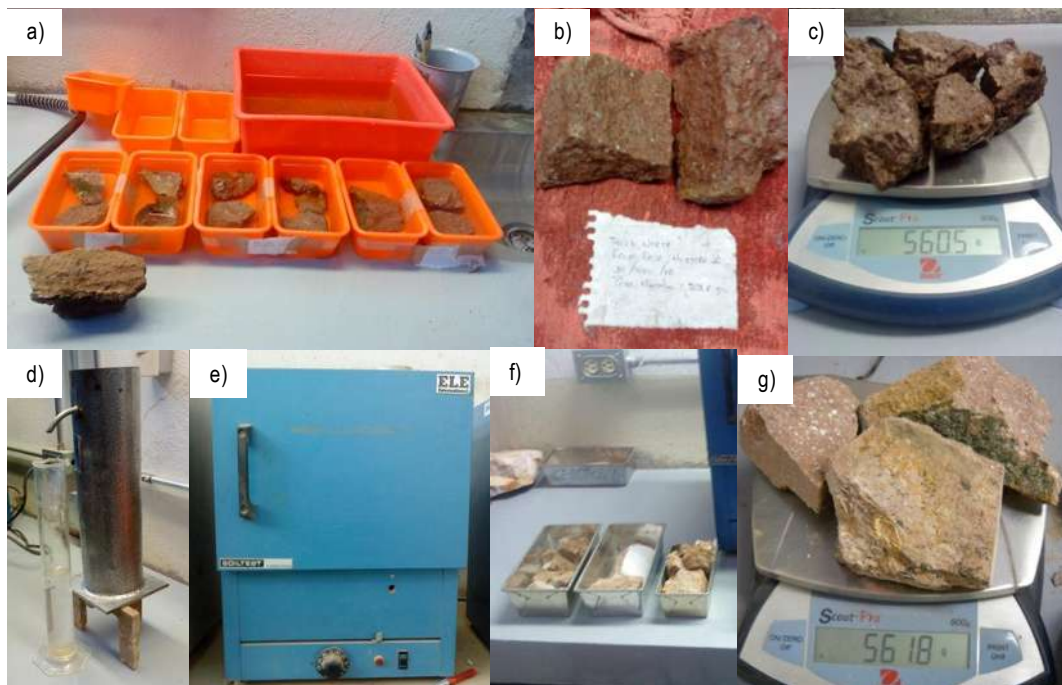
Figura No. 32.- Procedimiento y equipo para las pruebas de densidad y absorción.
