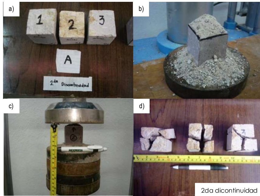
Figura No. 64.- Cubos de 5x5x5 cm antes y después de la prueba, segunda discontinuidad, de la zona de La Paloma.
