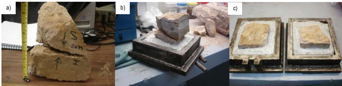
Figura No. 73.- Discontinuidad no. 1. antes de ser ensayada.
