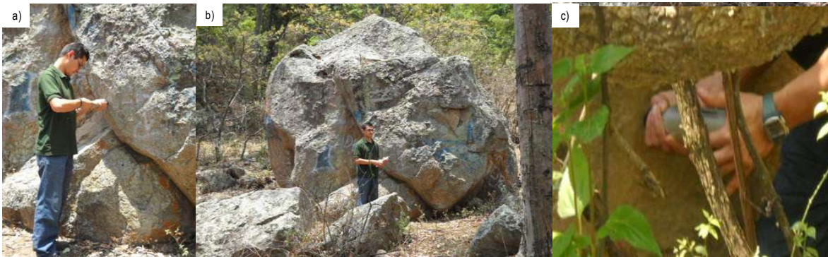
Figura No. 35.- Lecturas con esclerómetro sobre el macizo rocoso.
