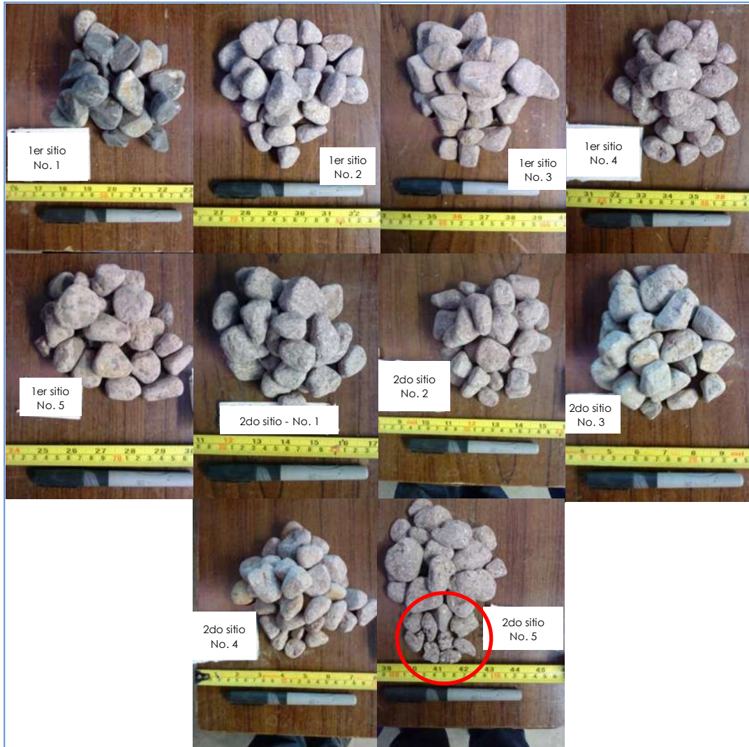
Figura No. 48.- Material de la zona de Tres Marías después de dos ciclos de ensayo de durabilidad.
