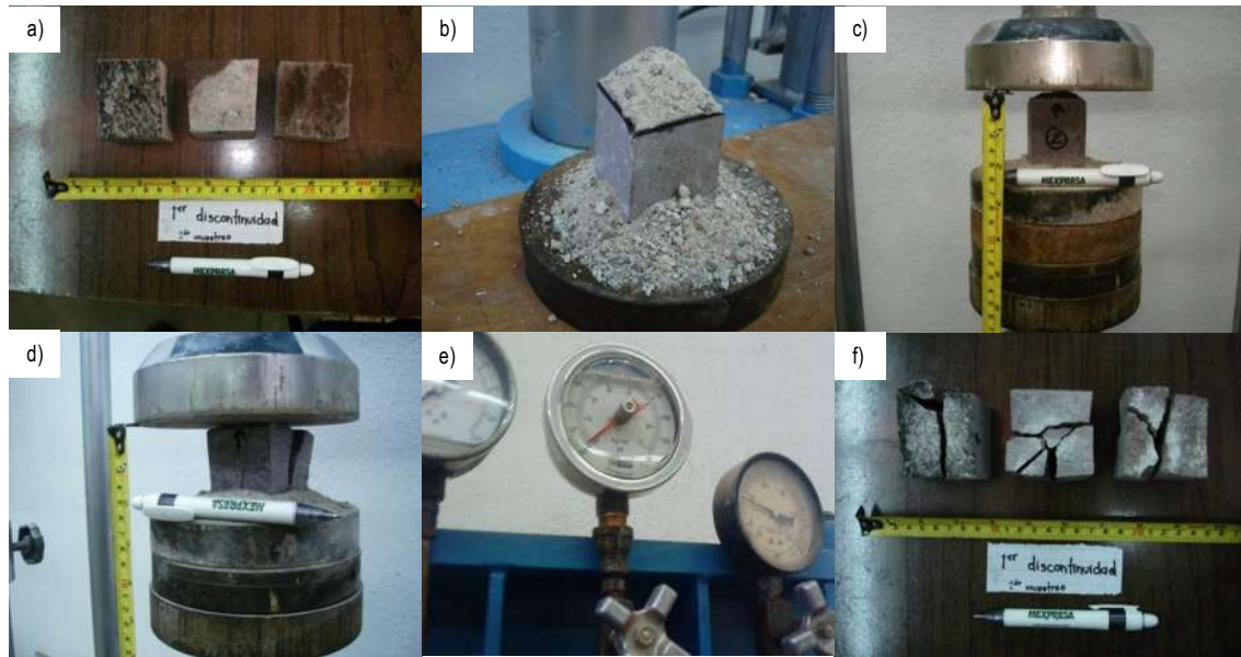
Figura No. 37.- Procedimiento y equipo que se utiliza en la prueba de compresión simple para cubos de roca de 5x5x5 cm.
