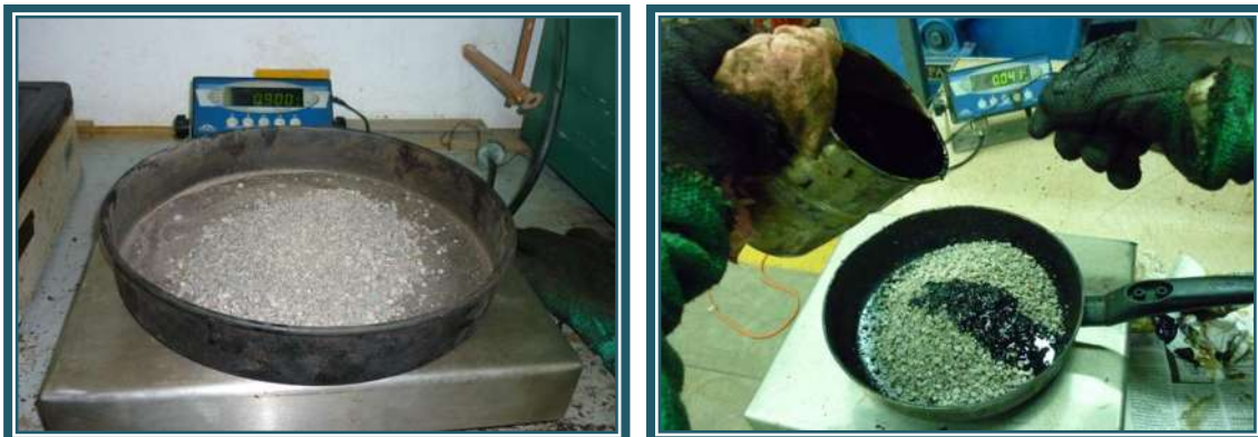
Fig. 4.10. Aplicación del asfalto en el material pétreo.
