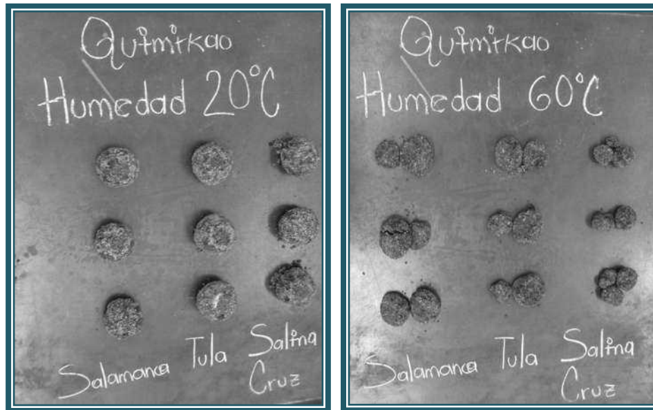
Fig. 5.26. Probetas de asfaltos con aditivo Quimikao después de la prueba de desgaste de los Ángeles con efecto por humedad.
