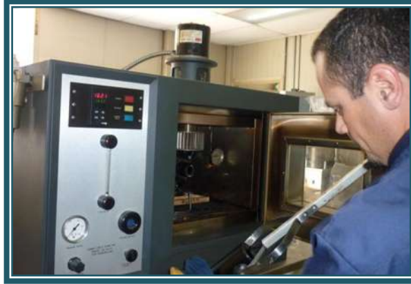
Fig. 3.18. Colocación de las muestras de asfalto en el RTFO.
