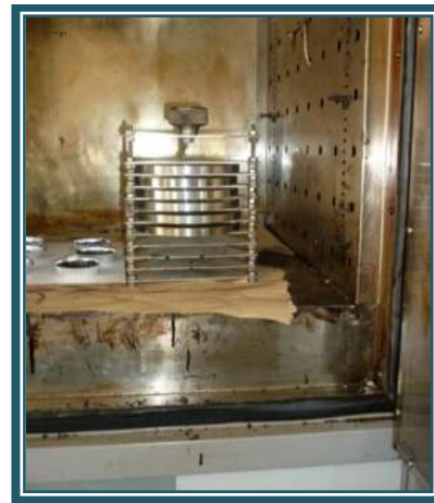
Fig. 3.25. Extracción de las charolas del PAV después de la prueba y colocación dentro del horno para eliminar el aire atrapado en el asfalto.
