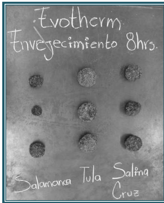
Fig. 5.35. Probetas de asfaltos con aditivo Evotherm después de la prueba de los Ángeles.
