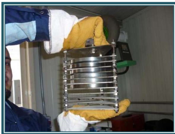
Fig. 3.25. Extracción de las charolas del PAV después de la prueba y colocación dentro del horno para eliminar el aire atrapado en el asfalto.
