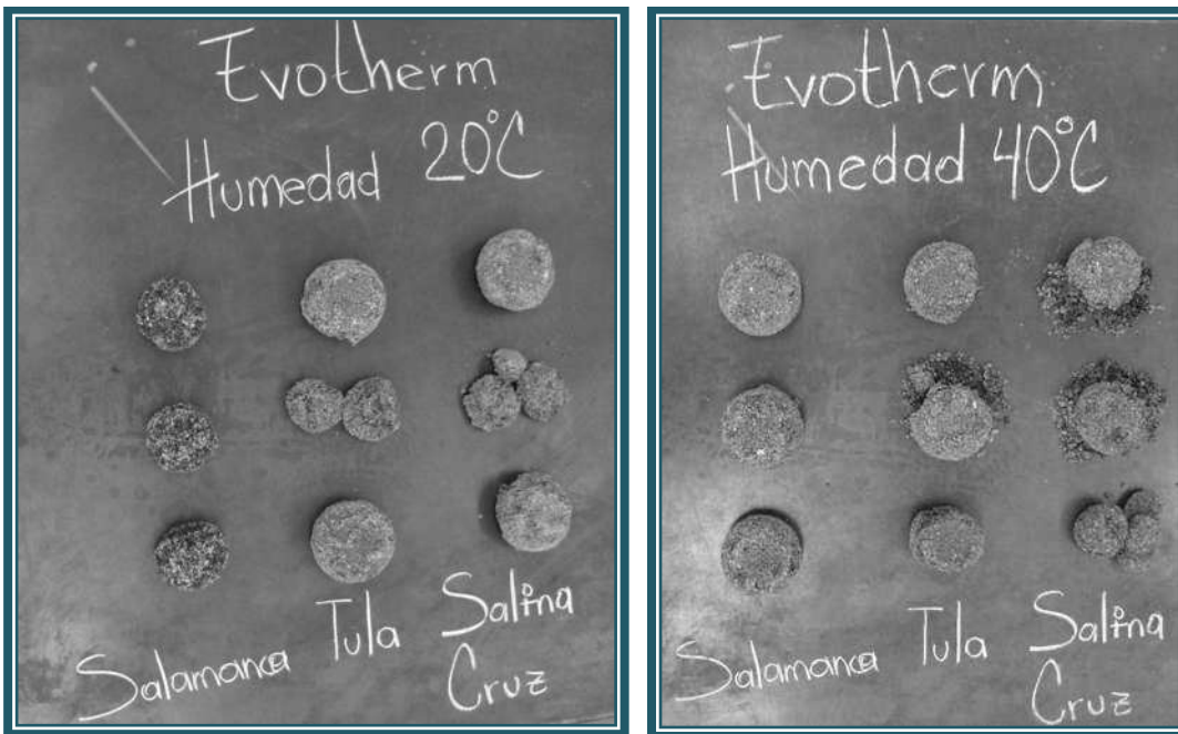
Fig. 5.22. Probetas de asfaltos con aditivo Evotherm después de la prueba de los Ángeles con efecto por humedad.
