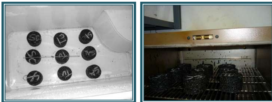
Fig. 4.30. Probetas Marshall dentro del refrigerador y horno eléctrico.
