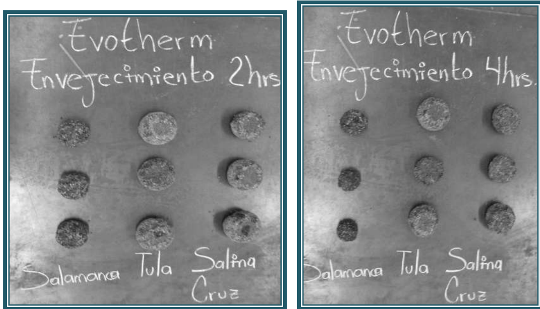
Fig. 5.34. Probetas de asfaltos con aditivo Evotherm después de la prueba de los Ángeles.
