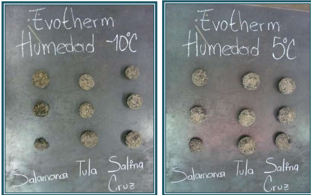
Fig. 5.21. Probetas de asfaltos con aditivo Evotherm después de la prueba de los Ángeles con efecto por humedad.
