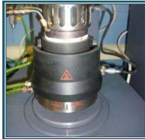
Fig. 3.30. Colocación de tapa en DSR para ensayo.
