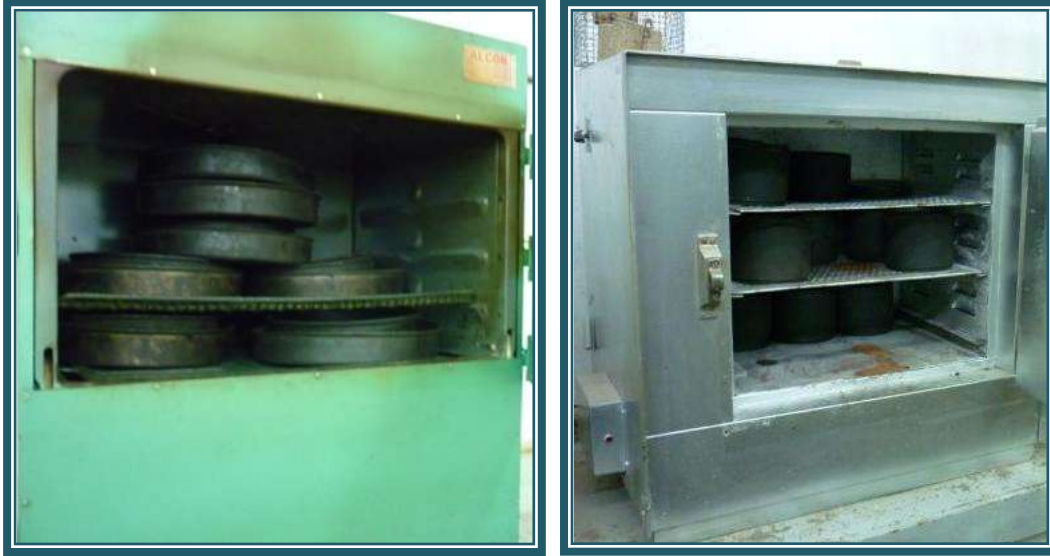
Fig. 4.7. Charolas y moldes dentro del horno eléctrico.
