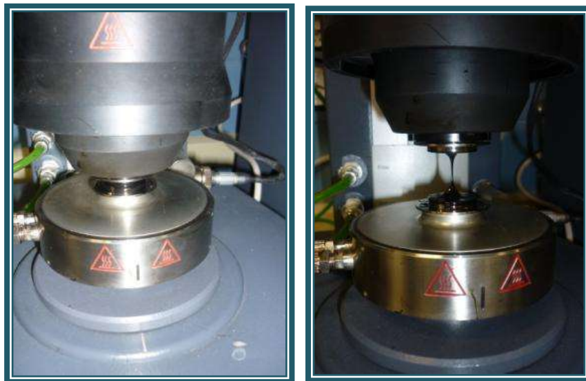
Fig. 3.32. Terminación de prueba en el DSR.
