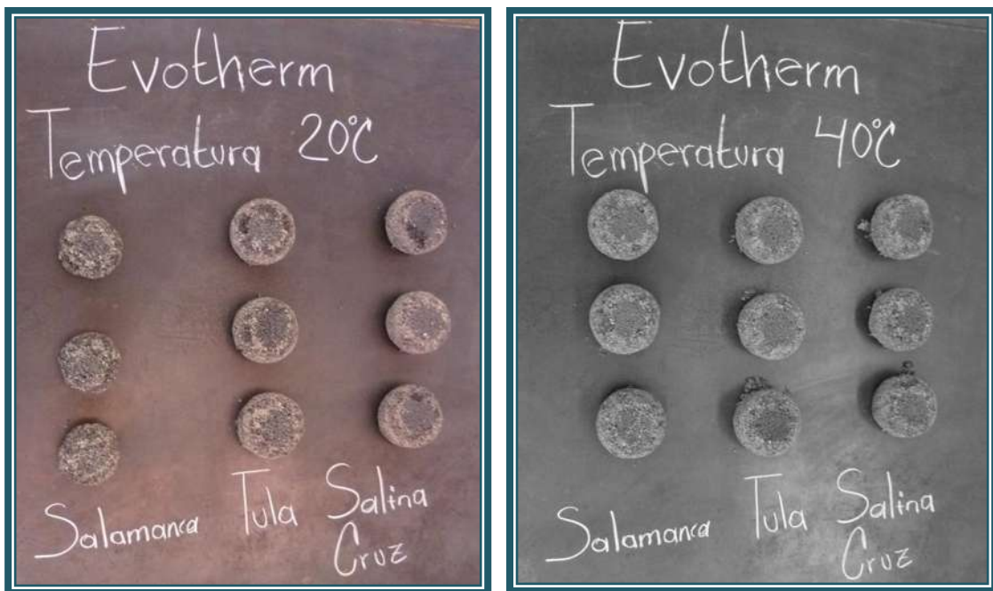
Fig. 5.8. Probetas de asfaltos con aditivo Evotherm después de la prueba de los Ángeles con efecto por temperatura.
