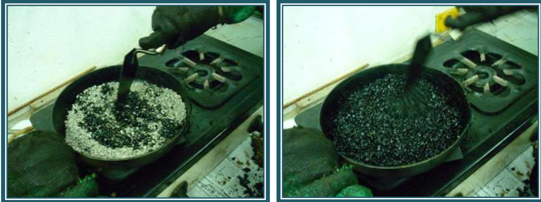
Fig. 4.11. Mezclado de material pétreo con el asfalto.
