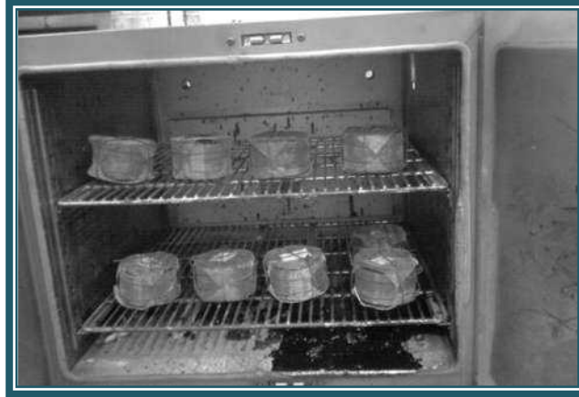
Fig. 4.53. Probetas Marshall confinadas dentro del horno.
