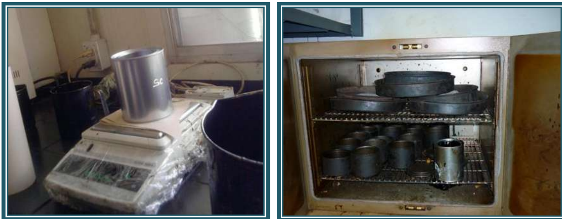
Fig. 4.8. Charolas, moldes y asfalto dentro del horno eléctrico.
