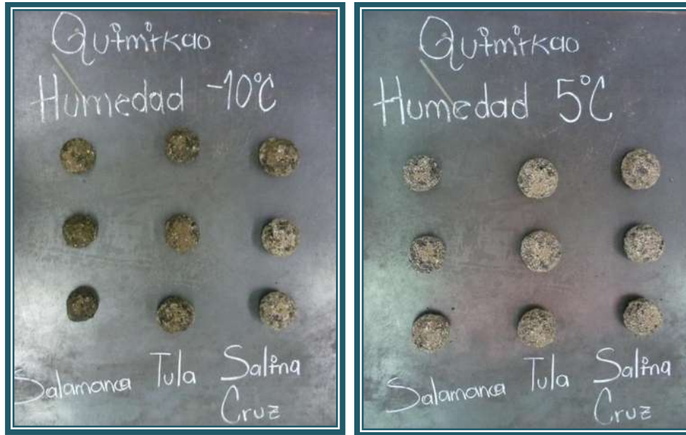
Fig. 5.25. Probetas de asfaltos con aditivo Quimikao después de la prueba de desgaste de los Ángeles con efecto por humedad.
