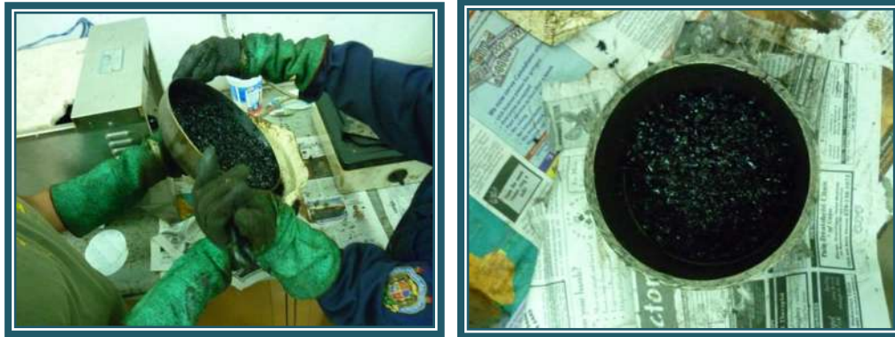
Fig. 4.13. Colocación de la mezcla en el molde Marshall.
