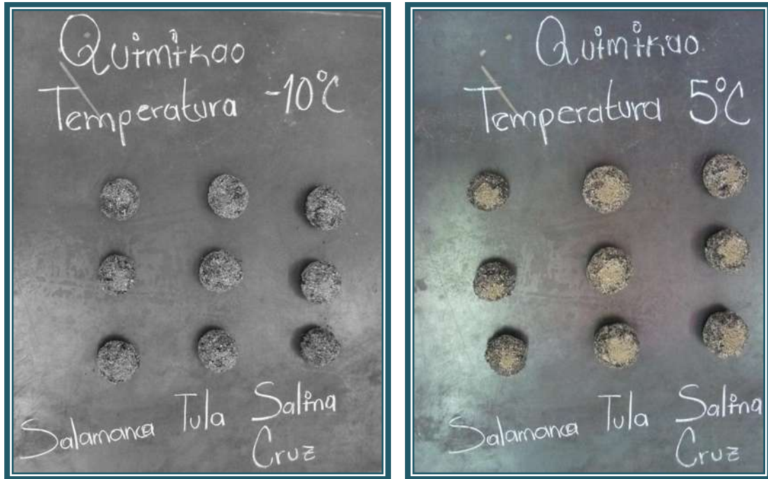
Fig. 5.11. Probetas de asfaltos con aditivo Quimikao después de la prueba de desgaste de los Ángeles con efecto por temperatura.
