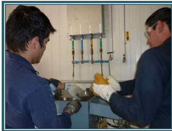
Fig. 3.23. Colocación de la tapa del PAV.
