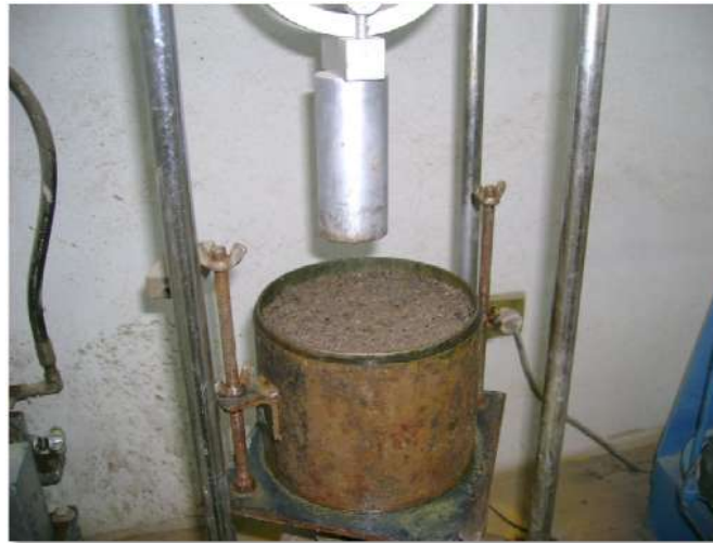
Figura 28.- Prueba del Valor Relativo de Soporte (Coria, 2010)
