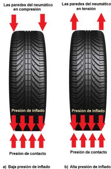
Figura 25.- Relación entre presión de contacto y presión de inflado (Huang 1993, creación propia).
