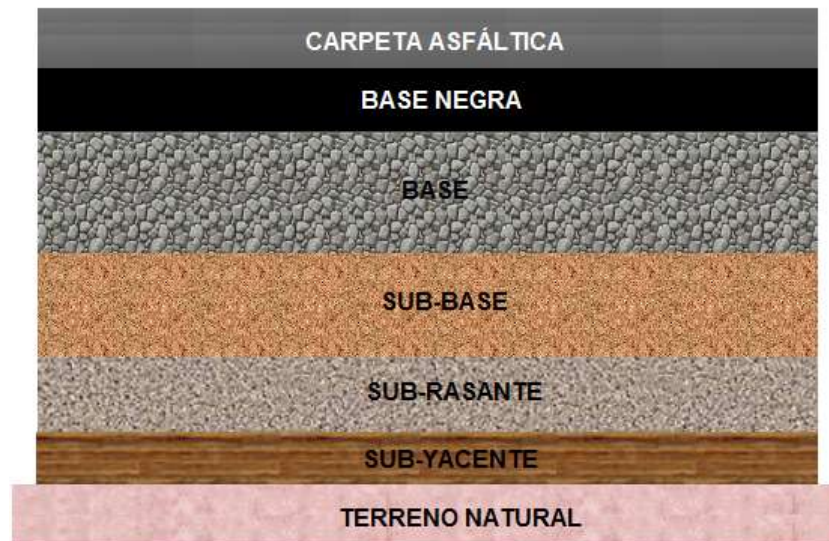
Figura 2.- Sección completa de estructura de pavimento flexible.
