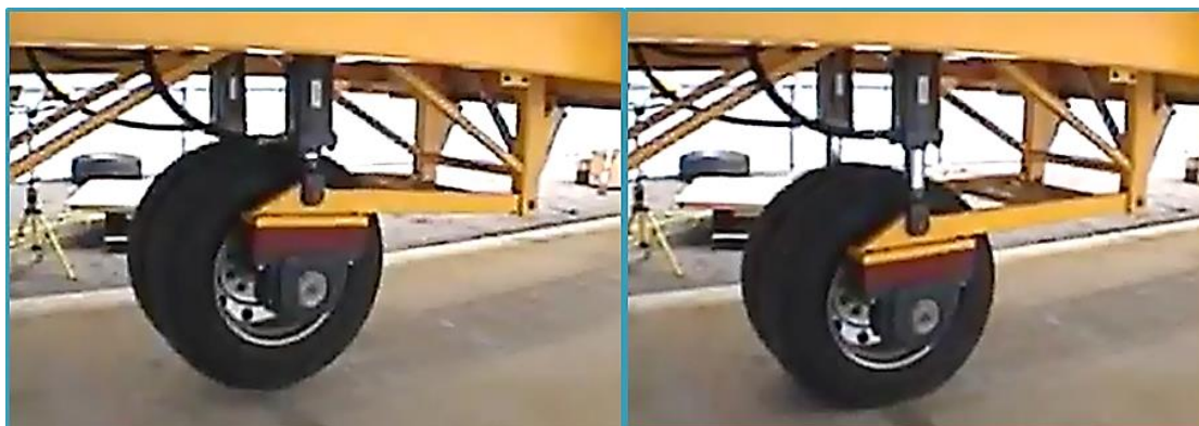
Figura 83 – Actuadores que ejercen presión sobre las llantas.
