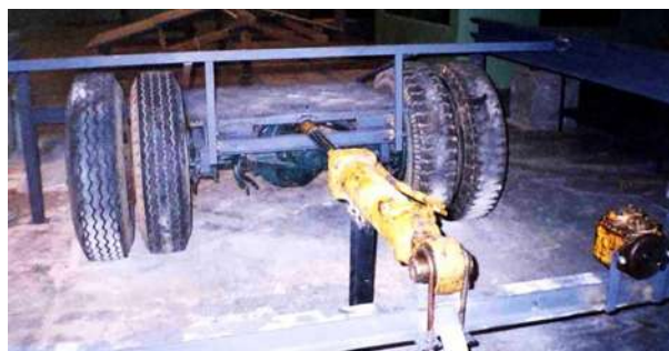
Figura 28 - Estructura de la Pista de Prueba CEFET-SP APT
