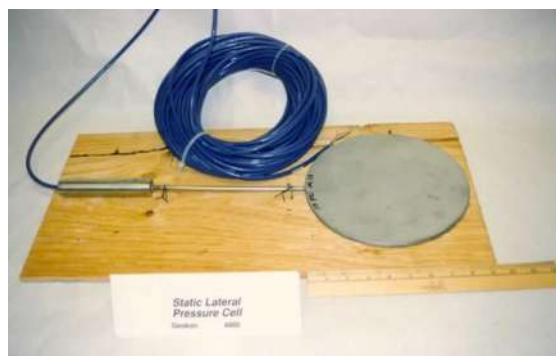
Figura 57 – Sensor de presión estática (MnDOT, 2000-2012).
