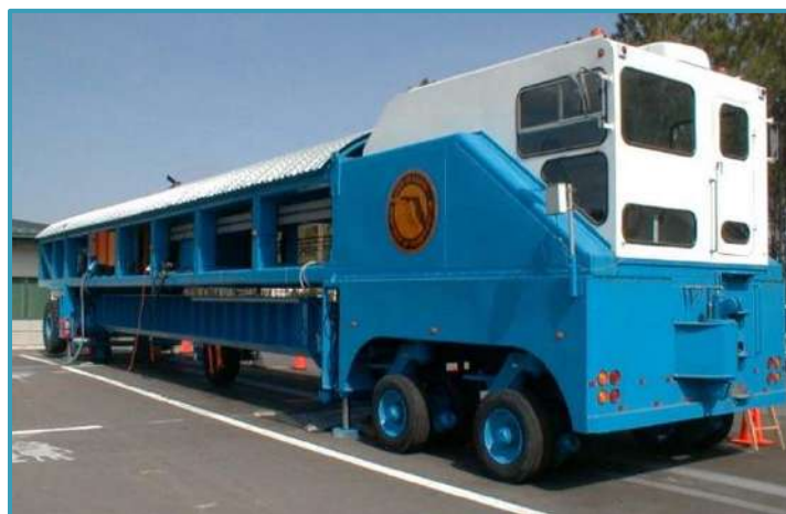
Figura 37 – HVS utilizado en FLORIDA DOT.
