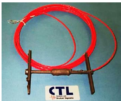
Figura 65 - Dispositivo para medir la deformación de la carpeta asfáltica manufacturado por Construction Technologies Laboratories (CTL) (Timm, Priest, & McEwen, 2004).
