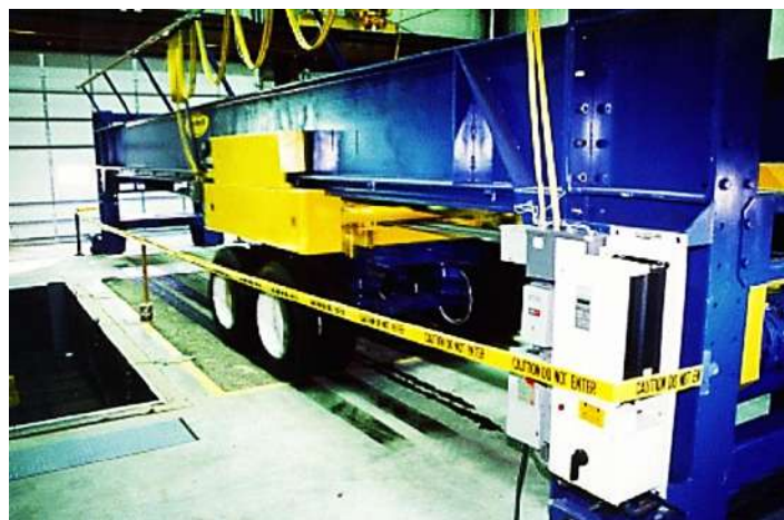
Figura 25 - Estructura de la Pista Lineal de K-ATL (NCHRP, 2004).
