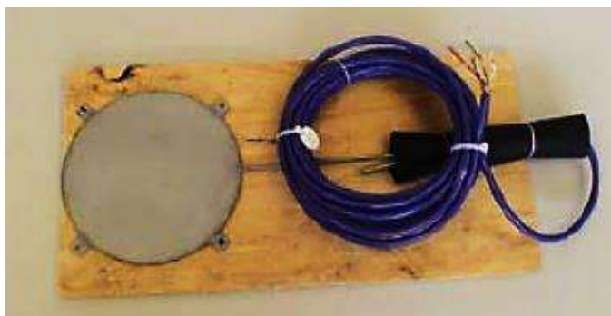
Figura 66 - Earth Cell Pressure marca Geokon (Timm, Priest, & McEwen, 2004).
