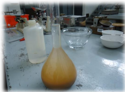
Figura 61 Llenado de agua destilada hasta la marca de aforo
