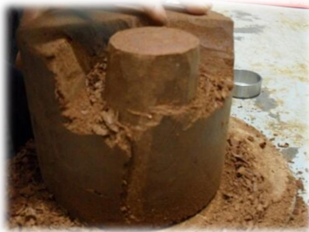
Figura 74 Labrado del espécimen
