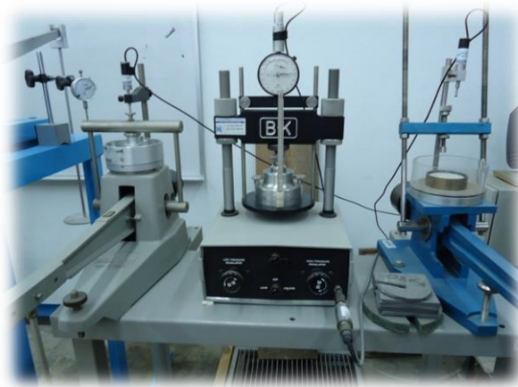
Figura69 Equipos de consolidación
