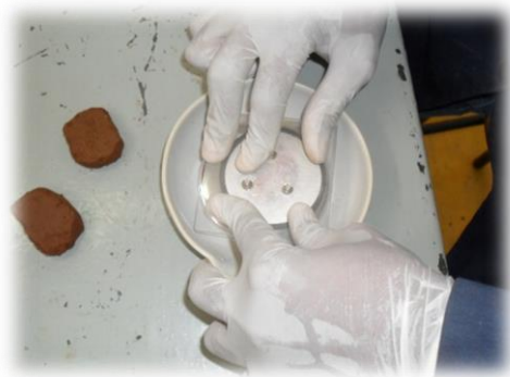
Figura 45 Sumergido en mercurio de las pastillas de suelo.
