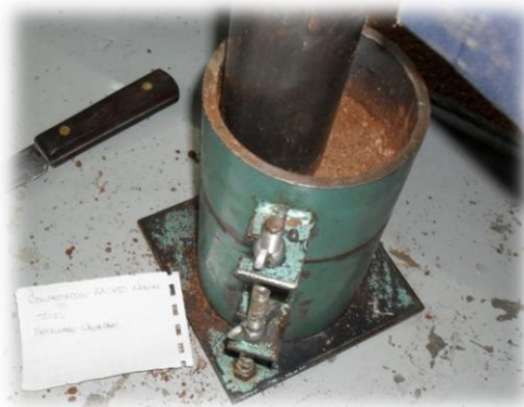
Figura 65 Compactación del espécimen
