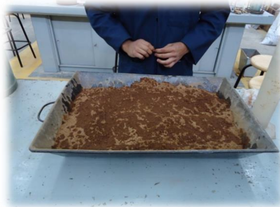
Figura 71 Incorporación de humedad al material
