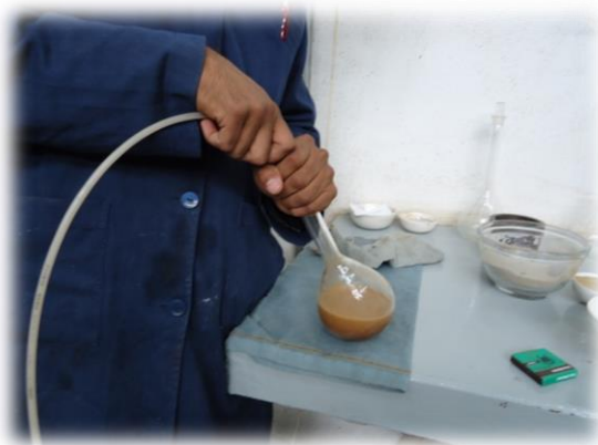
Figura 60 Extracción del aire de la muestra
