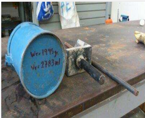
FIGURA 5.2.5.2 Determinación de la M.V.S.V. Se llena el molde en 3 capas, se varilla y se pesa la muestra (Fuente J. A. Guzmán Torres)
