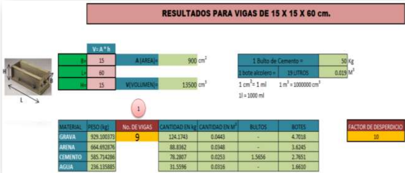
FIGURA 6.1.4.11 Resultados de la cantidad de material para 9 vigas (Fuente J. A. Guzmán Torres)
