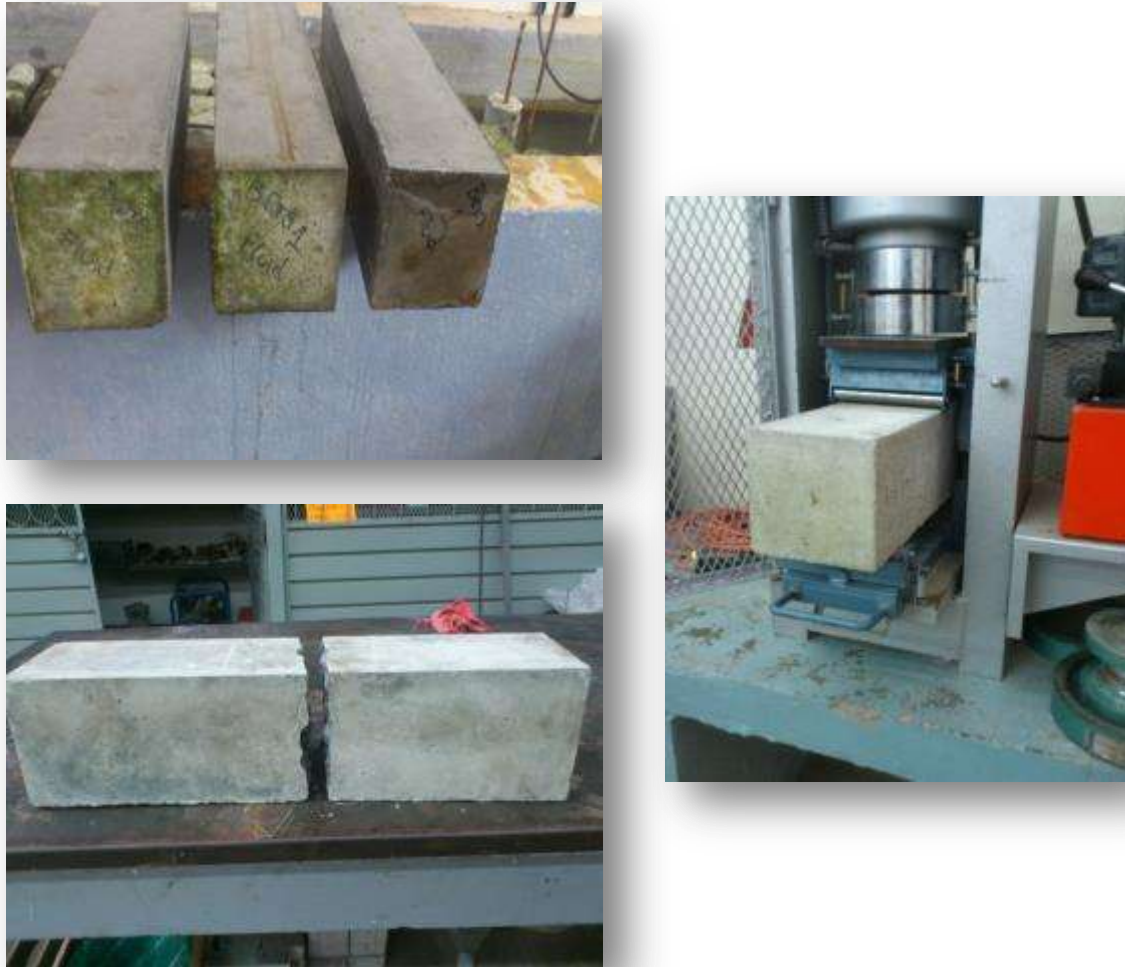
FIGURA 7.2.3.1 Prueba de Flexión en vigas de concreto hidráulico (Fuente J. A. Guzmán Torres)
