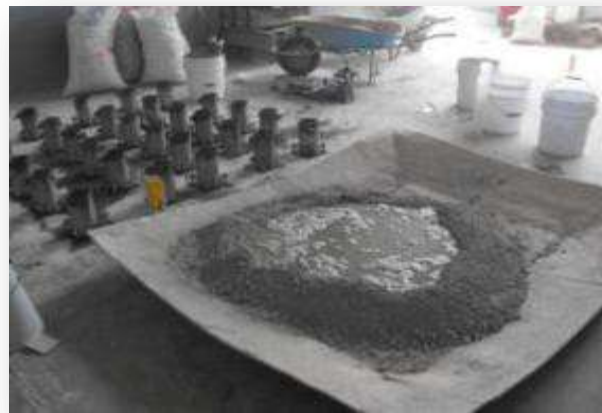
FIGURA 6.1.6.1.2 Elaboración de la mezcla, la cantidad de material se calculó en el proporcionamiento (Fuente J. A. Guzmán Torres)
