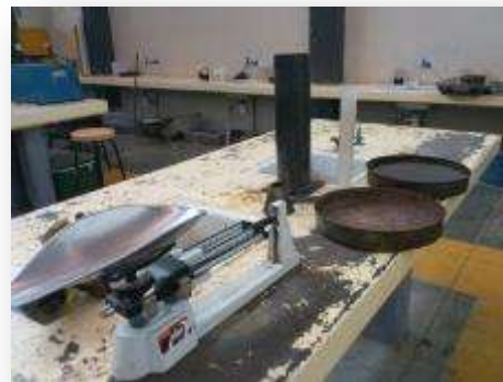
FIGURA 5.2.15.1 Determinación de la Densidad en grava (Fuente J. A. Guzmán Torres)
