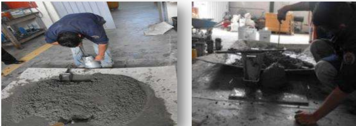
FIGURA 6.1.6.1.5 Prueba de revenimiento, para verificar la fluidez elaborada a cada una de las mezclas (Fuente J. A. Guzmán Torres)
