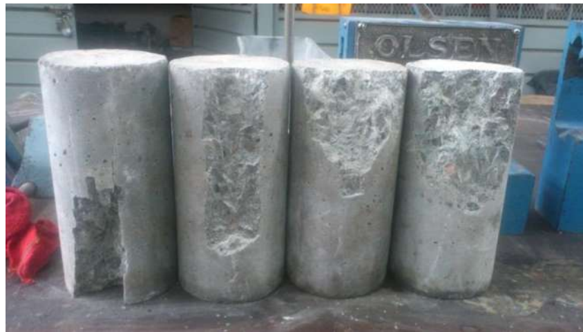
FIGURA 10.3.1 Fallas por mal cabeceo (Fuente J. A. Guzmán Torres)
