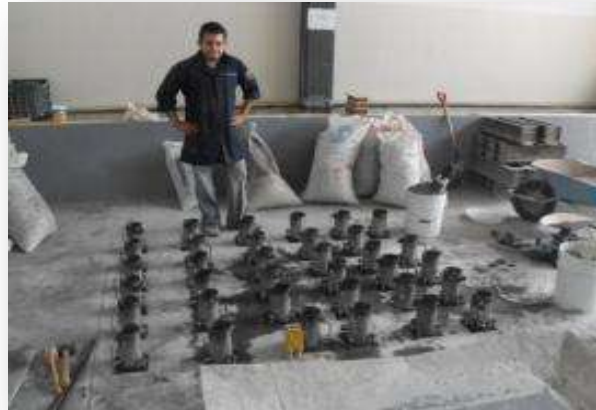
FIGURA 6.1.6.1.1 Preparación de los moldes y herramientas (Fuente J. A. Guzmán Torres)
