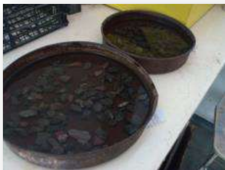
FIGURA 5.2.14.1 Determinación de la Humedad de absorción en grava (Fuente J. A. Guzmán Torres)
