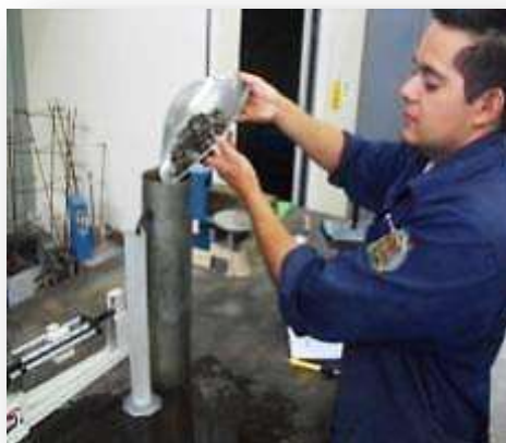
FIGURA 5.2.15.2 Uso del picnómetro para la determinación de la Densidad (Fuente J. A. Guzmán Torres)
