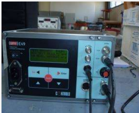
FIGURA 7.1.2.2 Prueba de Velocidad de Pulso Ultrasónico (Fuente J. A. Guzmán Torres)
