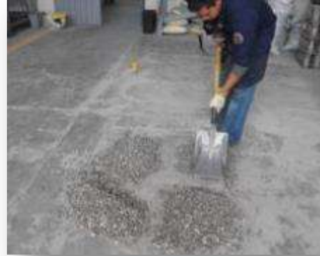
FIGURA 5.2.12.1 Cuarteo del material para obtener una muestra lo más homogénea posible (Fuente J. A. Guzmán Torres)
