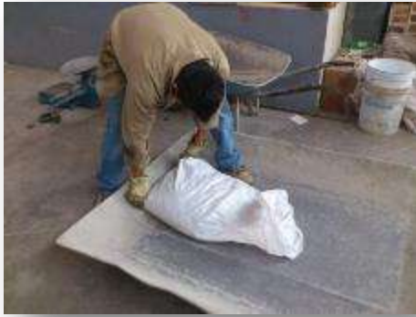
FIGURA 5.2.12.1 Cuarteo del material para obtener una muestra lo más homogénea posible (Fuente J. A. Guzmán Torres)
