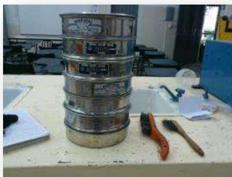
FIGURA 5.2.7.1 Análisis granulométrico se colocan las mallas en tamaño decreciente y se hace pasar el material (Fuente J. A. Guzmán Torres)
