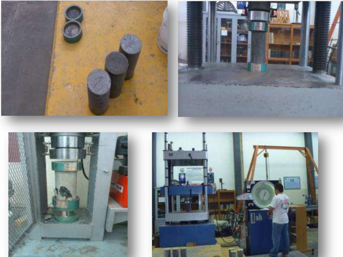
FIGURA 7.2.1.1 Prueba a compresión en cilindros de concreto (Fuente J. A. Guzmán Torres)
