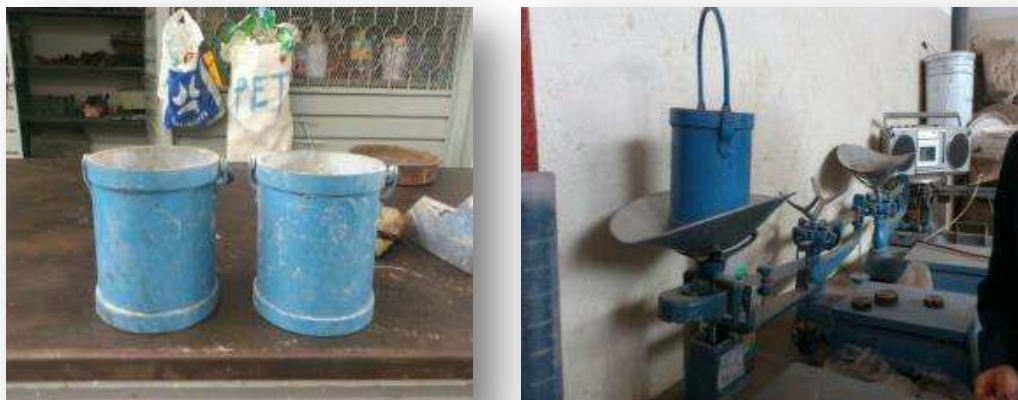
FIGURA 5.2.5.1 Determinación de la M.V.S.S se llena el molde y se pesa la muestra (Fuente J. A. Guzmán Torres)
