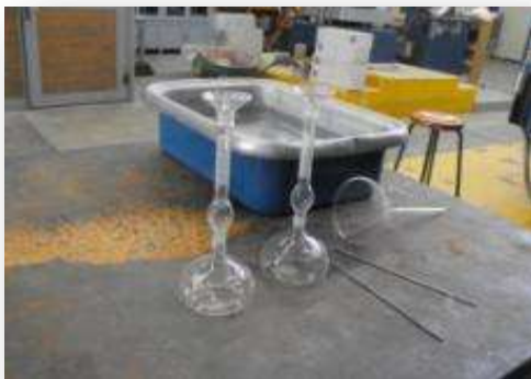
FIGURA 5.3.4.1 Determinación de la Densidad del cemento (Fuente J. A. Guzmán Torres)
