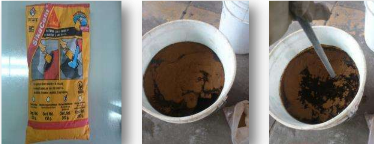
FIGURA 6.1.6.1.3 Adición del SikaCem fluidificante en la mezcla, el fluidificante fue incorporado directamente al agua para mejorar los resultados de reducción de agua en la mezcla (Fuente J. A. Guzmán Torres)
