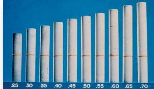
FIGURA 4.1.3 Diez cilindros de pasta de cemento con relaciones agua-cemento de 0.25 a 0.70. La faja indica que cada cilindro contiene la misma cantidad de cemento. El aumento del agua, diluye el efecto de la pasta de cemento, aumentando el volumen, reduciendo la masa volumétrica y disminuyendo la resistencia. [9]
