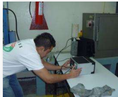
FIGURA 7.1.2.2 Prueba de Velocidad de Pulso Ultrasónico (Fuente J. A. Guzmán Torres)
