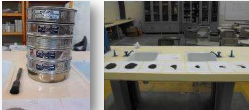
FIGURA 5.2.7.2 Análisis de la granulometría se limpian las mallas y se separan las cantidades obtenidas en cada una de ellas (Fuente J. A. Guzmán Torres)
