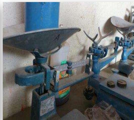
FIGURA 5.2.5.2 Determinación de la M.V.S.V. Se llena el molde en 3 capas, se varilla y se pesa la muestra (Fuente J. A. Guzmán Torres)
