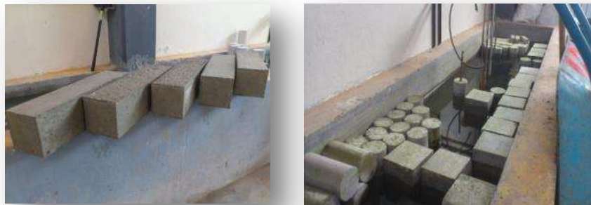
FIGURA 6.1.6.2.3 Descimbrado de los ensayes y curado (Fuente J. A. Guzmán Torres)
