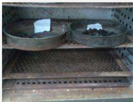
FIGURA 5.2.14.1 Determinación de la Humedad de absorción en grava (Fuente J. A. Guzmán Torres)
