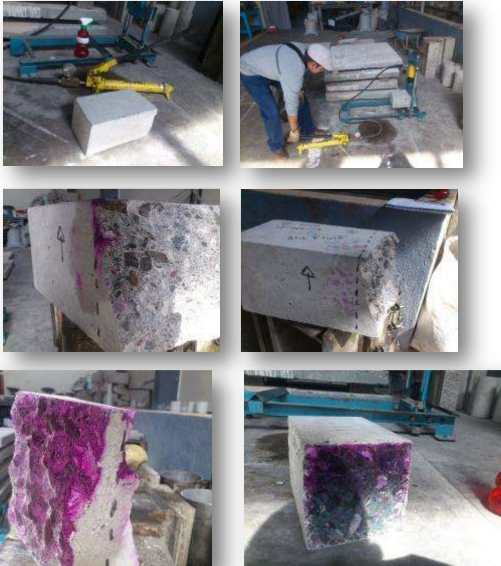
FIGURA 8.1.5.2 Prueba de Carbonatación (Fuente J. A. Guzmán Torres)
