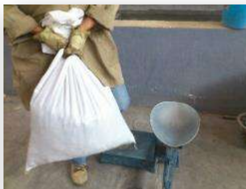
FIGURA 5.2.11.1 Muestreo de la muestra y se pesa el material para su carteo (Fuente J. A. Guzmán Torres)
