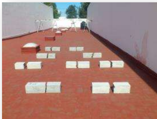
FIGURA 8.1.5.1 Especímenes expuestos al intemperismo (Fuente J. A. Guzmán Torres)
