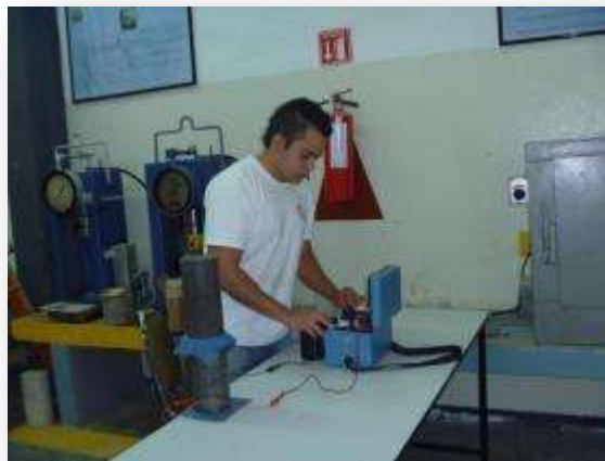
FIGURA 7.1.1.2 Prueba de Resistividad (Fuente J. A. Guzmán Torres)
