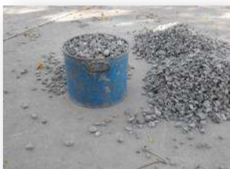
FIGURA 5.2.16.1 Determinación de la M.V.S.S en grava (Fuente J. A. Guzmán Torres) Para obtener la M.V.S.S del material se realizaron pruebas al quintuplicado del material, y los resultados se muestran en la siguiente tabla:
