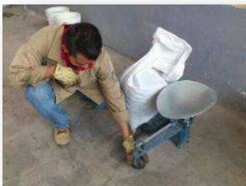
FIGURA 5.2.11.1 Muestreo de la muestra y se pesa el material para su carteo (Fuente J. A. Guzmán Torres)
