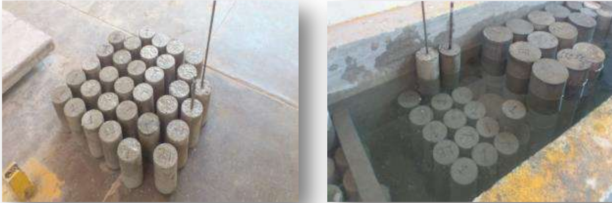
FIGURA 6.1.6.1.6 Descimbrado de los ensayos y curado (Fuente J. A. Guzmán Torres)
