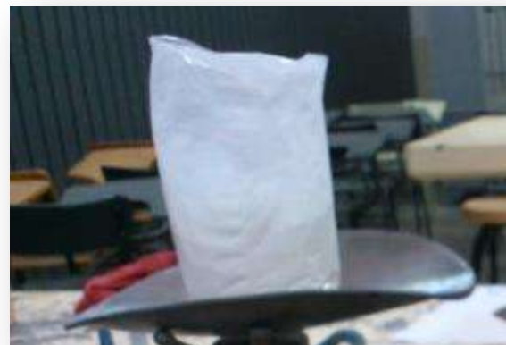
FIGURA 6.1.6.1.4 Adición del geopolímero orgánico natural a la mezcla, (Fuente J. A. Guzmán Torres)
