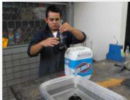
FIGURA 5.3.4.1 Determinación de la Densidad del cemento (Fuente J. A. Guzmán Torres)
