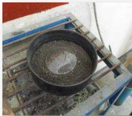
FIGURA 5.2.3.1 Secado de la muestra de manera superficial con ayuda del cono troncocónico (Fuente J. A. Guzmán Torres)
