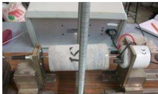
FIGURA 7.1.3.2 Punto nodal al centro del largo de un cilindro (Fuente J. A. Guzmán Torres)
