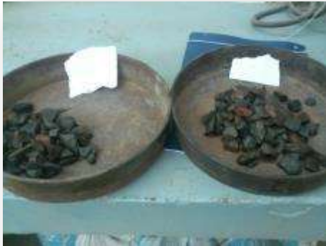
FIGURA 5.2.13.1 Humedad actual en grava (Fuente J. A. Guzmán Torres)
