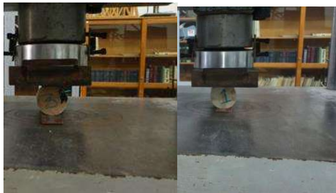
Imagen VII-10.-Prueba de tensión indirecta (Brasileña) (Ref. 23).
