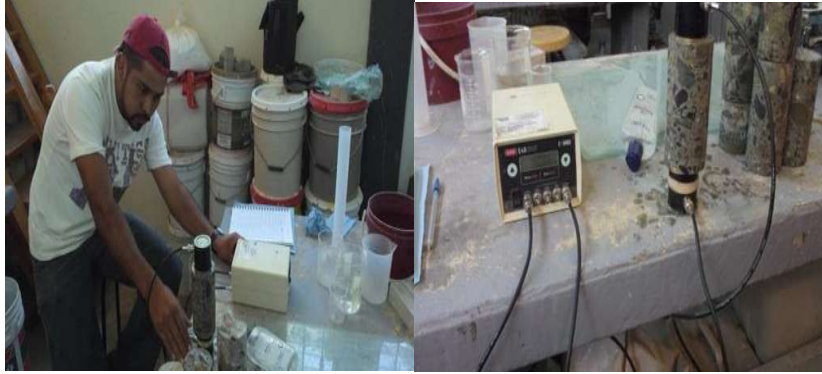
Imagen VII-8.-Medición de la velocidad de pulso ultrasónico
