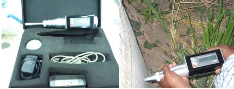
Imagen VII-9.-Equipo esclerométrico y ejemplo de prueba en el puente “La Manzanilla I”
