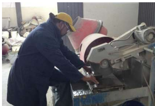
Imagen VII-3.-Corte de los núcleos de concreto para cloruros.
