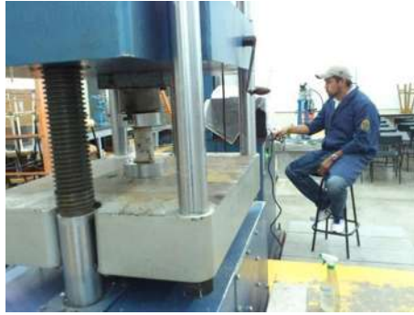
Imagen VII-15.-Prueba de compresión simple.
