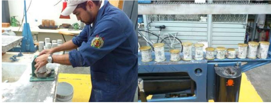
Imagen VII-14.-.- Cabeceo de los núcleos de concreto.
