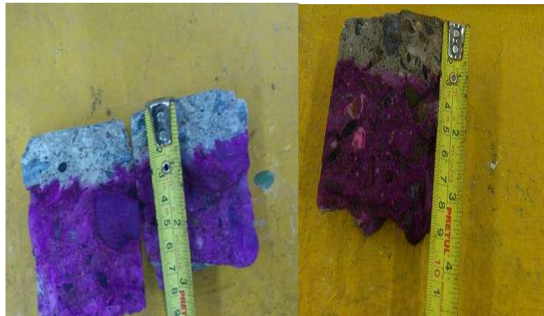
Imagen VII-11.-Prueba de carbonatación.
