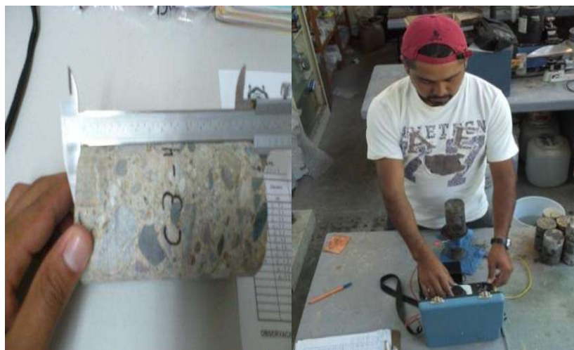
Imagen VII-6.-Medición de los especímenes y prueba de resistividad eléctrica.
