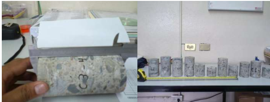
Imagen VII-13.-Determinación de las dimensiones de los núcleos.
