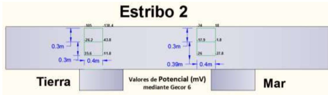
Figura 44. Potencial de corrosión en el Estribo 2.
