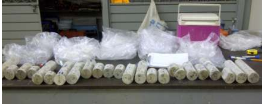
Imagen 24. Total de muestras de concreto extraídas.
