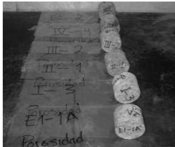
Imagen 26. Rodajas de 5 cm para prueba de porosidad.
