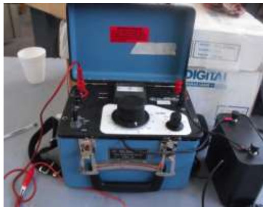
Imagen 43. Resistómetro Nilsson utilizado para el análisis [30].
