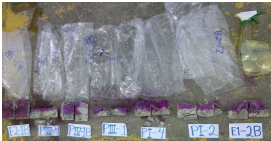
Imagen 27. Profundidad de carbonatación mediante análisis químico.
