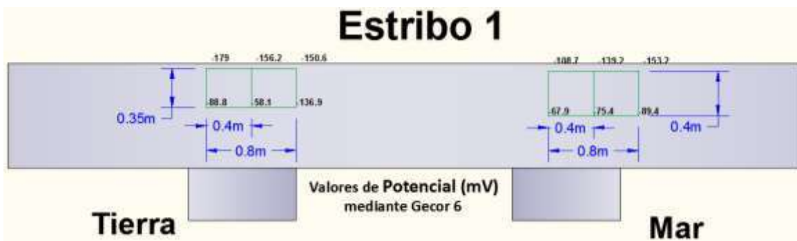
Figura 39. Potencial de corrosión en el Estribo 1.
