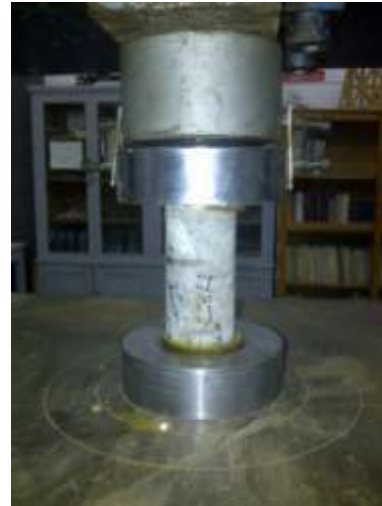
Imagen 32. Prueba de compresión simple.
