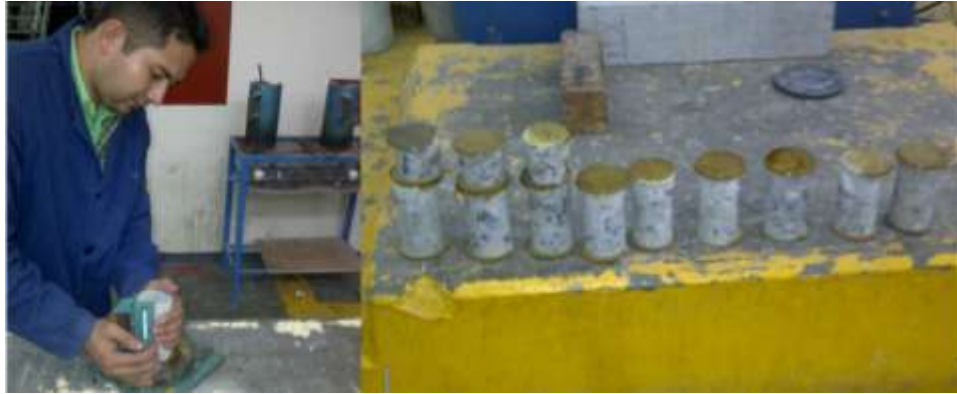
Imagen 31. Cabeceado de especímenes cilíndricos relación 2 a 1.
