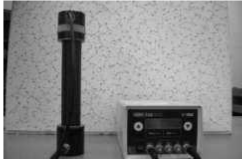
Imagen 44. Equipo de Velocidad de Pulso Ultrasónico utilizado.
