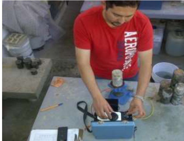
Imagen 29. Prueba de resistividad eléctrica.
