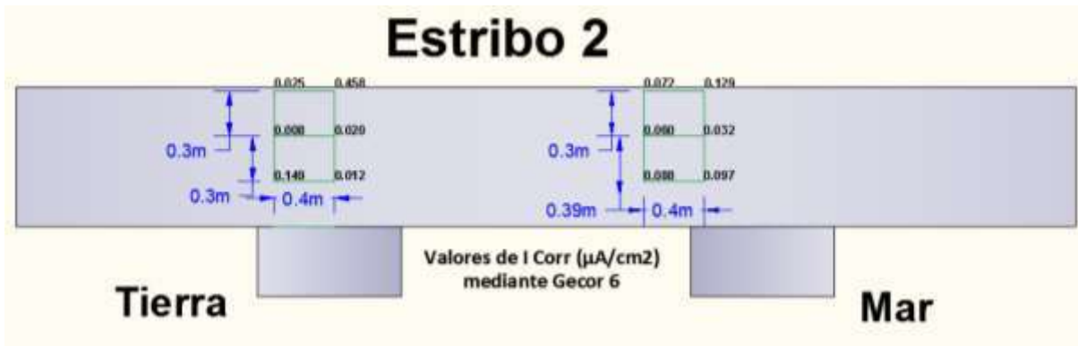
Figura 38. Velocidad de corrosión en el Estribo 2.
