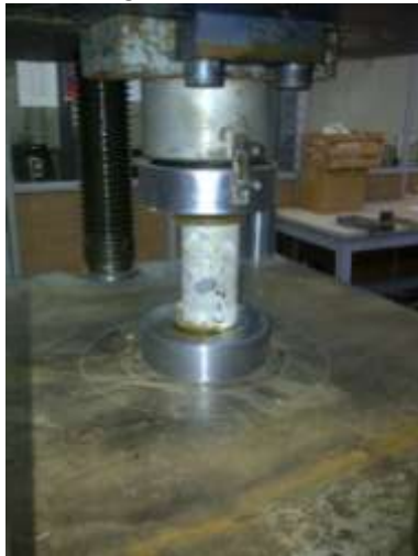
Imagen 32. Prueba de compresión simple.
