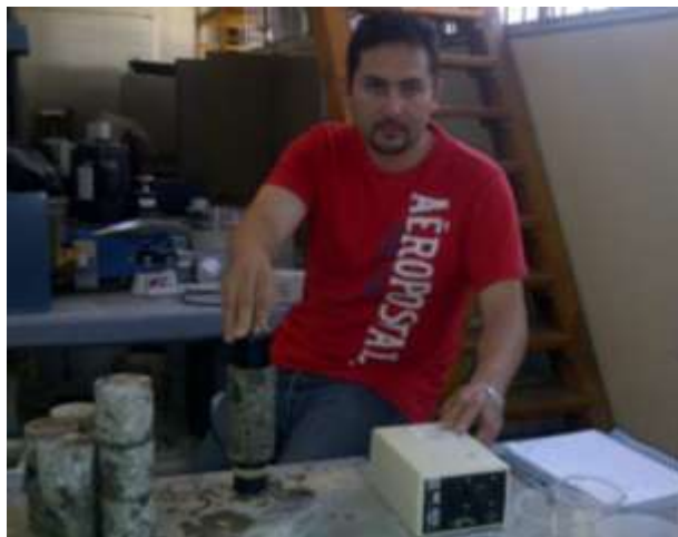
Imagen 30. Prueba de velocidad de pulso ultrasónico.
