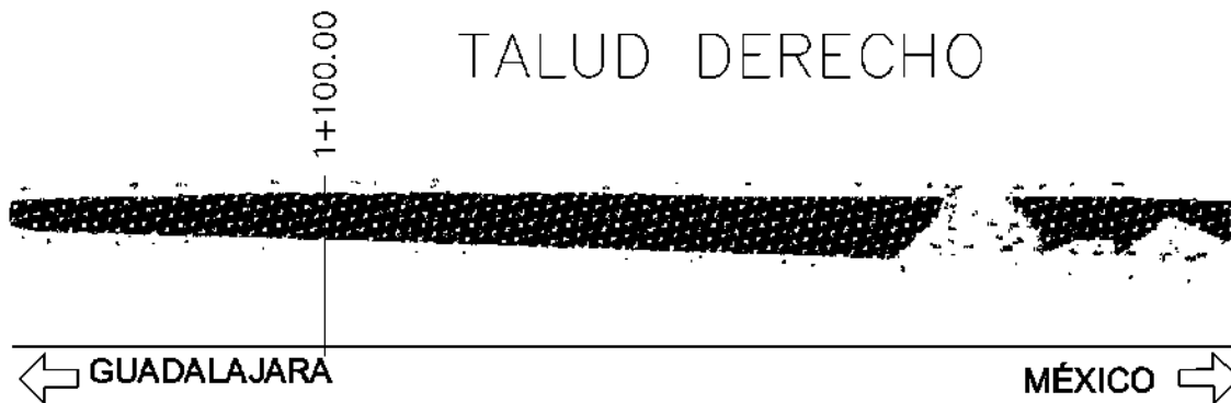
Figura 6.13.- Perfil de las zonas más críticas para el análisis en el Rocfall del talud ubicado en el lado derecho del km 237+000.
