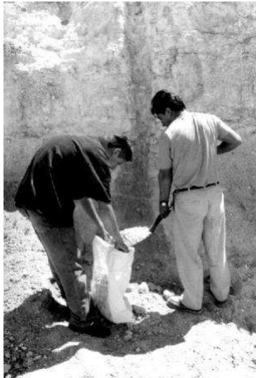
Figura 3.1.- Selección de muestras de material para realizar las pruebas en laboratorio (SCT, 2003).
