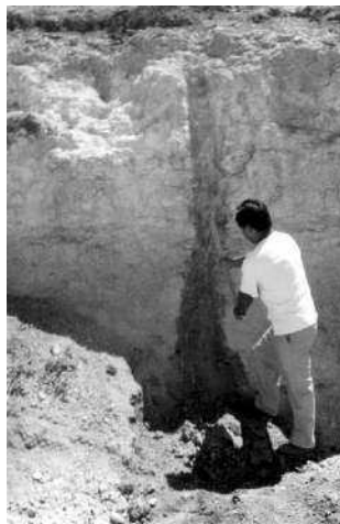
Figura 3.7.- Toma de muestras de suelo en campo para las pruebas en laboratorio (SCT, 2003).
