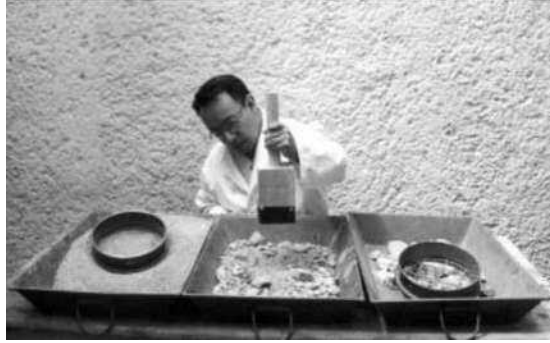
Figura 3.8.- Disgregado del material de suelo (SCT, 2003).
