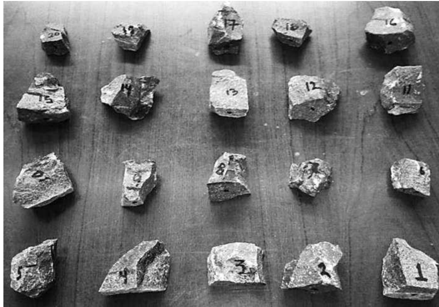
Figura 5.12.- Muestras para someterlas al ensayo a carga puntual (ASTM D-5731, 2002).
