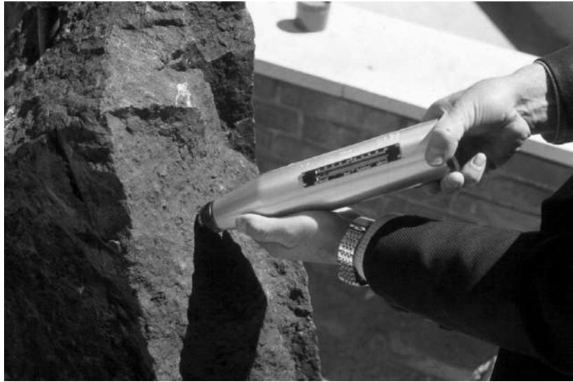
Figura 3.3.- Equipo utilizado para medir la resistencia de la roca, esclerómetro o martillo de Schmidt (Ramírez Oyaguren y Leandro Alejano et al, 2004).
