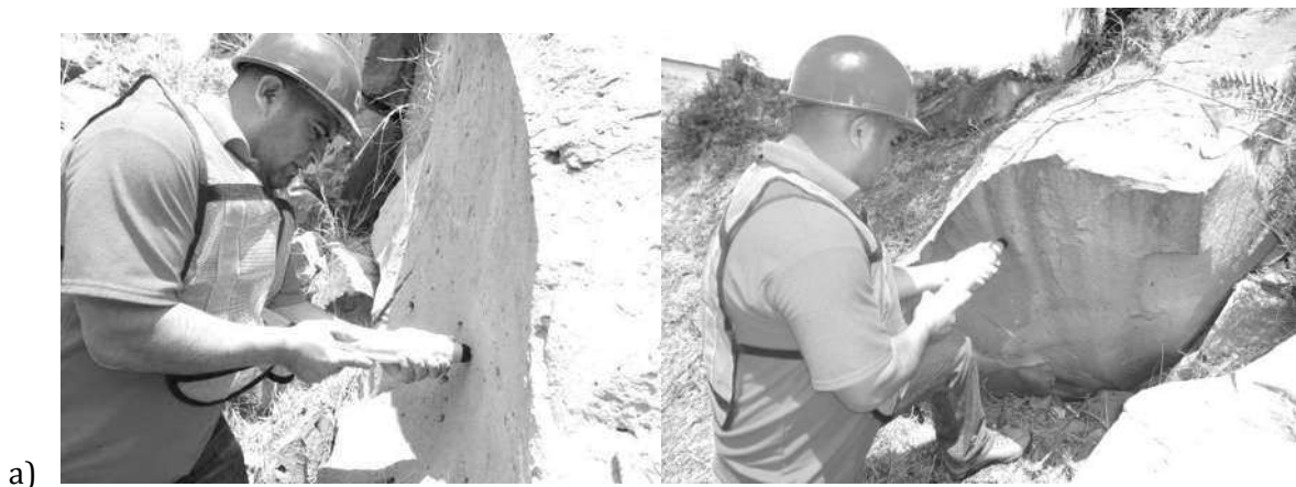
Figura 5.11.- Pruebas de esclerómetro realizadas in situ en una masa de roca.
