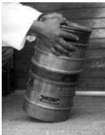
Figura 3.12.- Cribado del material que pasó la malla N°4 (SCT, 2003).
