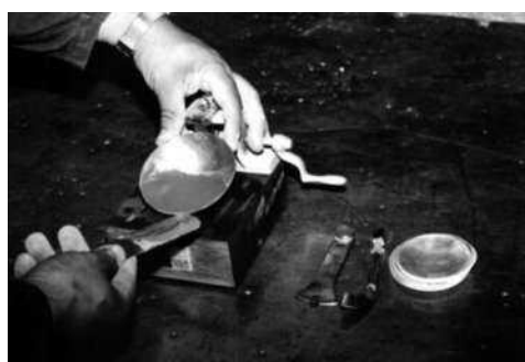
Figura 3.13.- Colocación del material para la prueba en la copa de Casagrande (SCT, 2007).
