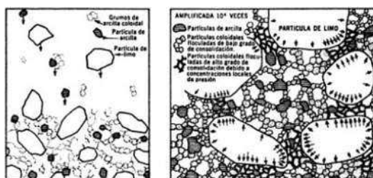
Figura 2.26.- Estructura compuesta (Casagrande, 1980).
