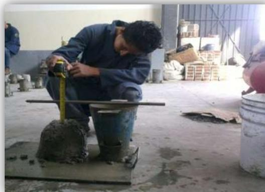
**Figura 11. Prueba de revenimiento en la mezcla de concreto fresco. (Propia del autor)**
