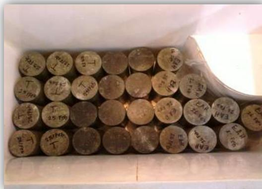
Figura 23. Especímenes cilíndricos de concreto de las diferentes mezclas, dentro del congelador (primer ciclo).
