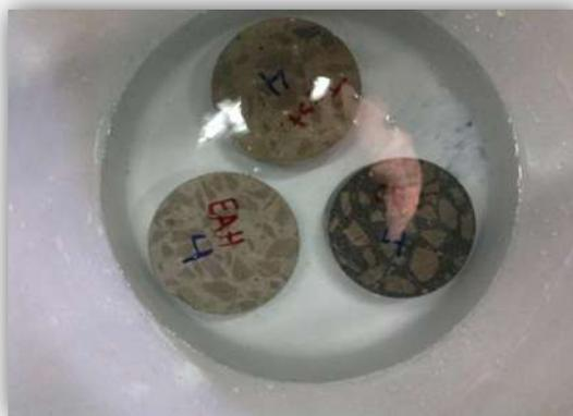
Figura 26. Especímenes sumergidos para realización el ensayo de Absorción de agua. (Propia del autor)
