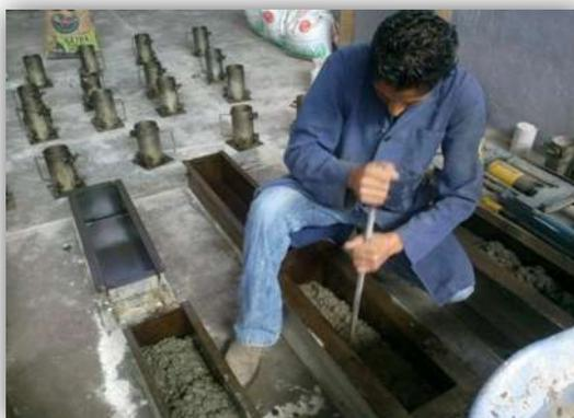
Figura 13. Llenado de los espécimenes prismáticos de la mezcla Testigo. (propia del autor)
