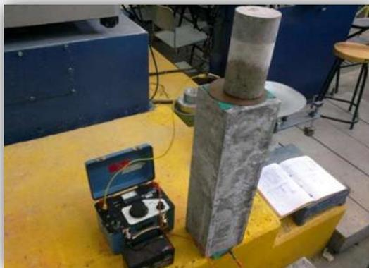
Figura 15. Medición de la resistencia eléctrica un espécimen prismático de la mezcla EAH. (Propia del autor)
