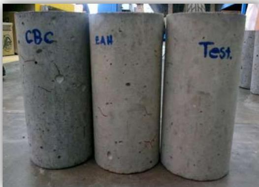
**Figura 51.** Especímenes cilíndricos de las diferentes mezclas, después de 15 ciclos repetidos de congelamiento y deshielo. (Propia del autor)
