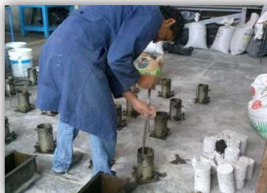
**Figura 12. Llenado de los especímenes cilíndricos de la mezcla Testigo. (Propia del autor)**
