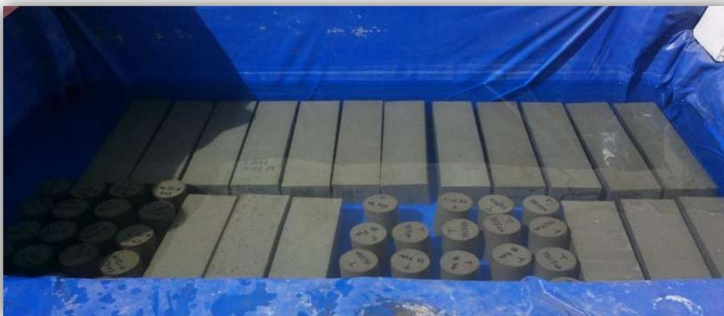
Figura 14. Curado de los espécimenes de concreto elaborados con las diferentes mezclas de concreto, con y sin sustitución. (Propia del autor)
