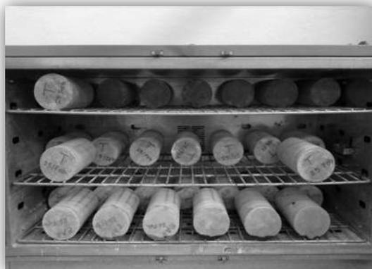
Figura 24. Especímenes dentro del horno después de 24 horas de congelamiento (Primer ciclo). (Propia del autor)
