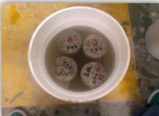
Figura 21. Especímenes de EAH sumergidos en la solución de sulfato. (Propia del autor)
