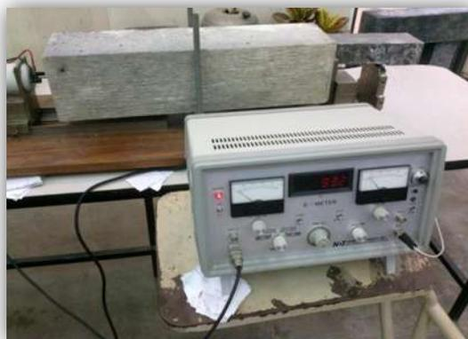
Figura 17. Realización de la prueba para determinar la frecuencia de resonancia en un espécimen prismático de EAH. (Propia del autor)
