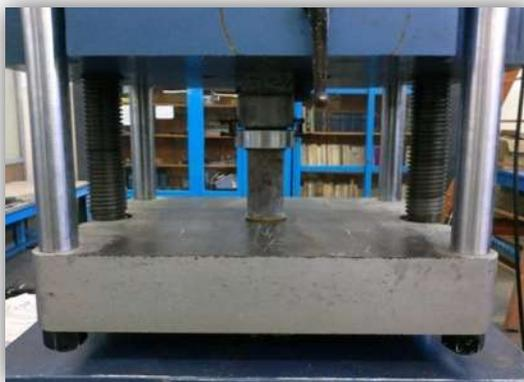
Figura 18. Prueba de compresión simple en un espécimen cilíndrico de la mezcla testigo. (Propia del autor)
