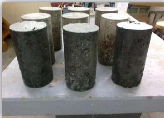
Figura 50. Especímenes cilíndricos de las diferentes mezclas de concreto después de 4 ciclos de inmersión en la solución de sulfato. (Propia del autor)
