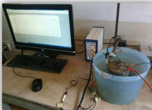
Figura 29. Realización de la prueba de Resistencia a la Polarización ( $R_p$ ), para posterior cálculo de la velocidad de corrosión, en espécimen con sustitución de EAH. (Propia del autor)
