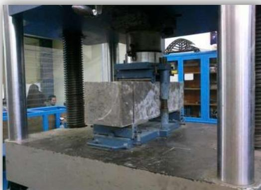
Figura 20. Prueba de flexión en espécimen prismático de la mezcla EAH. (Propia del autor)
