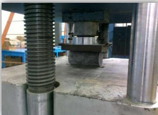
Figura 19. Prueba de tensión indirecta en espécimen cilíndrico de la mezcla CBC. (Propia del autor)
