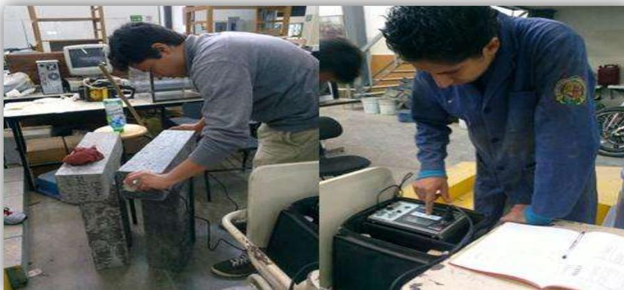
Figura 16. Medición de la velocidad de pulso ultrasónico en espécimen prismático de mezcla CBC. (Propia del autor)
