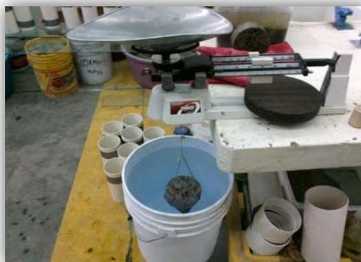
Figura 27. Obtención del peso sumergido de una probeta con sustitución de EAH para realización del ensayo de porosidad total. (Propia del autor)
