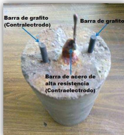
Figura 10. Espécimen cilíndrico para realización de las pruebas de  $R_p$  y diferencia de potencial. (Propia del autor)
