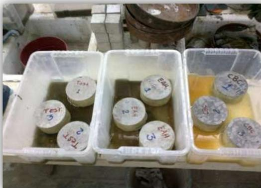
Figura 25. Realización del ensayo de absorción capilar. (Propia del autor)
