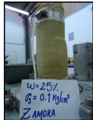
Figura 25 Falla del material (Colapso), (Zamora, Chávez 2012).
