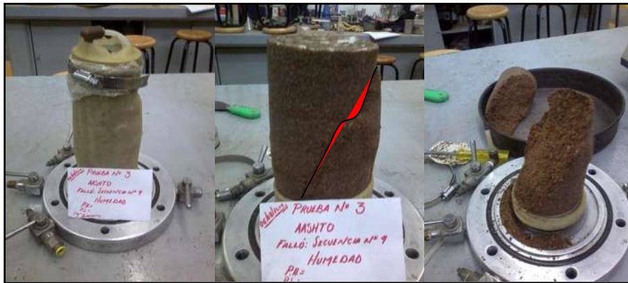
Figura 93 Se observa la falla que presentó el espécimen.
