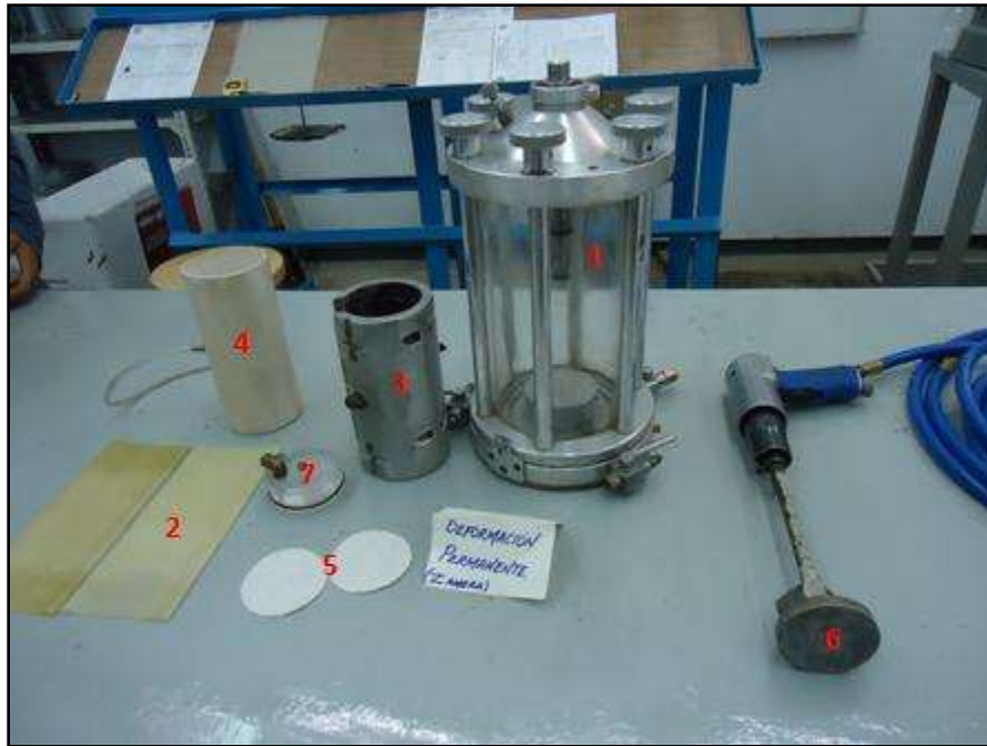
Figura 31 Equipo necesario para el ensayo de deformación permanente para este trabajo.
