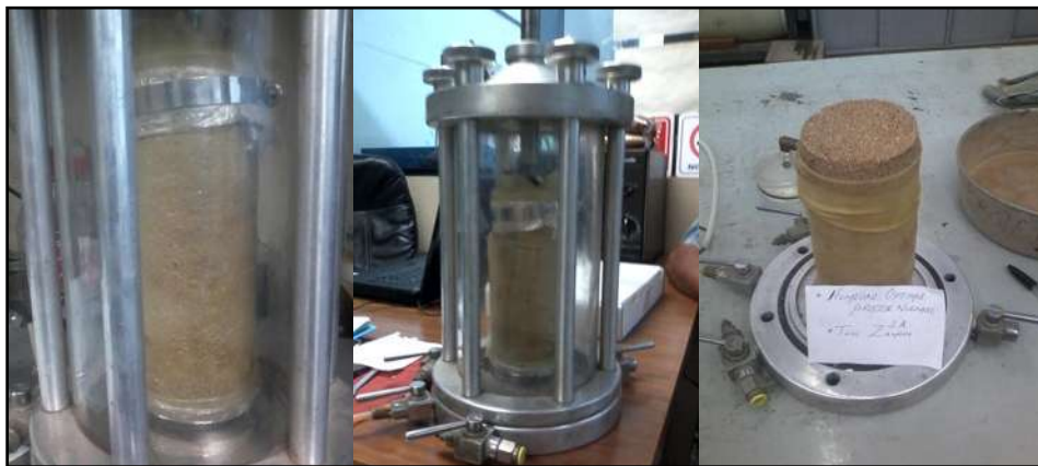
Figura 78 Especimen antes y después de la falla.
