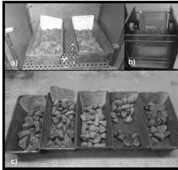
Figura F.I.- Prueba de durabilidad: a) etapa de secado en horno eléctrico; b) etapa de humedecimiento y desmoronamiento; c) muestras después del primer ciclo.
