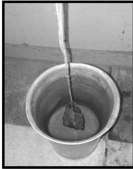
Figura 3.14.- Muestra recubierta por parafina y suspendida en agua.
