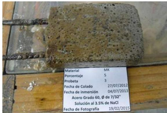
D-2 Morteros de cemento sustituidos con 10% de MK.
