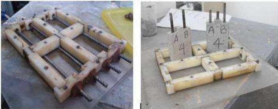
*Ilustración 32 Moldes de acrílico para la elaboración de las probetas a emplearse en las pruebas electroquímicas. Por el autor.*
