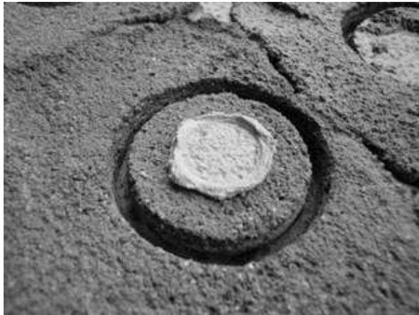
***Ilustración 47*** Falla entre epóxico y el disco metálico.
