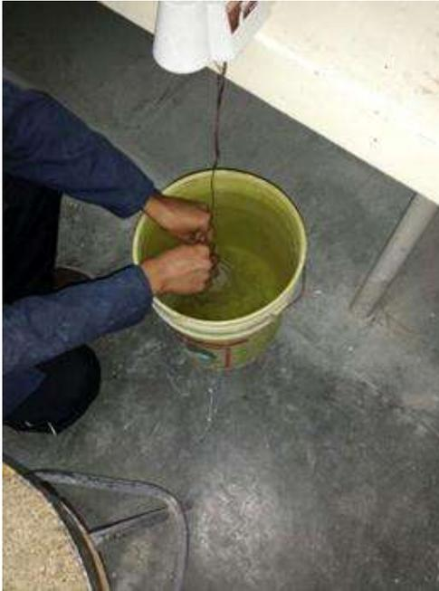
*Ilustración 23 Cálculo de la gravedad específica. Método de inmersión. Por C. Bernabé*
