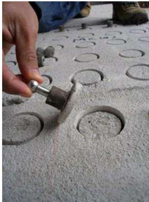
***Ilustración 48*** Falla entre revestimiento y el estrato. Tipo (3). Material MK.
