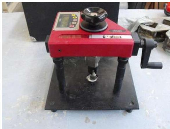
*Ilustración 45 Equipo para prueba Pull Off marca CONTROLS.*
