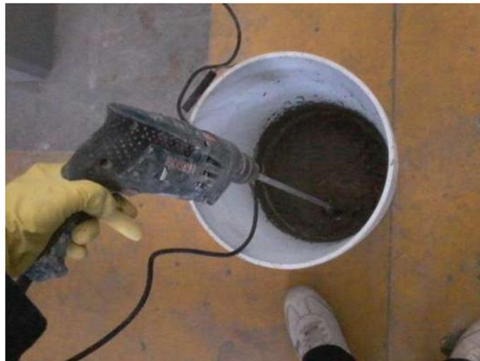
*Ilustración 30 Método de mezclado de áridos mediante aspas de acero impulsadas por el taladro.*
