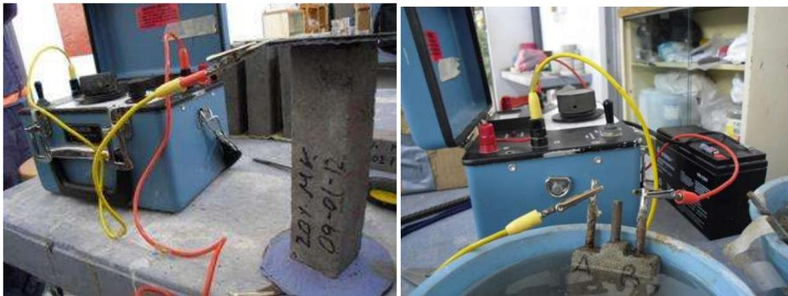
*Ilustración 63 Izquierda- Espécimen prismático colocado entre las dos placas de cobre para tomar la resistencia eléctrica. Derecha- Medición de la resistencia eléctrica en las probetas con barras de acero. Por C. Bernabé.*
