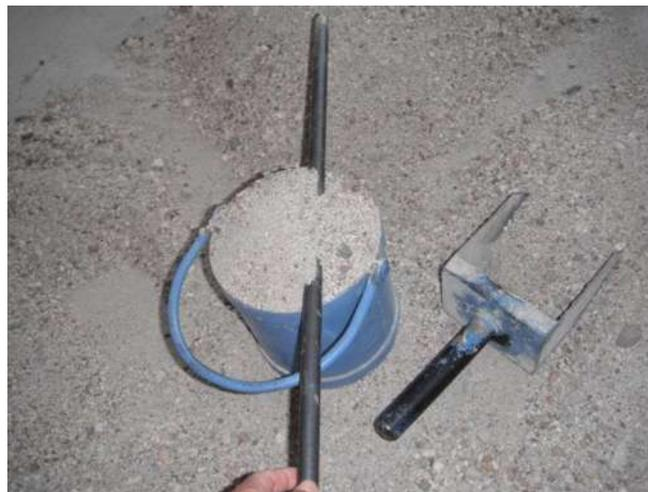
*Ilustración 19 Equipo para realizar la prueba de MVSS.*
