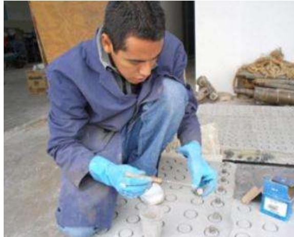
*Ilustración 42 Pegado de los discos de acero en el recubrimiento de mortero.*
