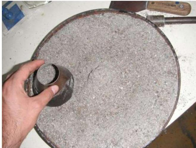
*Ilustración 18 Procedimiento para obtener el secado superficial NMX – C – 165 – ONNCCE – 2004.*
