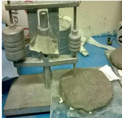
*Ilustración 29 Aparato de Gillmore para la realización de los tiempos de fraguado.*
