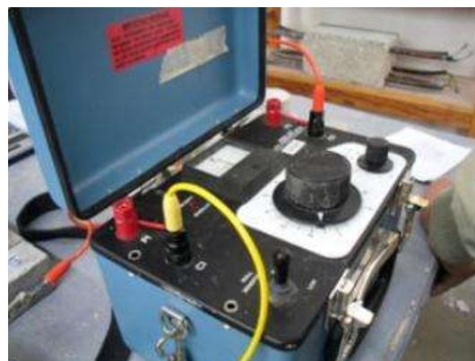
*Ilustración 62 Equipo utilizado para determinar la resistividad eléctrica.*
