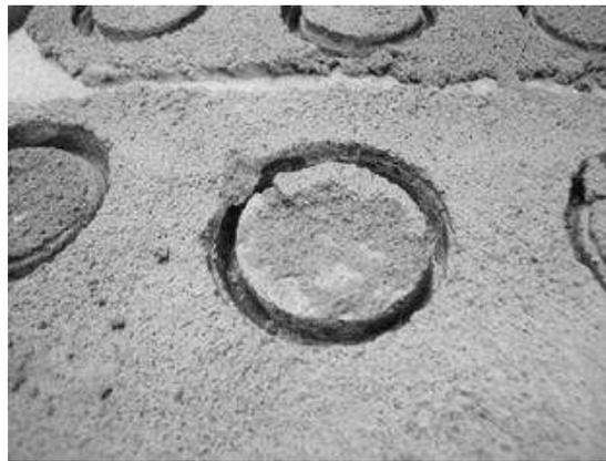
*Ilustración 49 Falla en el revestimiento. Tipo 4.*
