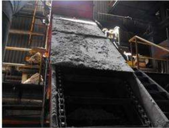
*Ilustración 25 Proceso de transporte de residuos de molienda de caña.*
