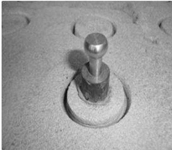
*Ilustración 44 Disco y perno de acero para realizar la prueba de adherencia*
