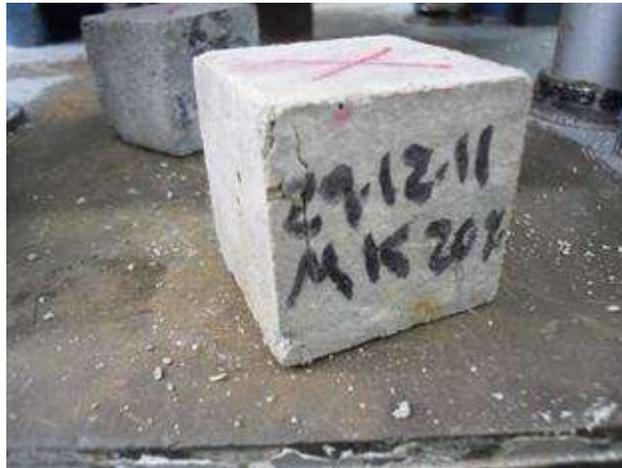
*Ilustración36 Muestra de un cubo probado a compresión de MK con 20% de sustitución.*
