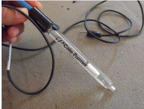
*Ilustración 54 Electrodo de referencia de media celda tipo calomel. Por el autor.*
