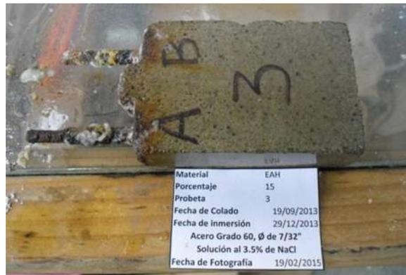
C-4 Morteros de cemento sustituidos con 20% de EAH.
