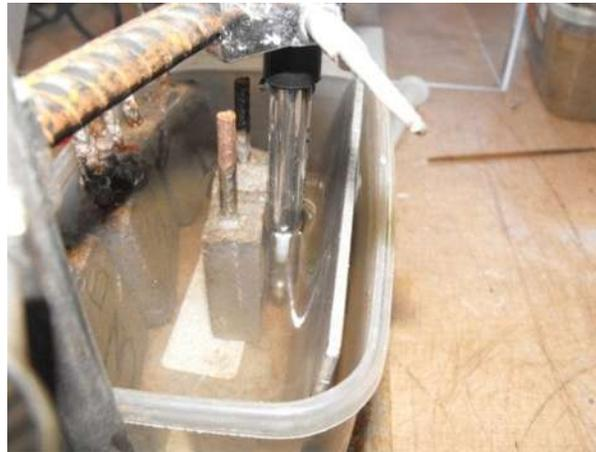
*Ilustración 52 Elementos de la celda electroquímica. La placa funciona como contra-electrodo, el electrodo central es de referencia y la varilla en la probeta es el electrodo de trabajo.*
