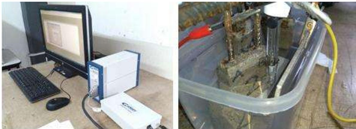
*Ilustración 53 Equipo de Gamry para la realización de las pruebas electroquímicas. Derecha: Conexión de los electrodos. Por el autor.*
