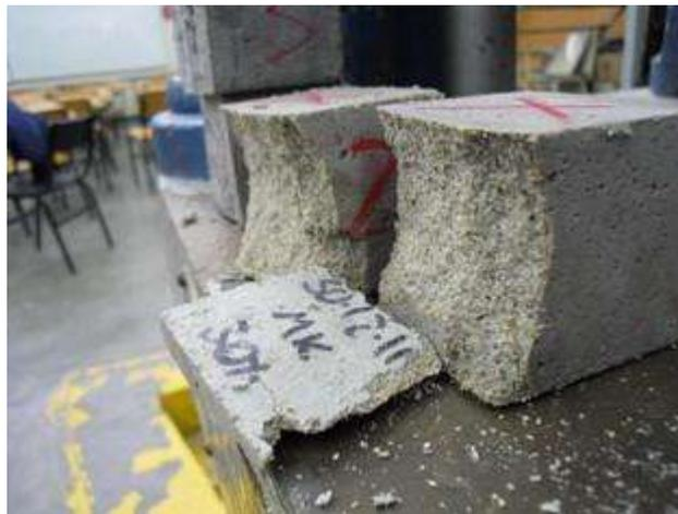
*Ilustración37 Ruptura ideal en cubos. Cubo de MK con el 30% de sustitución.*
