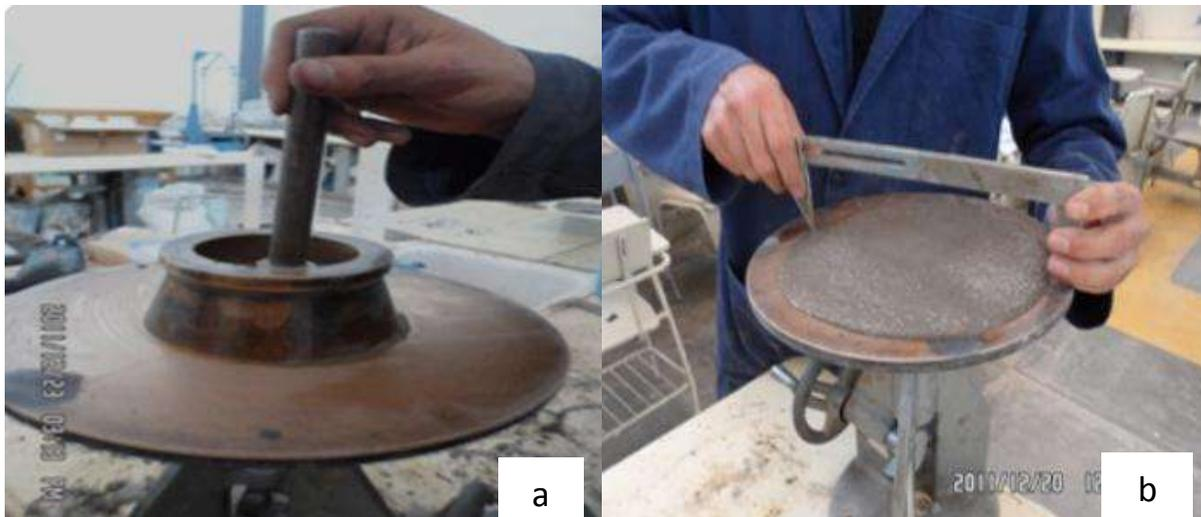
***Ilustración 31 a) Llenado de molde sobre la mesa de fluidez, b) Medición del radio de expansión de la mezcla.***
