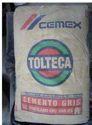
**Ilustración 6 Cemento gris CPC 30R RS Utilizado para la elaboración de los morteros.**
