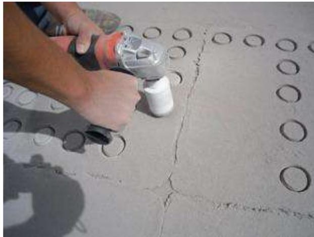
*Ilustración 40 Perforación de las losas para la prueba de adherencia.*
