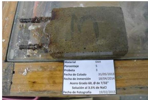
C-2 Morteros de cemento sustituidos con 10% de EAH.
