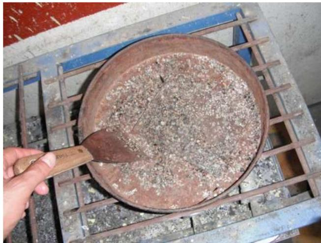
*Ilustración 17 Secado del arena en parrilla para obtener el dato de Ms.*
