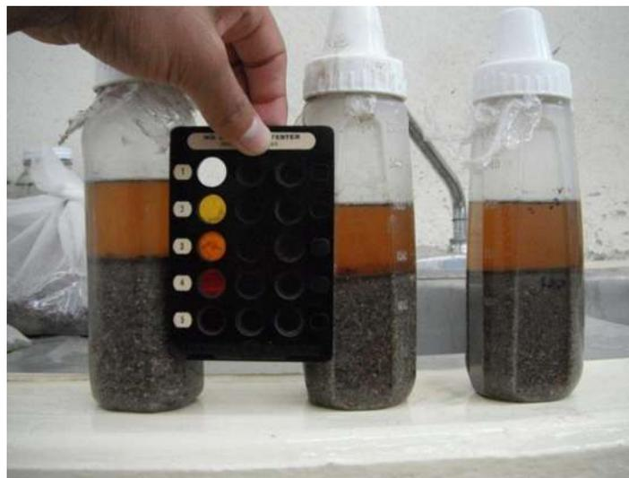
*Ilustración 21 Análisis colorimétrico.*
