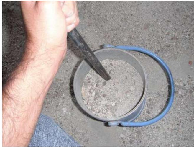
*Ilustración 20 Varillado de la arena en la prueba de MVSV*
