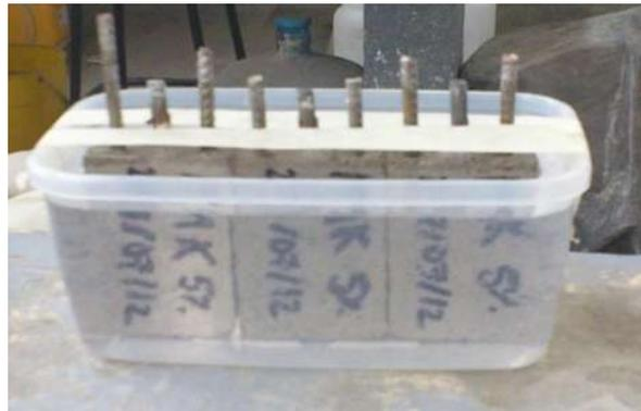
***Ilustración 51 Recipiente conteniendo probetas en inmersión con agua de mar artificial.***
