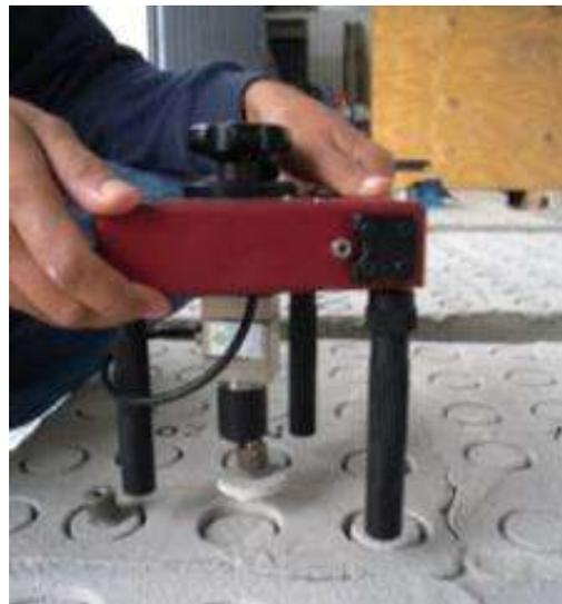
*Ilustración 50 Realización de la prueba de adherencia, mediante el equipo de Pull Off.*
