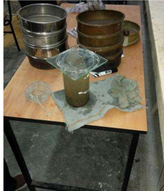
*Ilustración 24 Cálculo de la gravedad específica. Método de inmersión. Por C. Bernabé*
