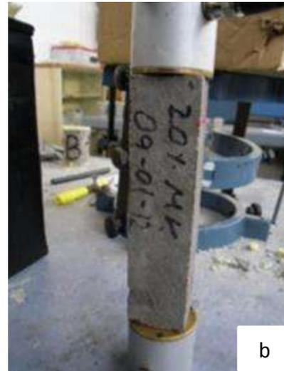
*Ilustración 61 a) Equipo para medir la velocidad de pulso ultrasónico, b) espécimen prismático colocado sobre los transductores al ser realizada la prueba de velocidad de pulso ultrasónico (ASTM-C-597, 2009).*
