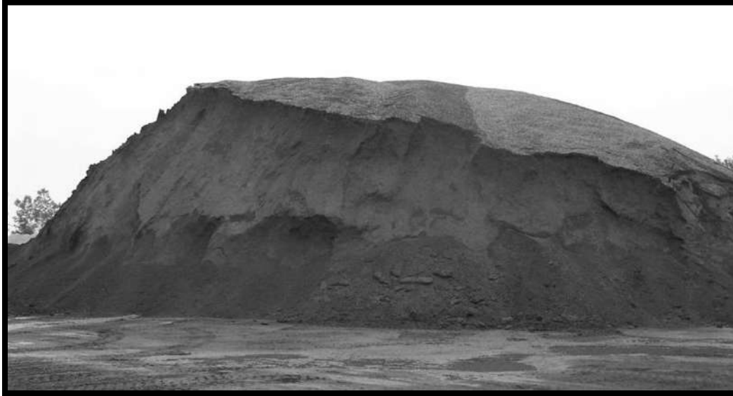
Figura 2.7. RAP procesado con apariencia uniforme.
