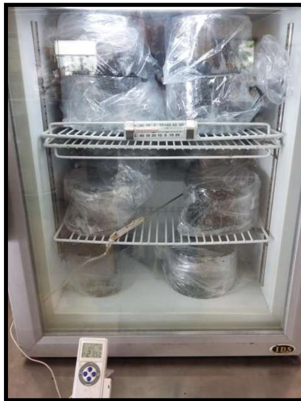
Figura 3.27. Especímenes envueltos dentro del congelador.
