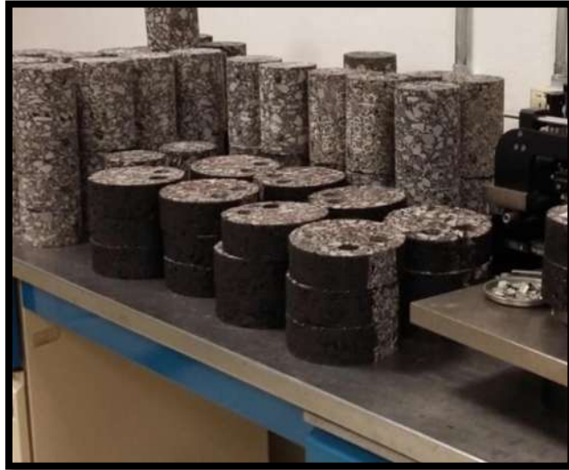
Figura 3.16. Especímenes cortados en rebanadas.
