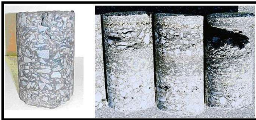
Figura 2.2. Núcleos extraídos de campo.
