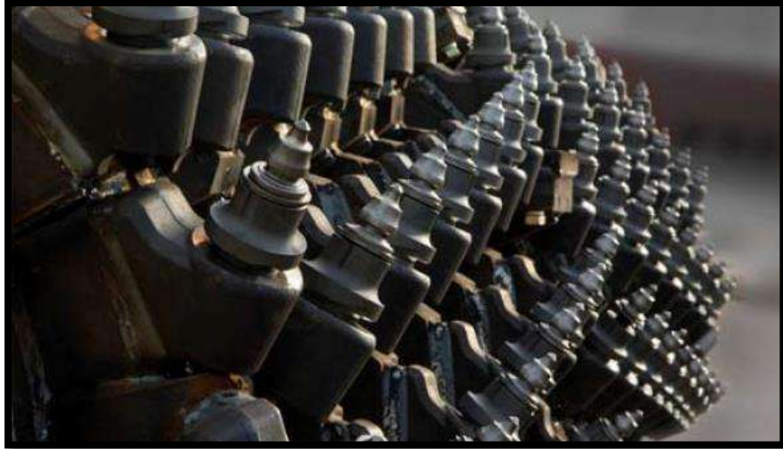
Figura 2.3. Dientes del tambor de fresado.
