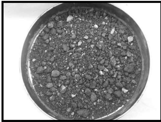
Figura 3.2. Pavimento asfáltico recuperado (RAP).
