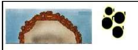
26 Figura 2.6 Coagulación (fuente: Les Emulsiones de bitume Routes de France )
