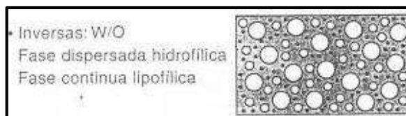
30 Figura 2.10 Emulsión inversa (fuente: Manual técnico básico SemMaterials)
