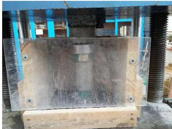
Ilustración 20 Aplicación de Carga al espécimen Testigos de 10 x 20 cm
