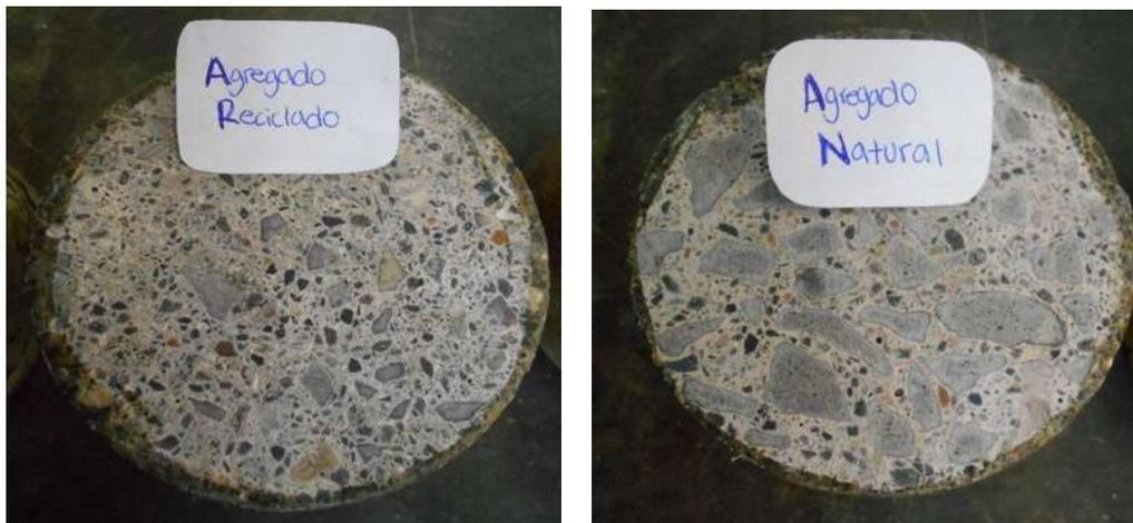
Ilustración 36 Matrices de Concreto.
