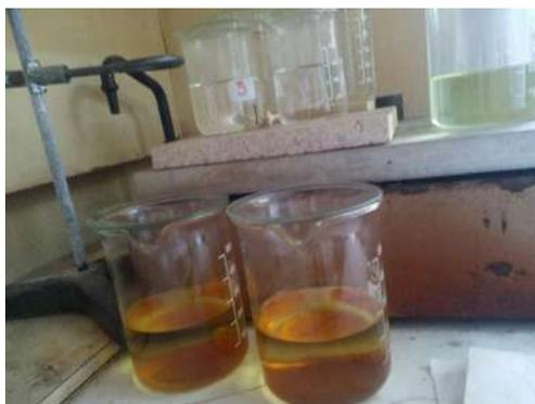
*Ilustración 12 Solución proveniente de la prueba de la determinación de óxidos de hierro y aluminio en el cemento.*
