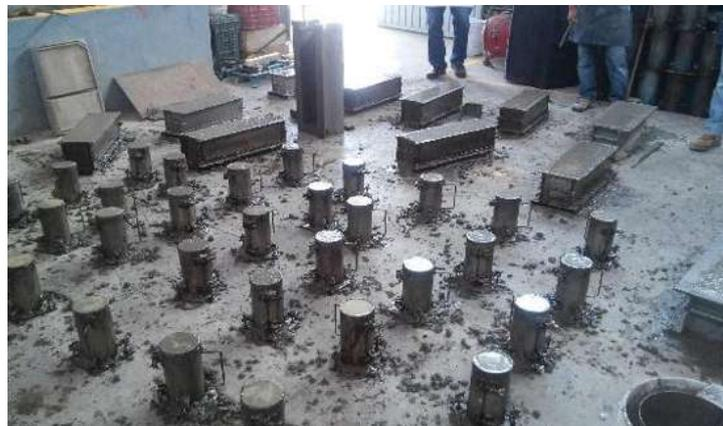
*Ilustración 11 Especímenes de 10 cm x 20 cm y vigas de 15 cm x 60cm de la Mezcla Testigo.*
