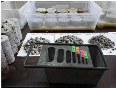
*Ilustración 15 Calibrador de Espesores.*
