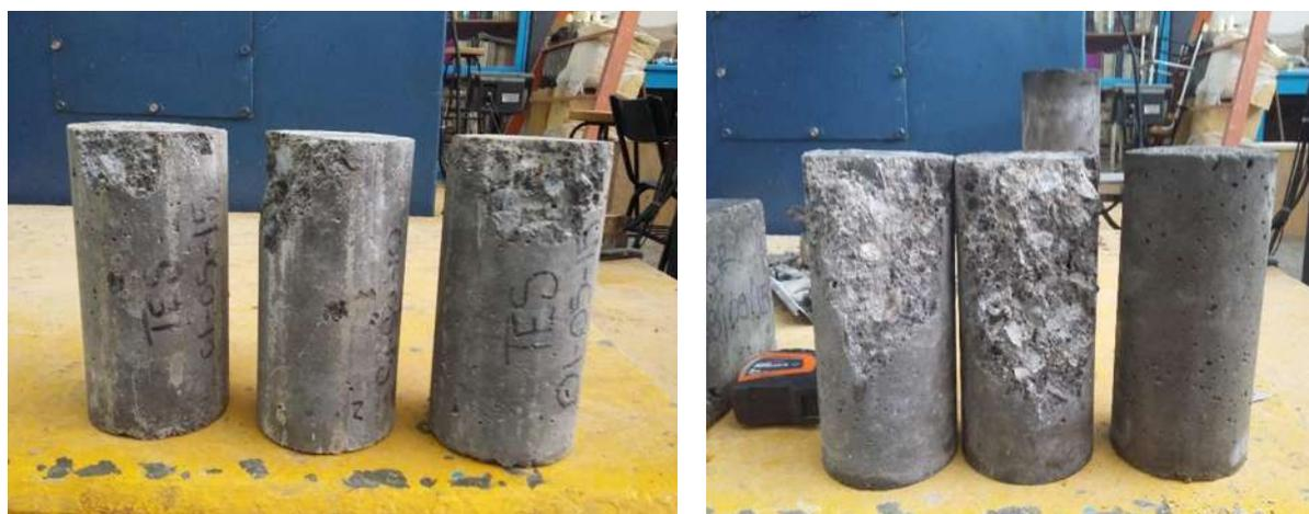
*Ilustración 33 Prueba a compresión en especímenes Testigos (agregado natural) y especímenes con Testigos (agregados reciclados).*
