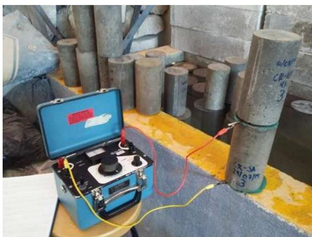
Ilustración 18 Toma de la lectura para la prueba de resistividad eléctrica
