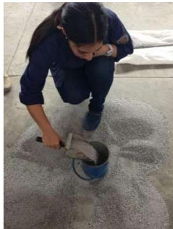
*Ilustración 13 Llenado del Recipiente para la obtención de M.V.S.S del agregado Fino.*
