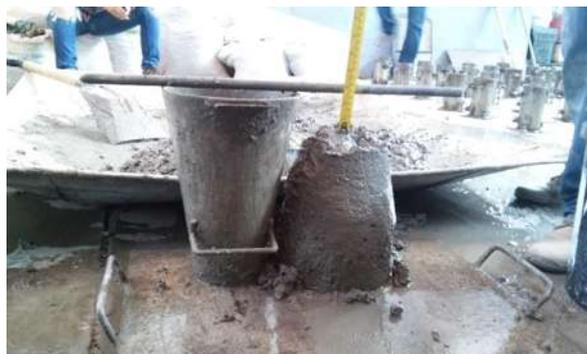
*Ilustración 17 Revenimiento para la mezcla testigo.*
