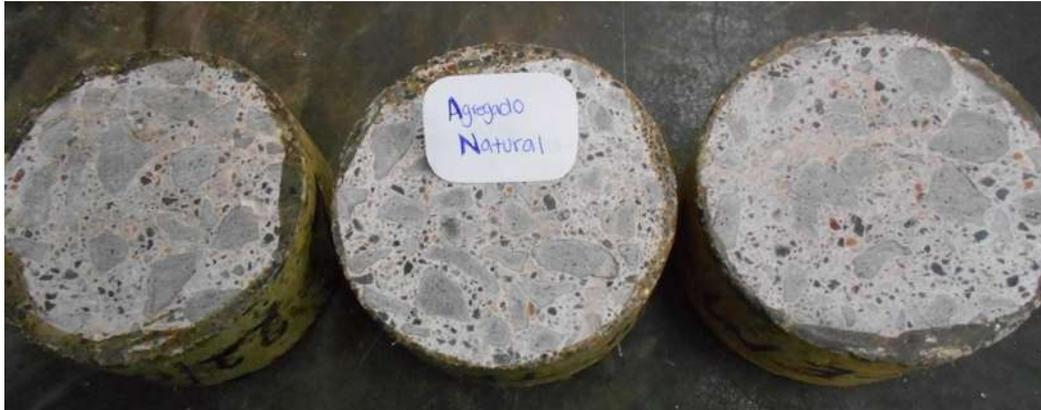
*Ilustración 38 Matrices de Concreto (Agregado Natural).*
