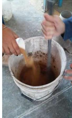
*Ilustración 1 fluidificante CRISOTAN R-5 homogenizado en el agua para la elaboración especímenes.*
