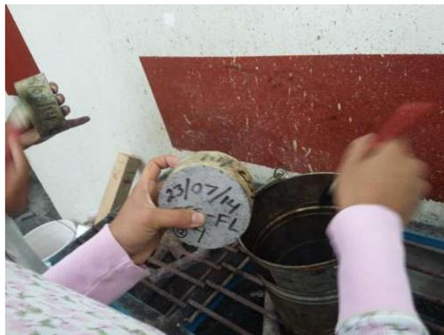
*Ilustración 19 Colocación de la parafina al contorno de las muestras.*
