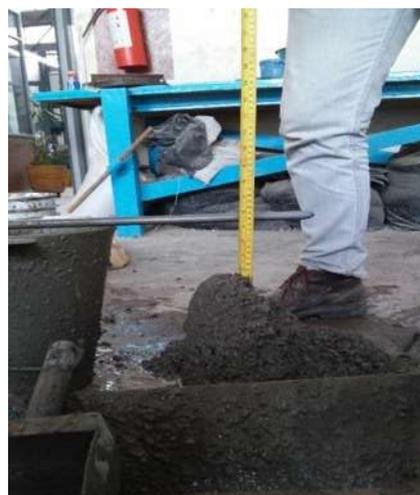
*Ilustración 30.a Revenimiento de la mezcla realizada Tes-FI Ilustración 27.b Revenimiento de la mezcla Tes-EM 4%.*
