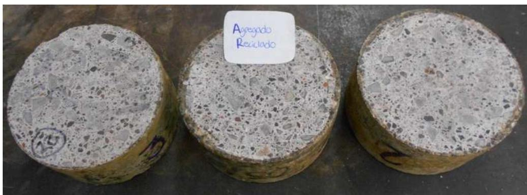
Ilustración 37 Matrices de Concreto (Agregado Reciclado)
