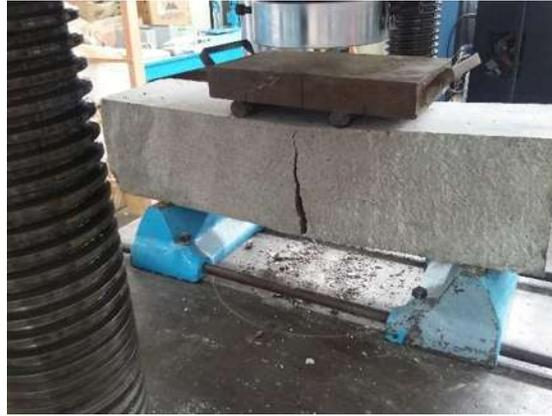
*Ilustración 21 Aplicación de la Carga a Vigas de 15x60 cm.*
