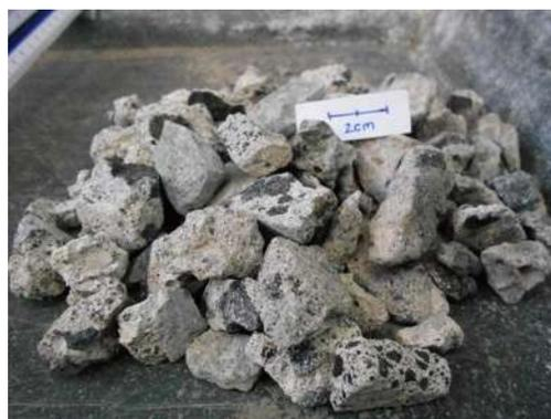
Ilustración 27 (1) agregado grueso natural (2) agregado grueso reciclado.
