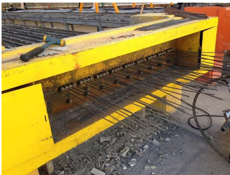
Figura 3.1. Proceso de pretensado en el acero de refuerzo.
