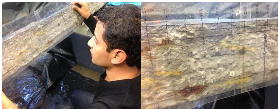
Figura 5.1. Medición de grietas con la utilización de un acetato el cual incluye una cuadrícula para marcar coordenadas.
