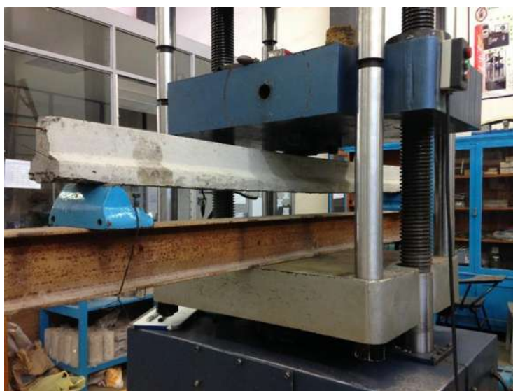
Figura 5.4. Colocación de las vigas en la máquina universal de carga.
