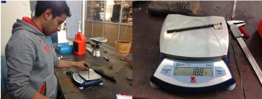
Figura 5.8. Medición de la masa del acero extraído de vías probadas a flexión.
