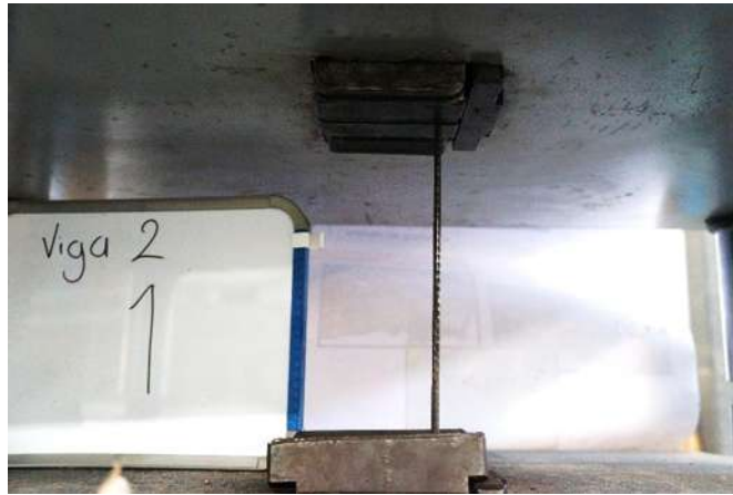
Figura 4.10. Prueba de tensión en varillas extraídas.
