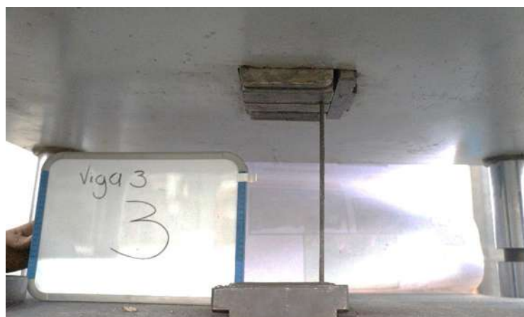
Figura 5.9. Prueba a tensión en varillas extraídas, después de llevar a cabo la prueba de flexión.
