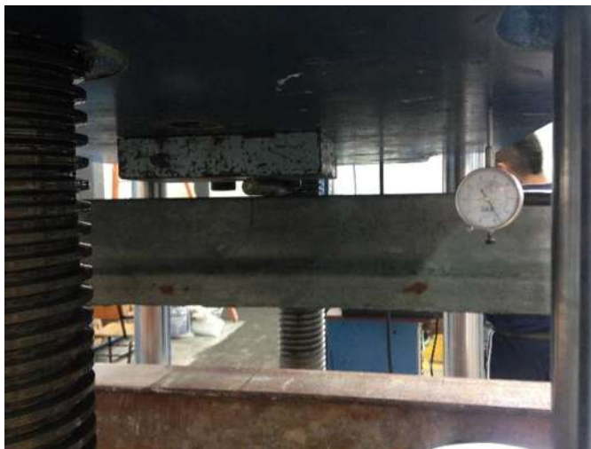
Figura 5.5. Medición de deformación en la prueba de flexión.
