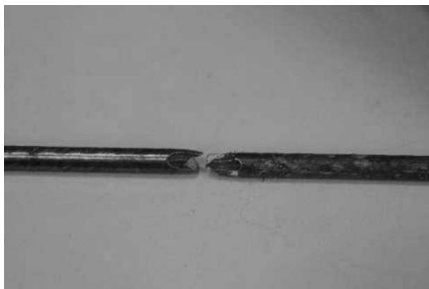
Figura 5.11. Ruptura de la varilla después de la prueba de tensión
