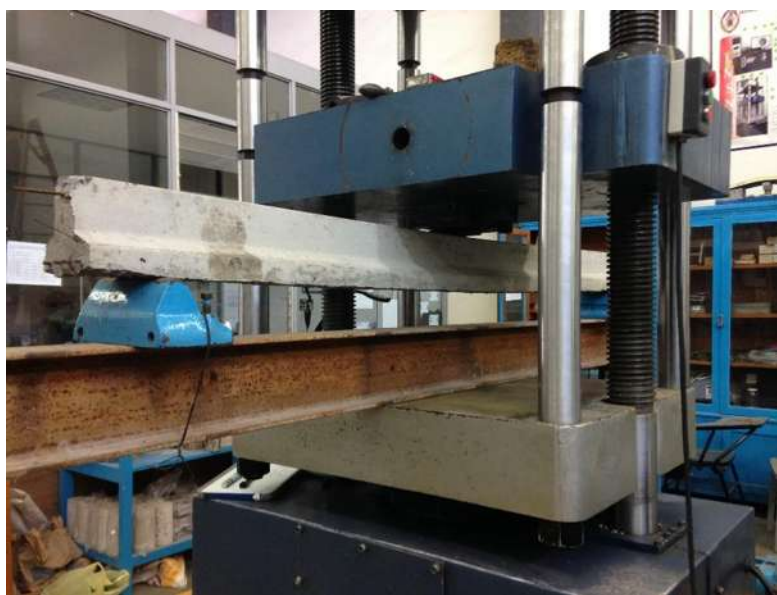
Figura 4.9. Prueba de flexión en vigas.
