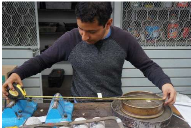
Figura 5.10. Medición del alargamiento final del acero, después de realizada la prueba de tensión
