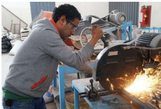
Figura 5.7. Obtención de sección de varilla para su caracterización.
