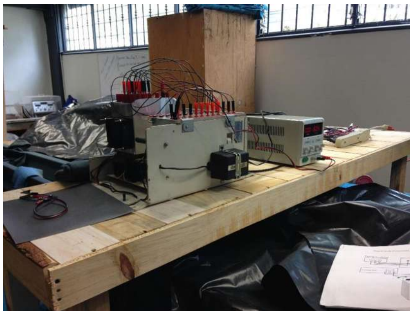
Figura 4.5. Galvanostato utilizado en la investigación.
