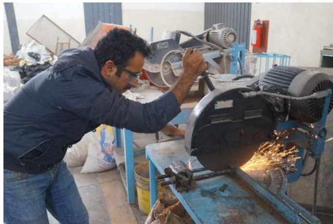
Figura 28. Corte de varilla para la medición de masa
