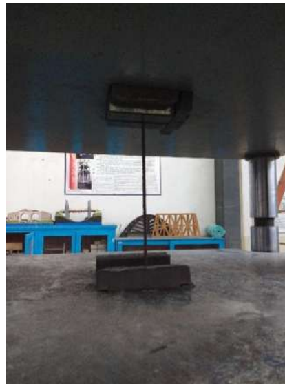
Figura 30. Prueba de tensión en varillas pre-esforzadas.
