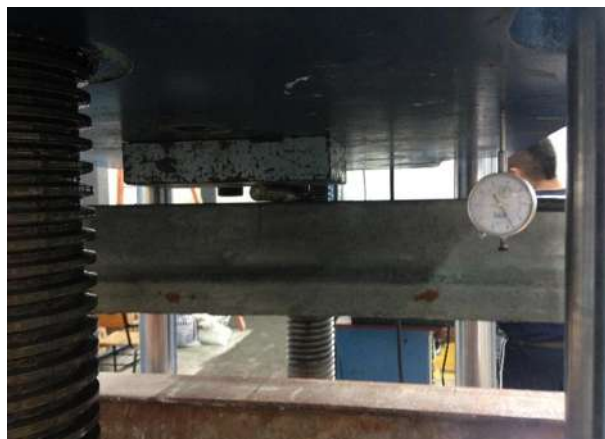
Figura 25. Medición de la deformación durante la prueba de flexión.
