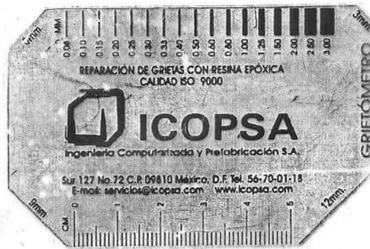
Figura 23. Grietometro empleado para la medición del ancho de grieta
