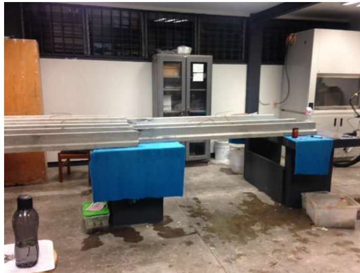
Figura 19. Colocación de viguetas en laboratorio
