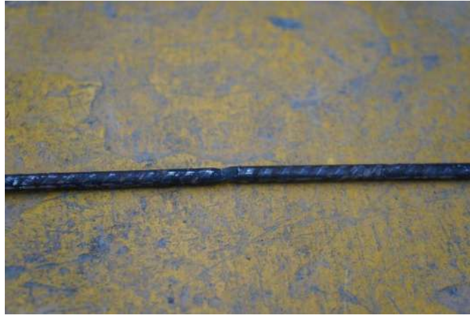
Figura 29. Ruptura de la varilla posterior a prueba de tensión
