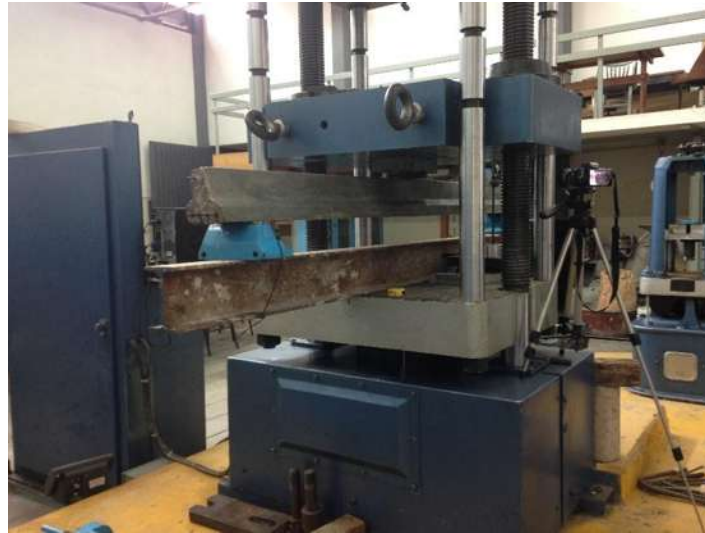
Figura 24. Adaptación de base para prueba de flexión.
