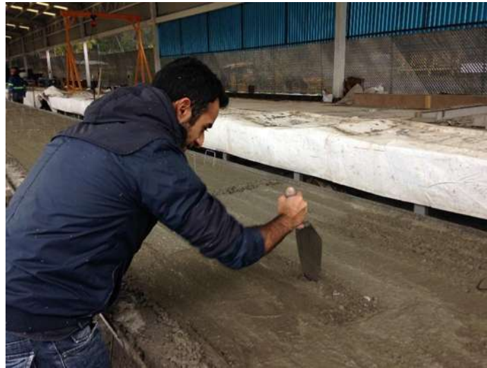
Figura 17. Elaboración de especímenes (adición del NaCl)
