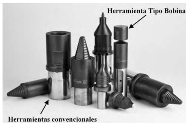
Figura 17. Herramientas empleadas en el proceso FSW [76].
