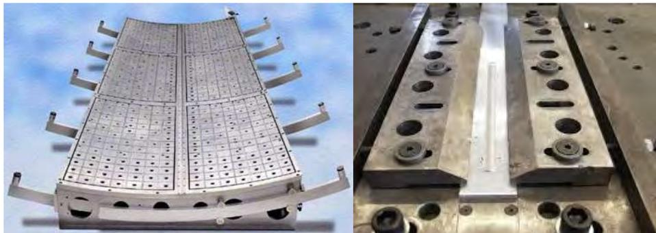
Figura 15. Elementos de Sujeción Empleados en el Proceso FSW [69].
