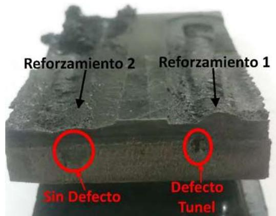
Figura 77. Sección transversal del reforzamiento del ABS.
