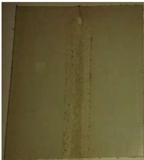
Figura 34. Soldadura por Fricción con Agitación en Polipropileno.
