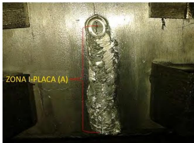
Figura 36.- Cordón de soldadura deficiente en la placa A, aluminio 1010.
