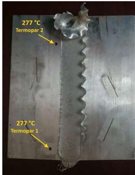
Figura 50. Temperatura registrada con termopares en la soldadura FSW.
