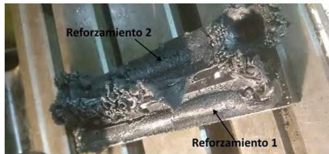
Figura 76. Reforzamiento de ABS por FSW.
