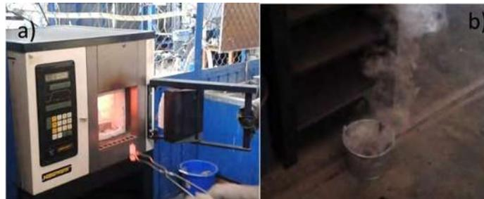
Figura 25. Tratamiento Térmico: a) Extracción de la herramienta del horno y b) Enfriamiento inmediato en aceite.
