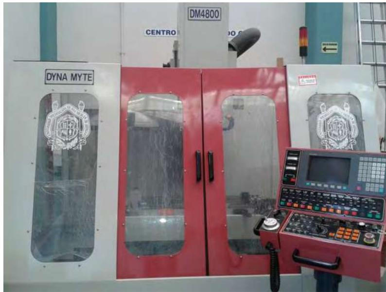
Figura 19. Centro de Maquinado Dyna Myte DM-4800.
