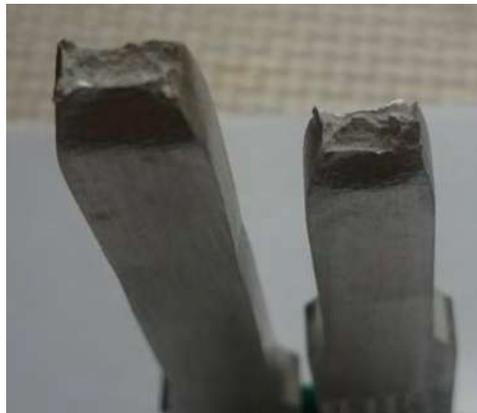
Figura 67. Superficie fractura para el caso de estudio B.
