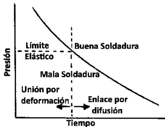
Figura 13. Gráfica de presión y tiempo involucrados en los procesos de deformación y unión por difusión [62].
