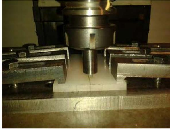
Figura 33. Sujeción y posicionamiento de la herramienta en polipropileno.
