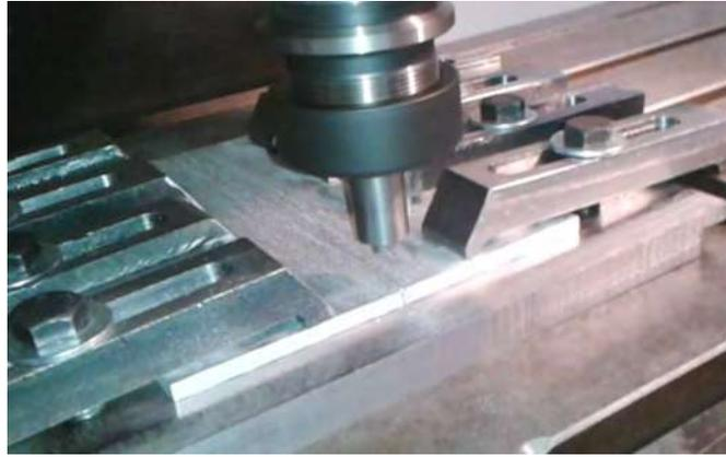
Figura 35. Sujeción y posicionamiento de la herramienta en la aleación de aluminio 1100.
