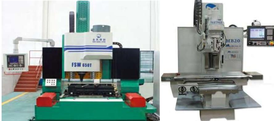
Figura 14. Equipos empleados para el proceso FSW, a) Equipo diseñado para FSW, b) Fresadora de control numérico [68].
