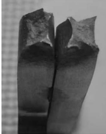
Figura 69. Superficie fractura para el caso de estudio B.
