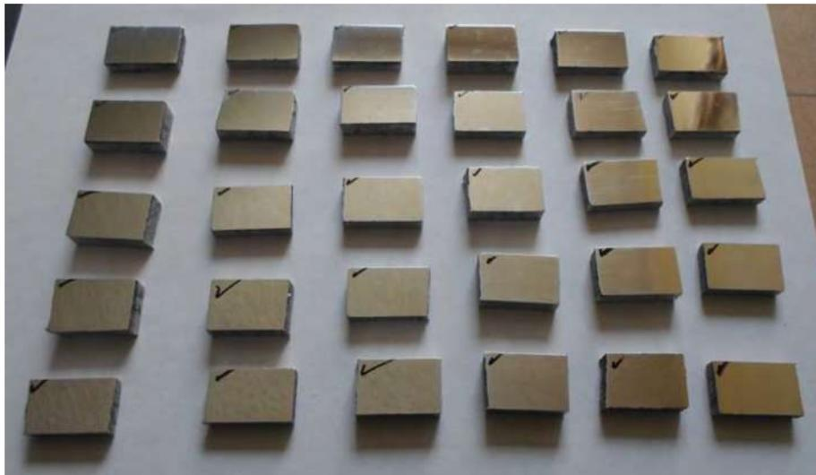
Figura 51. Probetas empleadas para obtener el perfil de microdureza.
