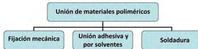
Figura 6. Clasificación de los procesos de soldadura en polímeros [45]
