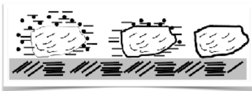
Figura 7 Ruptura de una Emulsión Asfáltica sobre un Material Pétreo. Fuente: Rogelio Rodríguez Talavera, 2001
