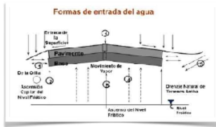
Figura 3 Ingreso y contacto del agua con el pavimento. (Fuente: SCT, 2014)
