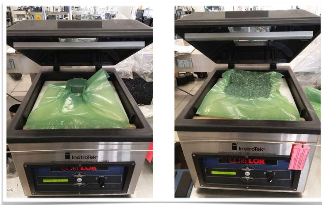
Figura 34. Equipo CoreLok, Muestra Gmb (izquierda) y Muestra Gmm (derecha)
