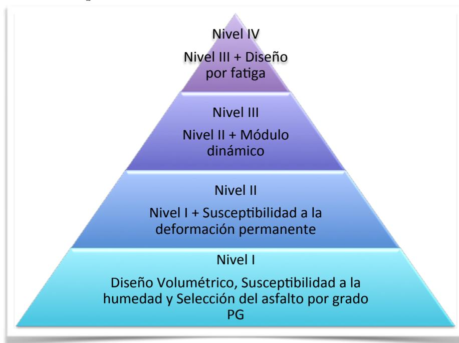
Figura 15. Criterio de Selección de ensayos para la evaluación del diseño de mezclas asfálticas. Fuente: Protocolo AMAAC-PA-MA-01-2013
