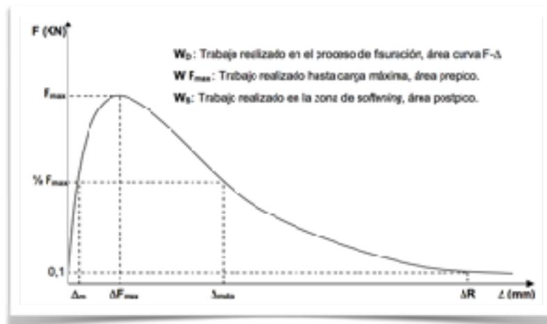
Figura 20. Curva Carga - Desplazamiento. (Fuente: Vidal, 2011)
