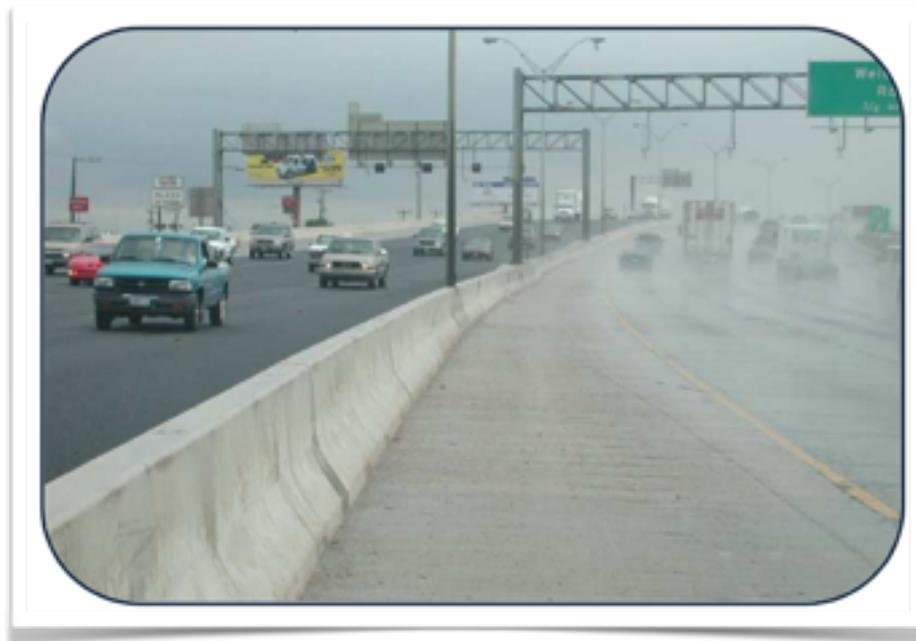
*Figura 10 La mezcla "drenante" reduce el agua proyectada y pulverizada por el paso de los vehículos. Fuente: Prsentación por Arkansas Asphalt Pavement Association, 2006*
