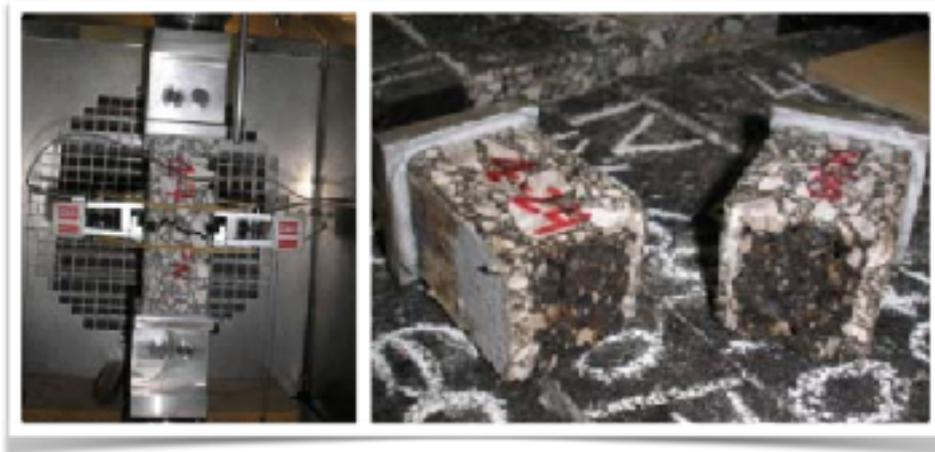
Figura 27. Montaje del ensayo CTD y superficie de fractura de probeta ensayada. Fuente: Laboratorio de Caminos, UPC
