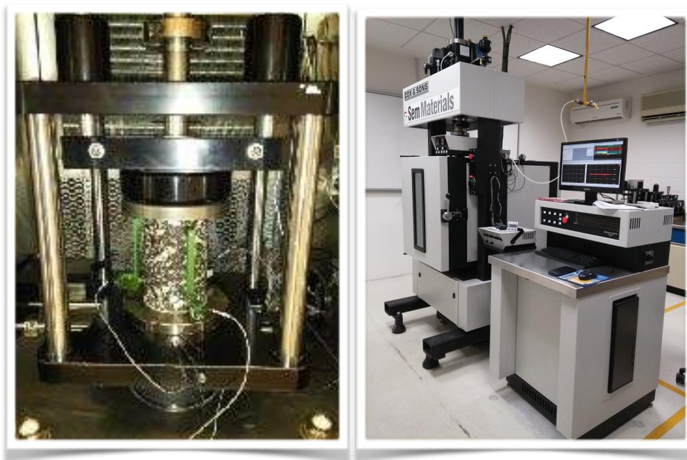
Figura 47 y 48. Especimen colocado en dispositivo para su evaluación, Máquina para evaluación de Módulo Dinámico.
