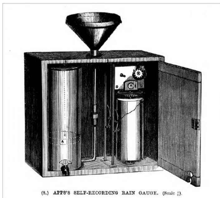
Figura 2.6. Pluviógrafo de A. Apps. Symons (1879).
