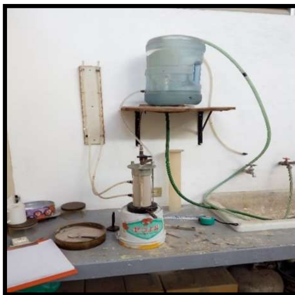
Figura 2.8. Prueba de Permeabilidad
