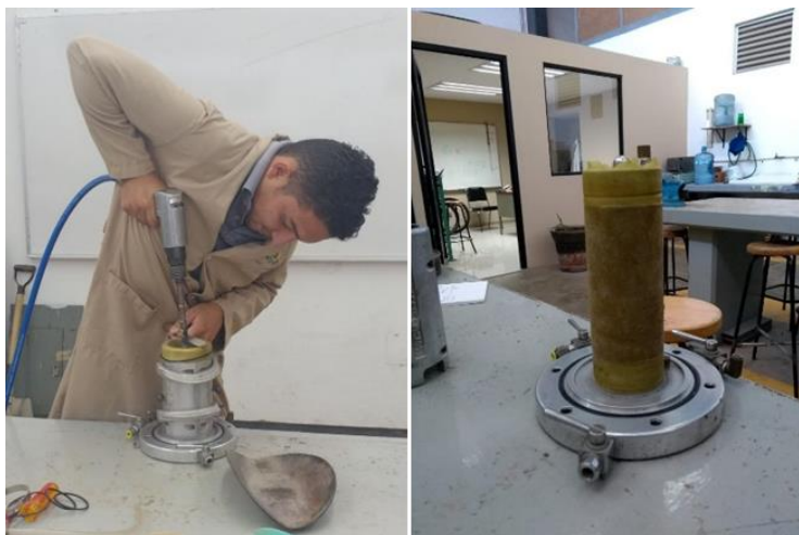
Figura 25. Compactación y reproducción del espécimen de prueba.
