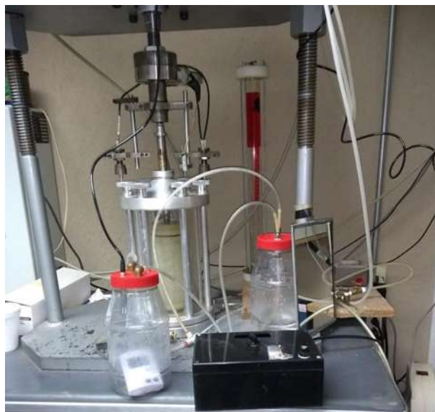
Figura 26. Elevación del contenido de agua de un espécimen por encima del óptimo.
