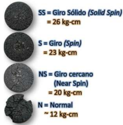
Figura 2.6: Modos de ruptura de microaglomerados en la prueba de cohesión. (Extraído de Laboratorio de Investigación y Desarrollo, Quimikao S.A. de C.V.,2017)
