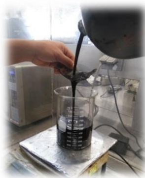
Figura 4.1: Filtración de la emulsión original a través de la malla N° 20.
