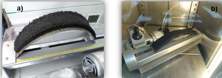
Figura 4.12: Ensayo de especímenes, a) temperatura ambiente y b) 4°C, para determinar la resistencia ante el agrietamiento de las mezcla de microaglomerado.
