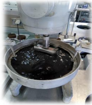
Figura 4.9: Ensayo para determinar la pérdida por abrasión en húmedo.
