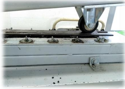
Figura 4.10: Ensayo de rueda cargada para determinar la cantidad de arena adherida.
