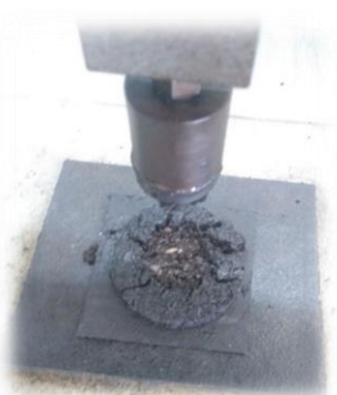
Figura 4.8: Ensayo de cohesión basado en el modo de ruptura.
