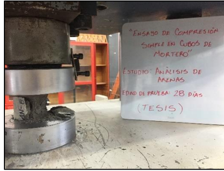
Figura 63. Falla del espécimen al registrar la carga máxima. Fuente: propia.
