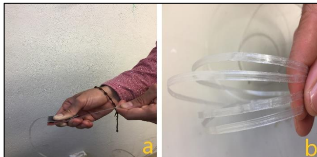
Figura 82. Rayado de la superficie del hilo de PET: a) método manual de rayado, b) textura final de la superficie del hilo de PET. Fuente: propia.
