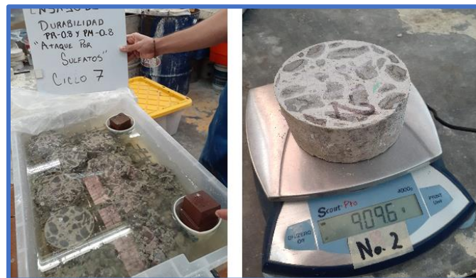
Figura 152. Concreto PR-0.8 en el ciclo 7 de prueba.
