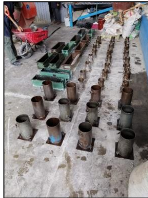
Figura 96. Acondicionamiento de 48 moldes para la elaboración de especímenes de prueba. Fuente: propia.
