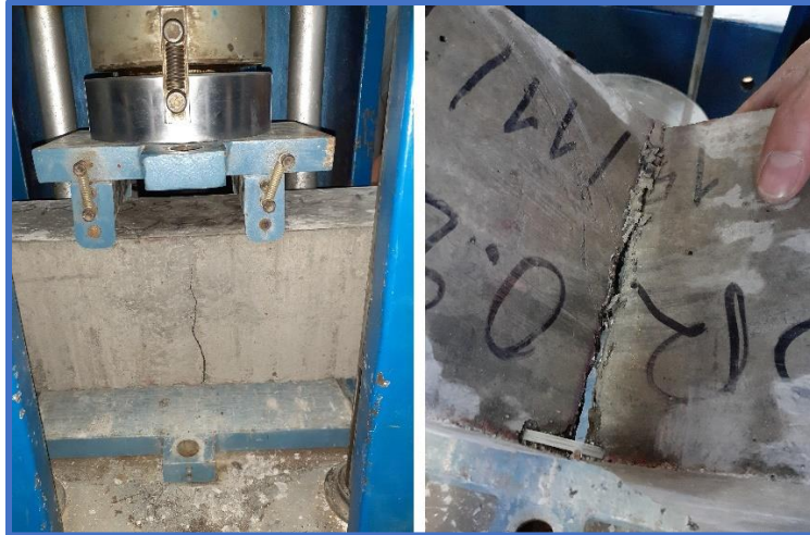
Figura 149. Falla no súbita en el concreto con fibra de PET.
