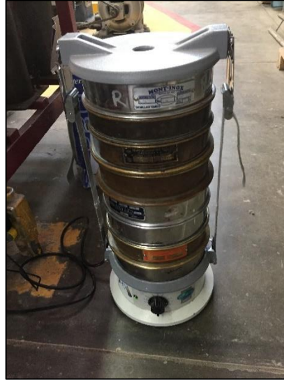
Figura 45. Cribado de la arena por medio de la maquina agitadora (Raf-tap) para la división de los tamaños. Fuente: propia.
