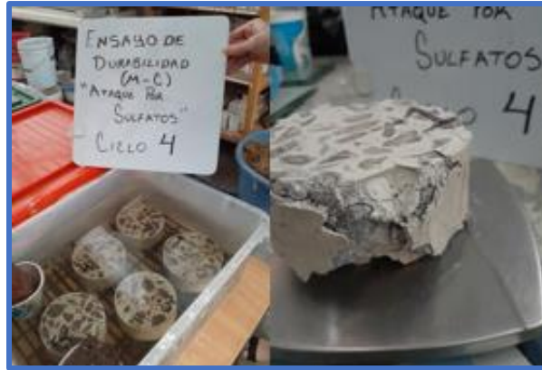
Figura 151. Pérdida de masa en los especímenes del concreto M-C al 4º ciclo de prueba.
