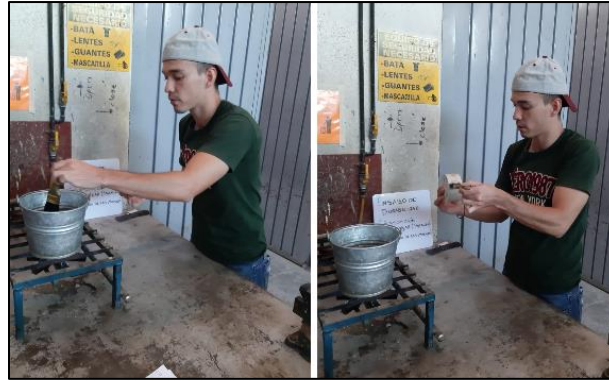
Figura 124. Sellado de la superficie lateral de los especímenes. Fuente: propia.
