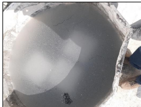
Figura 100. Tanque de curado con cal hidratada. Fuente: propia.
