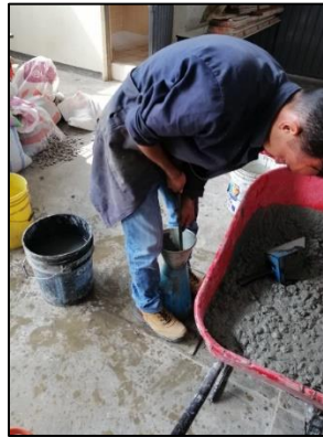
Figura 102. Colocación del operador sobre el molde troncocónico. Fuente: propia.
