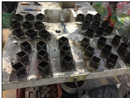
Figura 56. Moldes de acero inoxidable y bronce para la elaboración de cubos de mortero. Fuente: propia.
