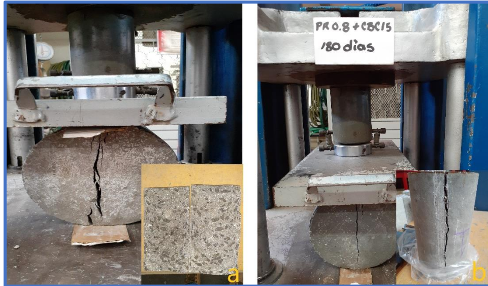
Figura 145. Fallas por tensión en cilindros de concreto: a) falla frágil en el concreto, b) falla dúctil en el concreto.
