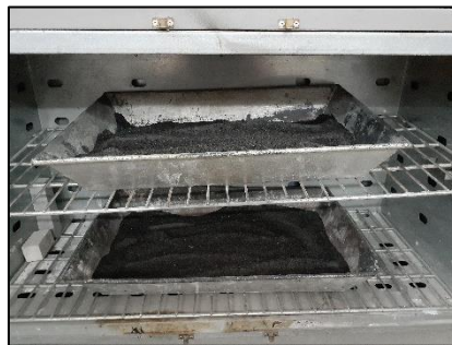
Figura 87. Secado de la CBC en el horno a temperatura de 50 \pm 5 °C. Fuente: propia.
