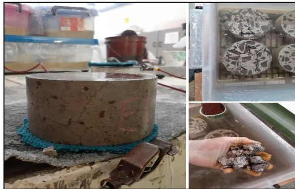
Figura 120. Proceso de desintegración de los discos de concreto. Fuente: propia.
