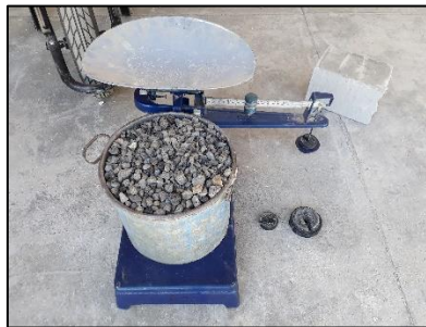
Figura 71. Determinación de la masa suelta de la grava dentro del recipiente. Fuente: propia.
