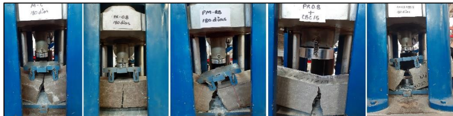
Figura 116. Aplicación de la carga sobre la viga hasta su falla. Fuente: propia.
