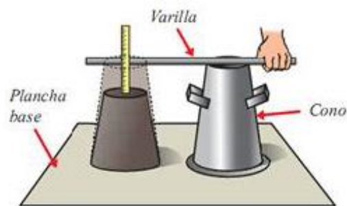
Figura 18. Medición del revenimiento en el concreto fresco. Fuente: Reyna, C., 2016.
