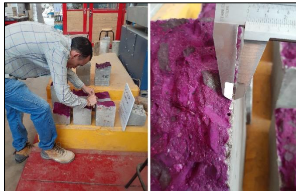
Figura 123. Medición de la profundidad de la zona incolora en la superficie del espécimen fracturado. Fuente: propia.
