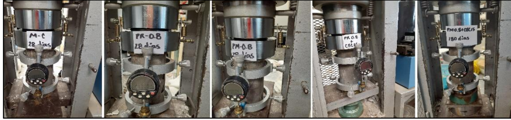
Figura 112. Aplicación de carga a compresión hasta el 60% de su carga máxima de falla. Fuente: propia.
