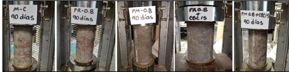
Figura 110. Aplicación de carga a cilindros elaborados de las diferentes mezclas en estudio. Fuente: propia.
