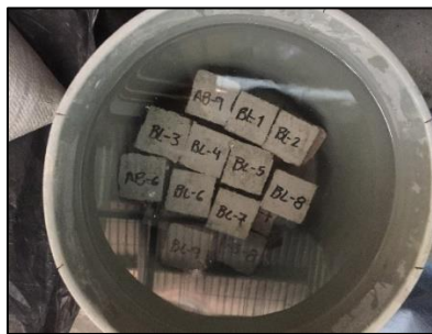
Figura 60. Curado de los cubos de mortero. Fuente: propia.
