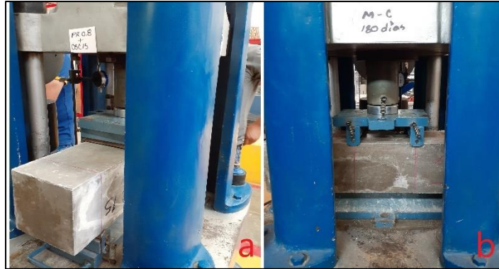
Figura 115. a) colocación de viga sobre los apoyos con ayuda de las marcas de referencia; b) colocación de los bloques de aplicación de carga sobre la superficie de la viga. Fuente: propia.
