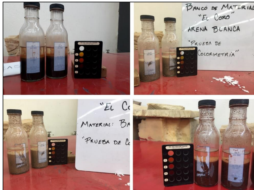
Figura 52. Comparación del color de las muestras con la tabla colorimétrica. Fuente: propia.
