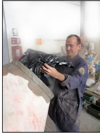
Figura 94. Vaciado de la CBC en la mezcladora estacionaria. Fuente: propia.
