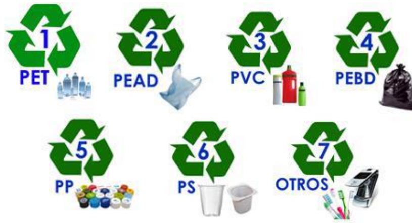
Figura 24. Clasificación de los plásticos según el SPI. Fuente: Expertos en reciclaje [En línea]. Como identificar los plásticos. Recuperado de https://cruplas.cl/como-identificar-los-plasticos/
