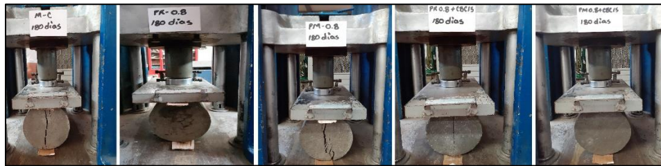
Figura 114. Aplicación de carga a compresión en la sección diametral del cilindro de concreto. Fuente: propia.
