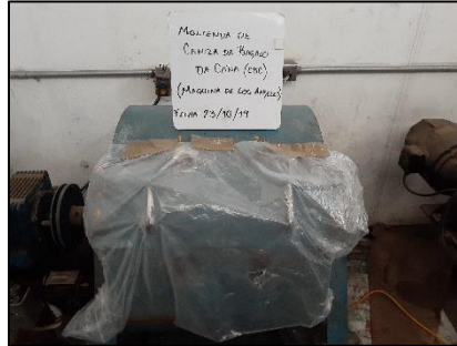
Figura 88. Molienda de la CBC en el tambor giratorio (máquina de Los Ángeles). Fuente: propia.
