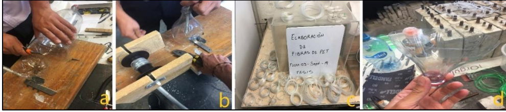
Figura 81. Proceso de producción del hilo de PET: a) corte del extremo inferior de la botella de PET, b) giro de la botella al accionar la máquina de corte, c) obtención de hilos de PET, d) extremo superior de la botella de PET. Fuente: propia.
