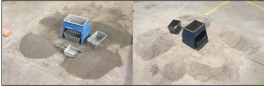
Figura 39. Cuarteo del agregado fino por el método “A”. Fuente: propia.
