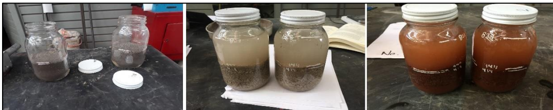
Figura 53. Llenado de frascos con agregado fino y agua.
