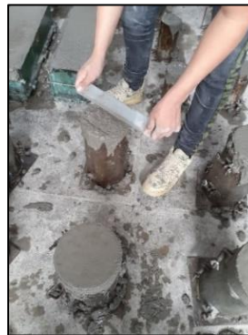
Figura 98. Enrase de la superficie del espécimen. Fuente: propia.
