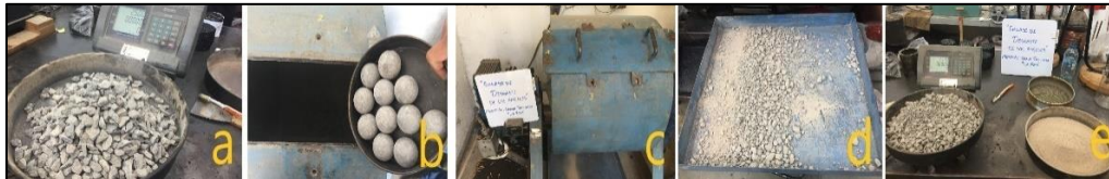
Figura 77. Metodología del ensayo de desgaste del agregado grueso. Fuente: propia.
