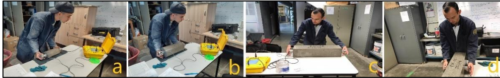
Figura 108. Transmisión directa de pulso ultrasónico en cilindros y vigas de concreto. Fuente: propia.
