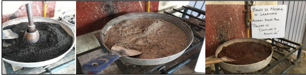
Figura 42. Secado superficial del agregado fino. Fuente: propia.
