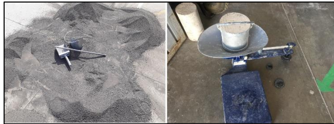
Figura 41. Enrase del agregado fino y determinación de la masa en el recipiente. Fuente: propia.
