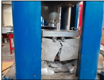
Figura 121. Obtención del espécimen de prueba a partir de la mitad de una viga fallada en su sección transversal. Fuente: propia.
