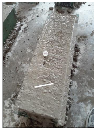
Figura 106. Lectura de la temperatura del concreto con ayuda de un termómetro de vástago. Fuente: propia.
