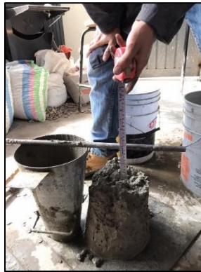
Figura 103. Lectura del valor de revenimiento de la mezcla. Fuente: propia.
