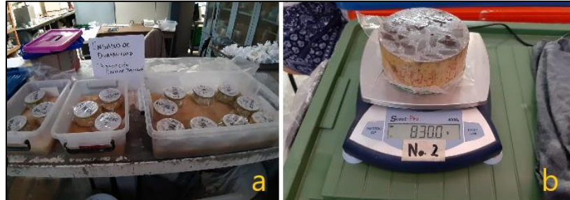
Figura 126. a) Colocación de los discos sobre la esponja, b) medida de la masa del disco invertido sobre la balanza. Fuente: propia.
