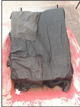
Figura 101. Condición de humedad de curado de los especímenes hasta antes de los ensayos del concreto. Fuente: propia.
