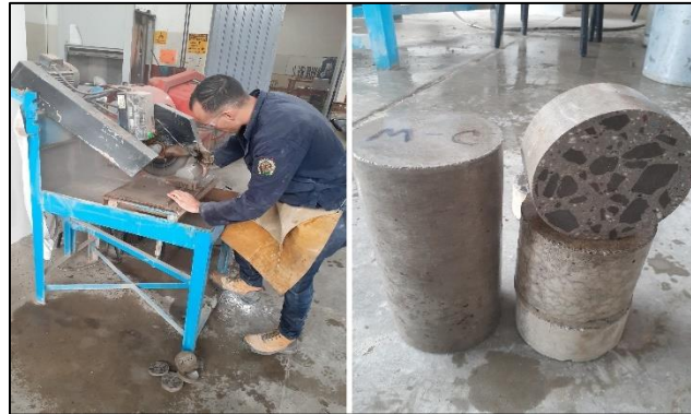
Figura 117. Obtención de discos de concreto a partir del corte de cilindros de 10 cm \varnothing x 20 cm h. Fuente: propia.
