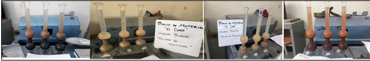
Figura 43. Llenado del frasco Chapman hasta nivel de aforo. Fuente: propia.
