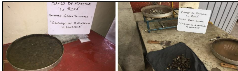
Figura 72. Grava sometida a saturación, secado superficial y secado total (paso 2 al 5). Fuente: propia.
