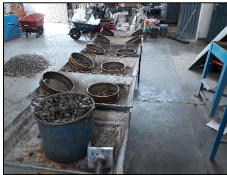
Figura 74. Cribado del agregado grueso por medio del método manual. Fuente: propia.
