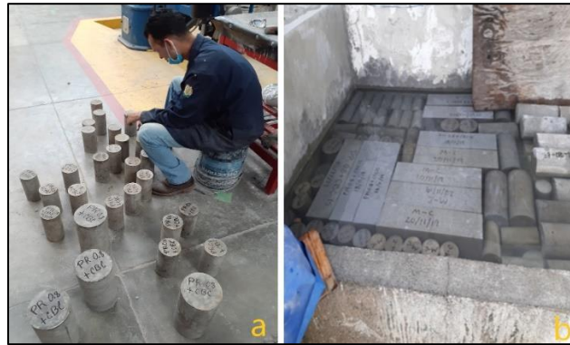
Figura 99. a) Etiquetado de los especímenes para su identificación, b) Curado de los especímenes. Fuente: propia.
