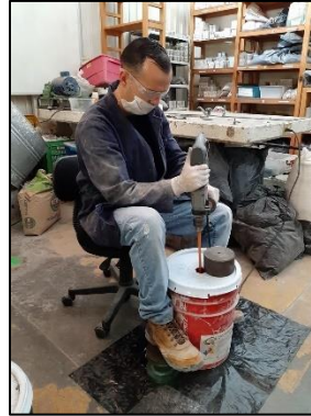
Figura 118. Elaboración de la solución de sulfato de sodio. Fuente: propia.
