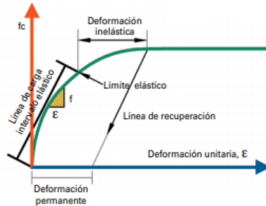
Figura 7. Gráfica esfuerzo-deformación del concreto. Fuente: imcyc.
