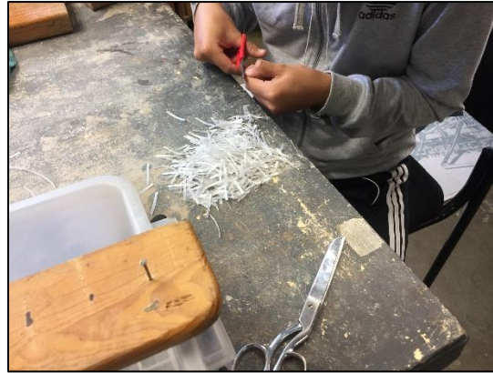
Figura 83. Corte del hilo de PET para la obtención de las fibras de PET.
