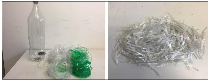
Figura 78. Obtención de las fibras de PET Reciclado; a la izquierda hilos provenientes de botellas de PET post-consumo, a la derecha fibras de PET Reciclado (PR). Fuente: propia.
