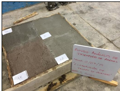
Figura 67. Fraguado de pastas de mortero para el análisis de desempeño de las arenas. Fuente: propia.
