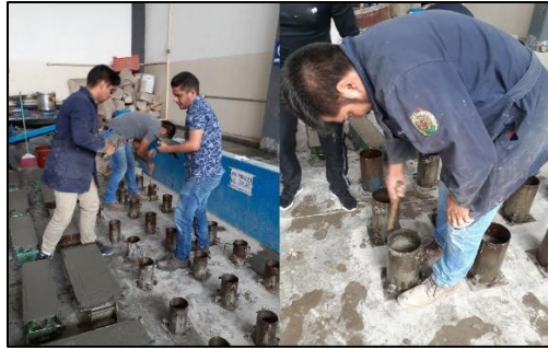
Figura 97. Llenado y compactado de la mezcla de concreto. Fuente: propia.
