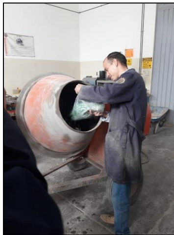
Figura 85. Vaciado de las fibras de PET a la mezcladora estacionaria. Fuente: propia.
