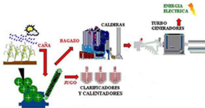
Figura 30. Obtención del bagazo de caña en el proceso de obtención de azúcar. Fuente: propia.
