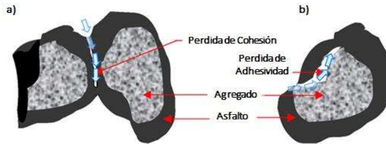
Fig. 2-17 Deterioro del material asfáltico (Tarefder & Zaman, 2009)
