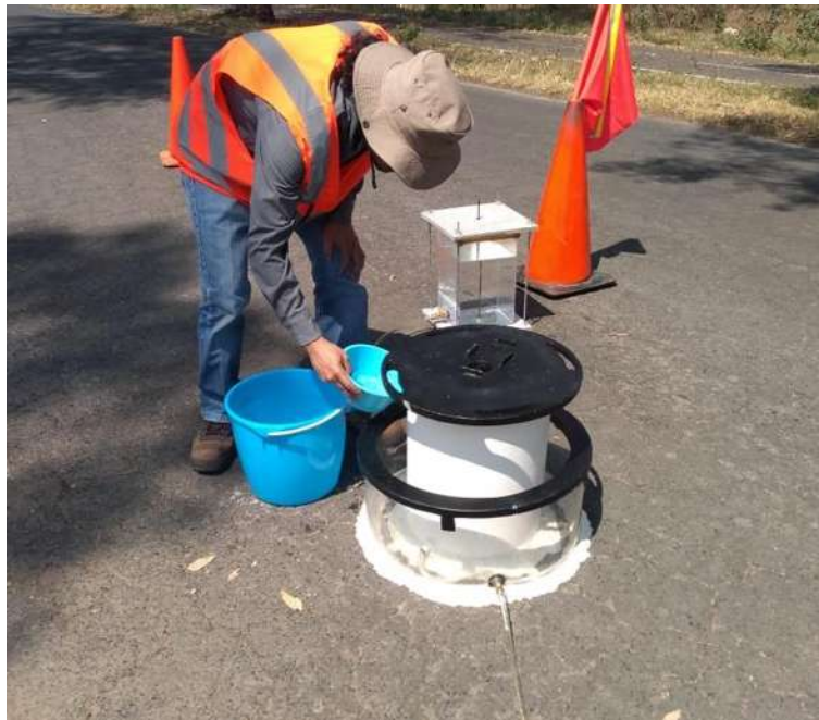
Fig. 3-28 Verificación del sellado del equipo
