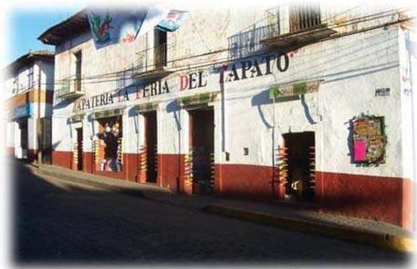
Imagen 14. Subdivisión de predios en planta baja con fines comerciales y abandono de la planta alta con su correspondiente deterioro.
