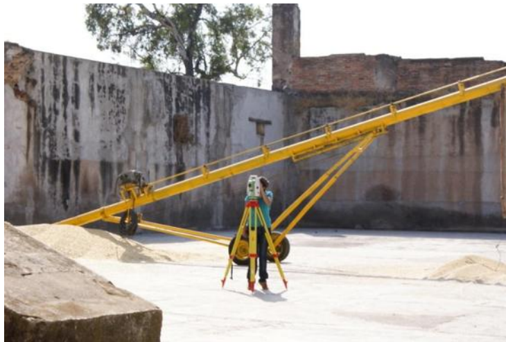
Imagen 21. Para la ubicación de los puntos donde se colocaría la estación se utilizaron estacas, pero no es todos los espacios se pudieron colocar por lo que se requirió marcarlos con clavos colocados en grietas o juntas, o en su defecto mediante marcadores, en ambos casos procurando no dañar los pisos. Foto: Hugo A. Pedraza.
