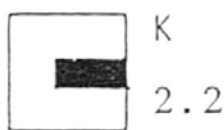
Fig. 38 Ejemplo de la clave símbolo-alfanumérica, en este caso el símbolo (el efecto) representa “juntas erosionadas”, la letra (la causa) se refiere a “el uso”, y el número (el lugar) indica el área afectada, ósea la partida y el elemento que aquí es “albañilería y muro”. Fuente: Eugenia María Azevedo Salomao, et.al., op.cit. , p. 262.
