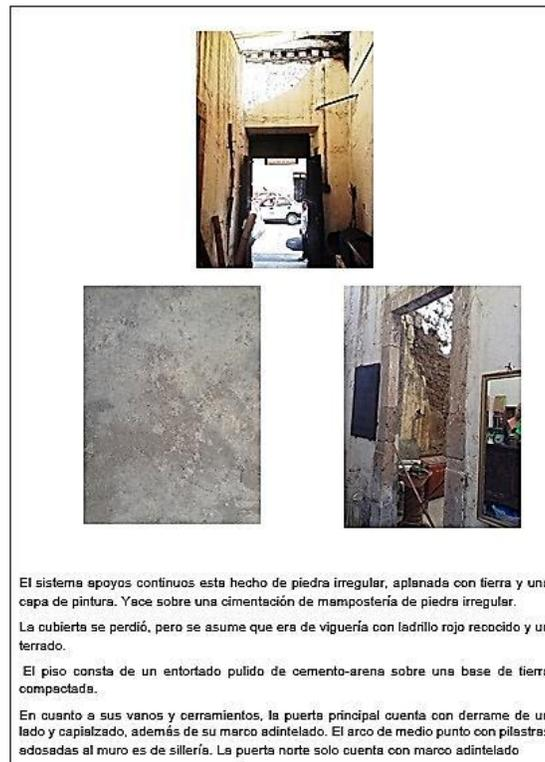
Figura 18 Detalle de ficha de procedimientos constructivos. Elaboración propia.
