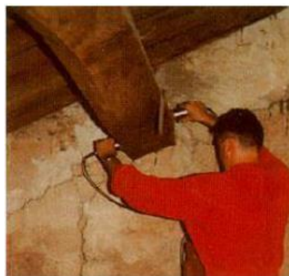
Imágenes 63, 64. Aplicación de equipo ultrasónico para ensayos no agresivos. Fuente: imagen 63. http://blog.utp.edu.co/metalografia/2010/11/05/ensayos-no-destructivos/ Imagen 64, información didáctica del curso "Comportamiento estructural y criterios de solución", Dr. Guillermo Martínez.
