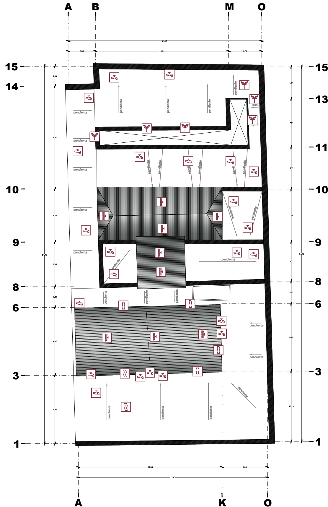
planta arquitectónica de azotea levantamiento deterioros
