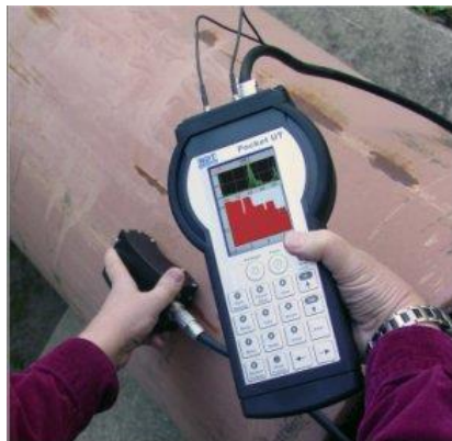
Imágenes 63, 64. Aplicación de equipo ultrasónico para ensayos no agresivos. Fuente: imagen 63. http://blog.utp.edu.co/metalografia/2010/11/05/ensayos-no-destructivos/ Imagen 64, información didáctica del curso "Comportamiento estructural y criterios de solución", Dr. Guillermo Martínez.
