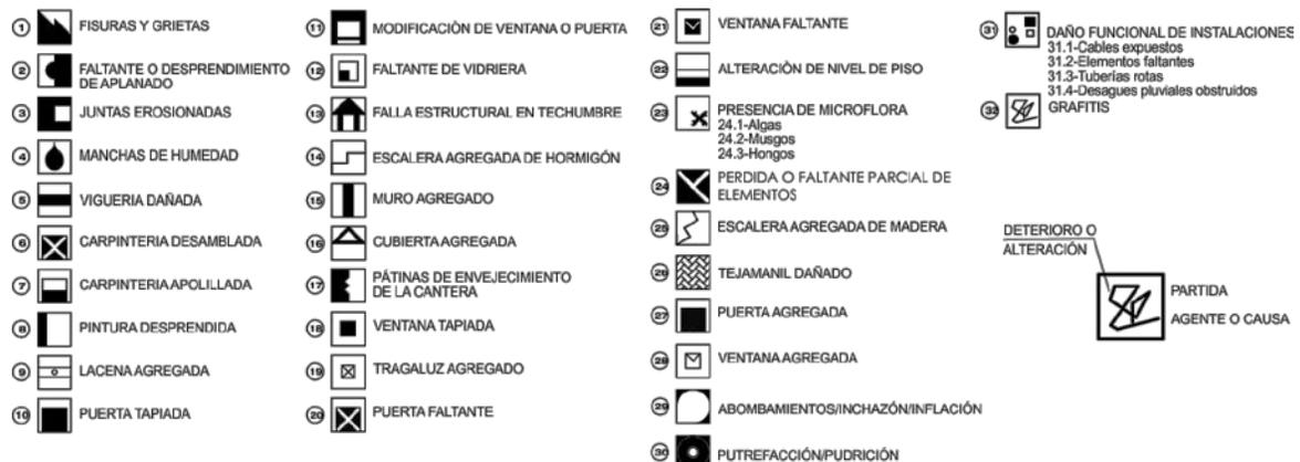
Fig.51. Simbología utilizada en los planos de Alteraciones y Deterioros. Fuente: Elaborado por GALS.
