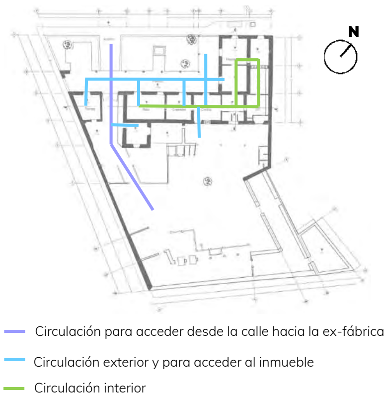
Figura 31: Circulaciones interiores. Fuente: Propia
