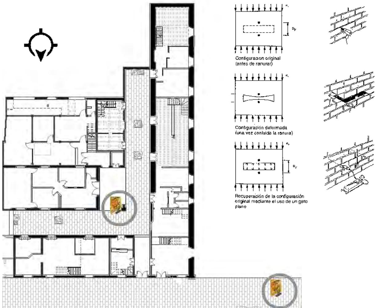
**Fig 112.** Esquema de prueba gato plano
