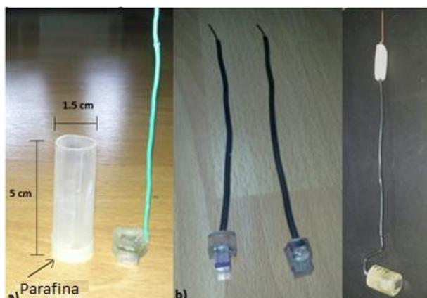
**Figura 2.4** a) Recipiente de plástico con parafina, b) Electroodos de aceros inoxidables 316, 304 y 316L.
