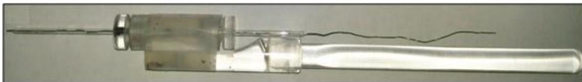
**Figura 2.2** Microelectrodo de platino, sujeto al cilindro de acrílico.
