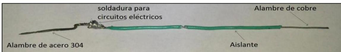
**Figura 2.3** Microelectrodo de acero 304.
