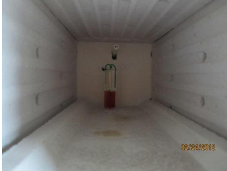
Figura 6.6. Las fibras se llenan por capilaridad dentro del horno a temperatura controlada.
