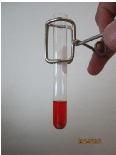
Figura 6.4. Sol: Mezcla de TEOS (1ml), alcohol etílico (1ml), agua destilada (0.1ml), bromofenol azul (0.0015 gr), rojo fenol (0.0008 gr) y rojo cresol (0.0008 gr)
