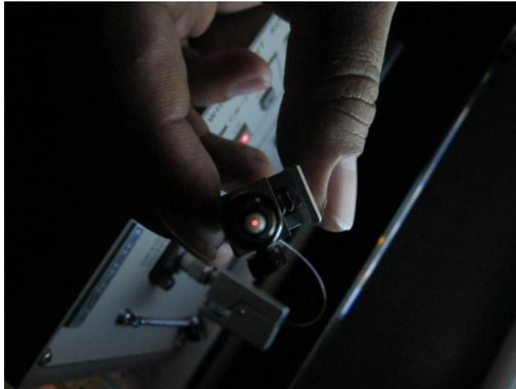
Figura 5.14. En la imagen se observa la luz que sale de la fibra. En el otro extremo se introduce luz blanca y la luz que se aprecia es roja, lo que nos indica que las demás longitudes de onda se atenúan rápidamente y solo logran salir las longitudes de onda correspondientes al rojo. Se dice que las demás ondas son "prohibidas".
