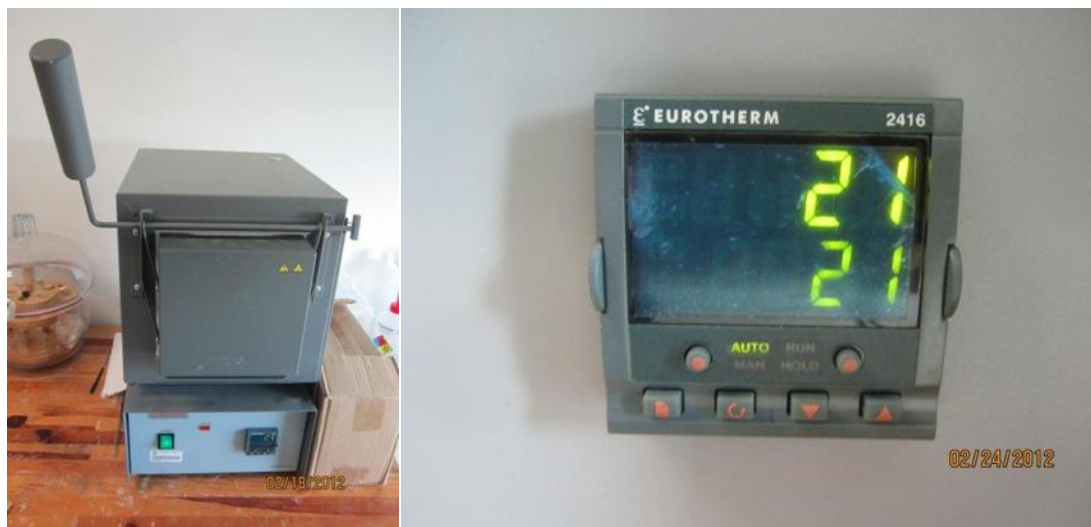
Figura 6.7. Las fibras se introducen al horno a temperatura controlada de 21°C
