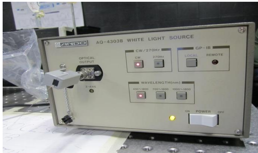
Figura 5.8. Fotografía de la fuente de luz blanca utilizada para propagar luz visible a lo largo de la fibra y analizar cuales longitudes de onda logran salir por el extremo opuesto de la fibra, para diferentes longitudes de la fibra.
