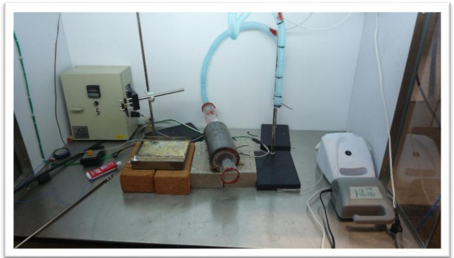
Figura 11.- sistema de RPU para la creación de películas delgadas y nanopartículas
