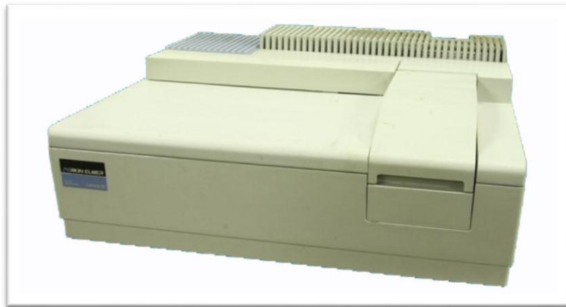
Figura 10.- Equipo de UV-vis del laboratorio de Holografía, utilizado para la caracterización de las muestras.
