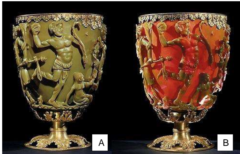
Figura 1.3. Vaso de Lycurgus. Compuesto de vidrio con nanopartículas metálicas. Vista con a) luz reflejada, y b) luz transmitida [Rao., et al., 2007].
