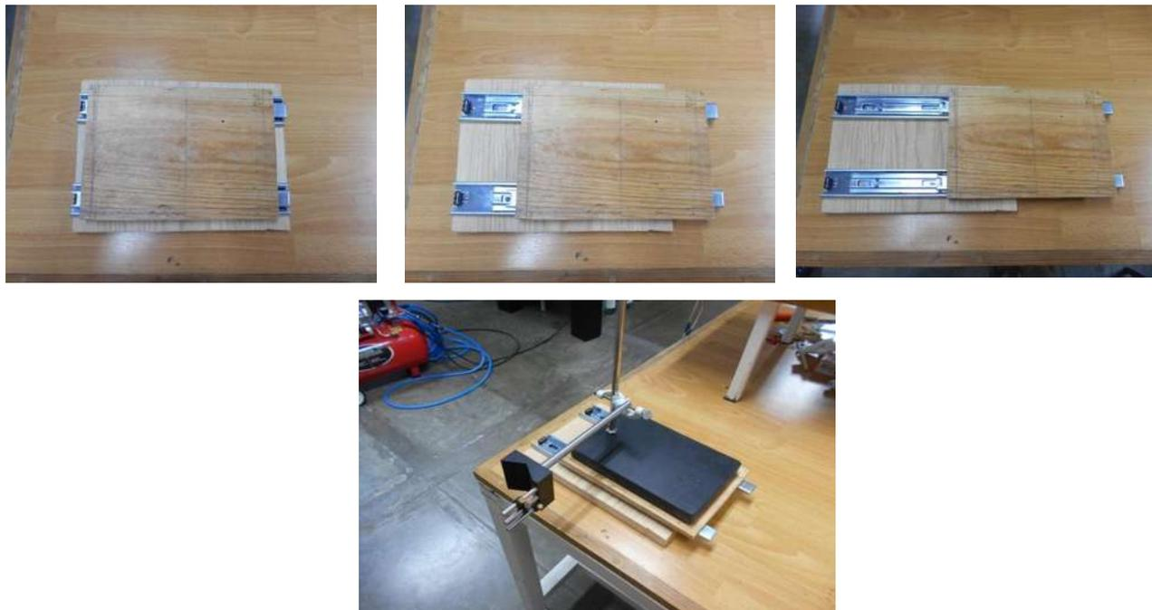
Figura 3.4. Base de madera con rieles metálicos para deslizar el soporte universal, sobre el cual se coloca la boquilla
