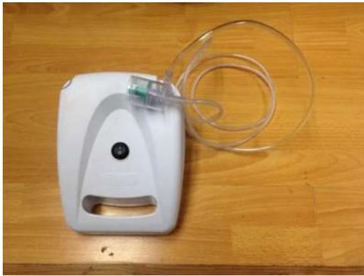
Figura 3.1. Nebulizador ultrasónico a base de pistón
