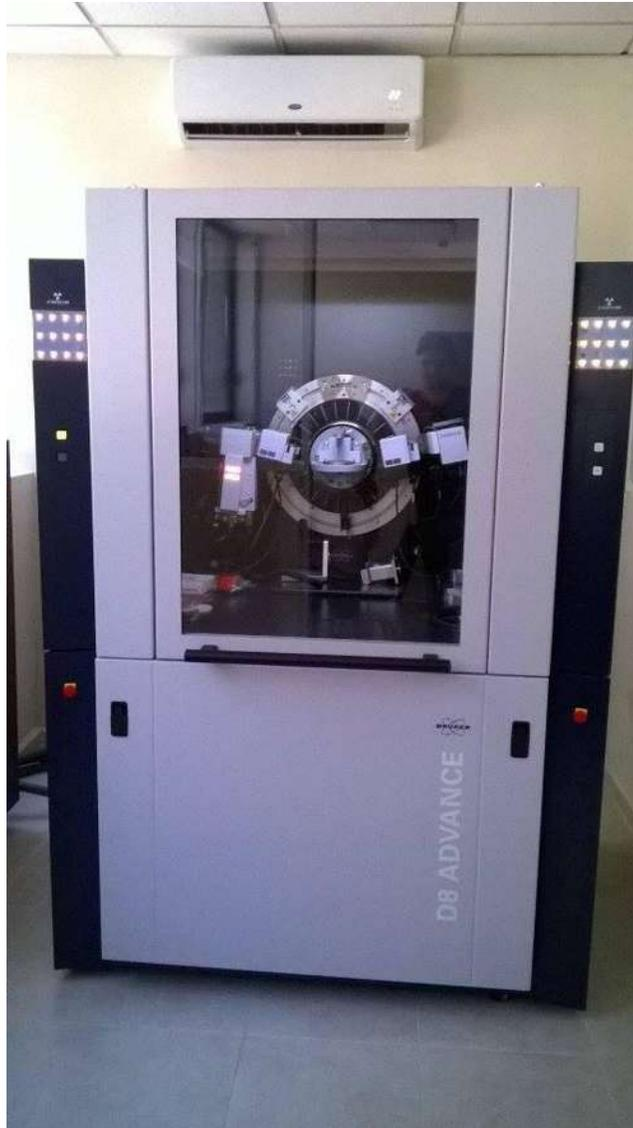
Figura 3.8 Difractómetro de rayos X
