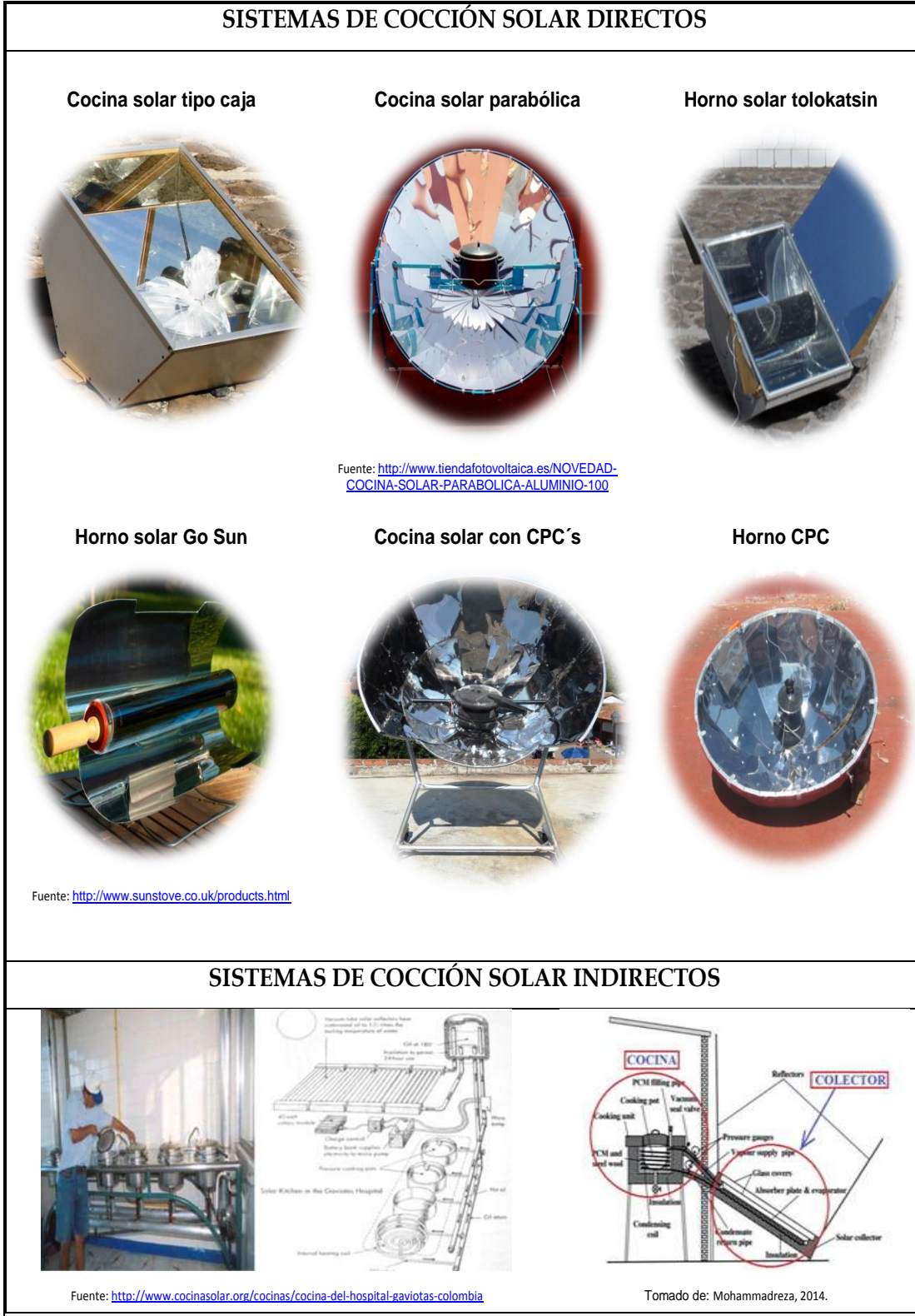
Fig. 1.9. Clasificación de los sistemas de cocción solar de acuerdo a su forma de operación.
